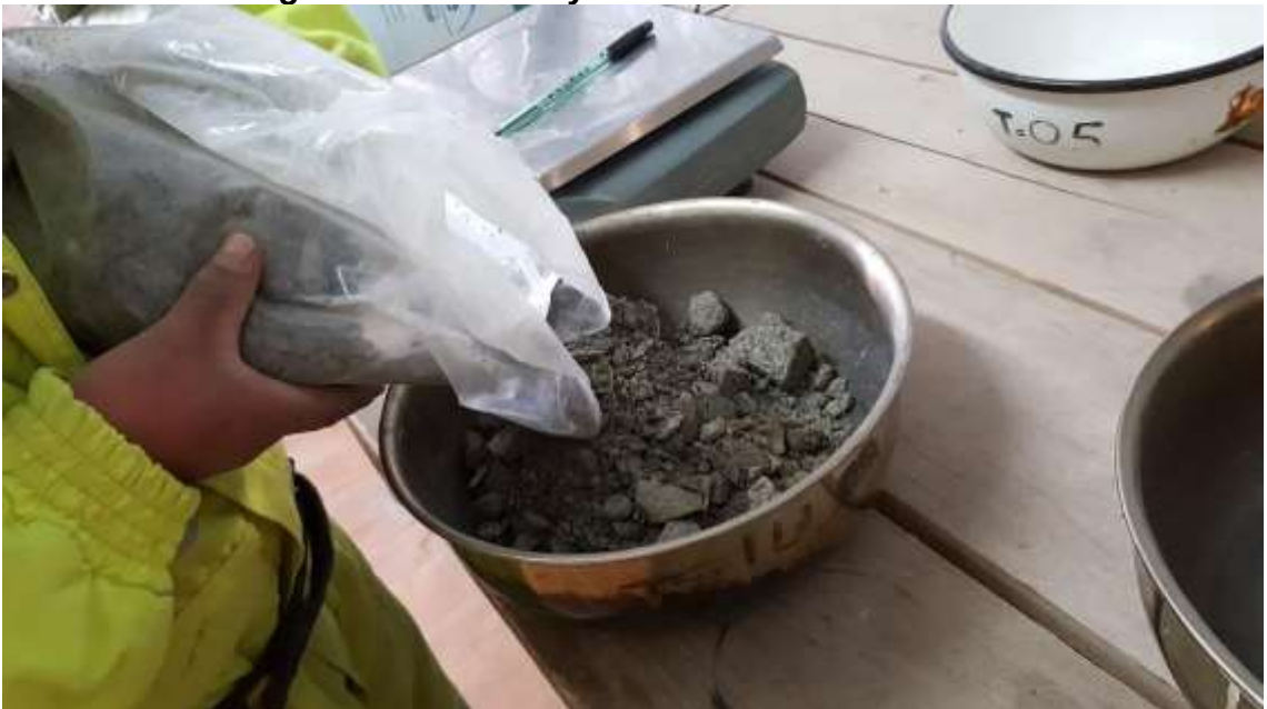
Fotografía N° 04 Ensayo de Contenido de humedad
