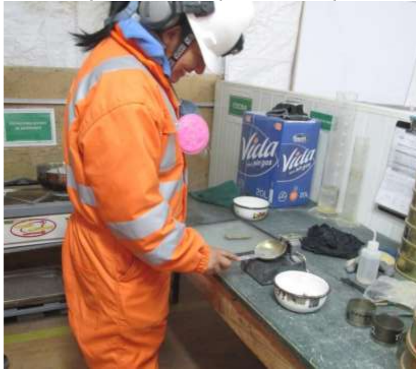
Fotografía N° 05 Ensayo de Límite líquido
