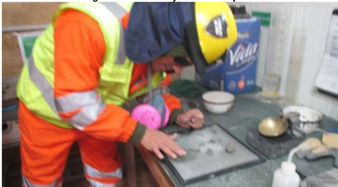
Fotografía N° 06 Ensayo de Límite plástico
