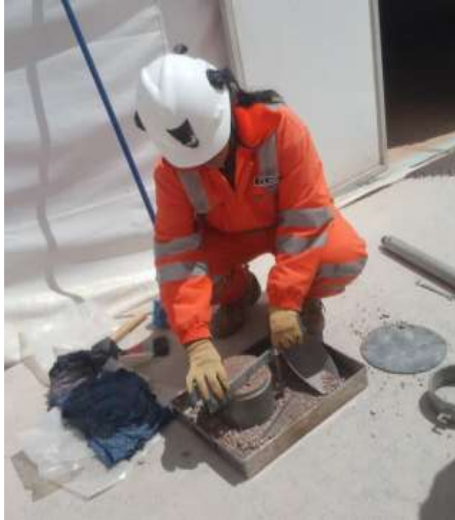
Fotografía N° 07 Ensayo de Proctor modificado
