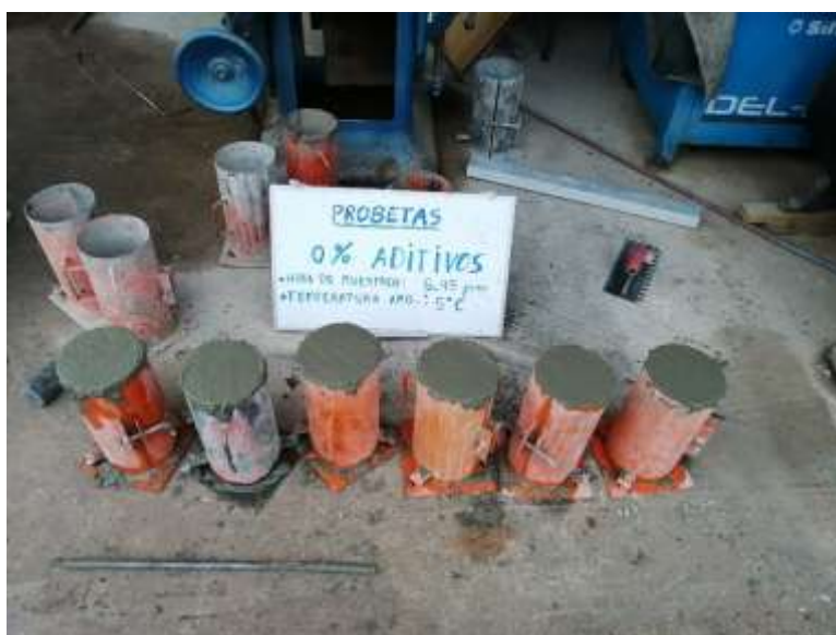
Ilustración N° 5: probetas de concreto convencional
