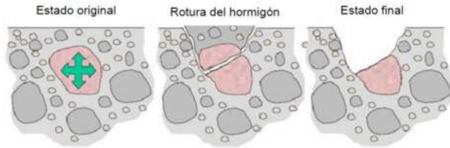
Figura N° 5: Rotura del concreto debido al congelamiento del agregado
