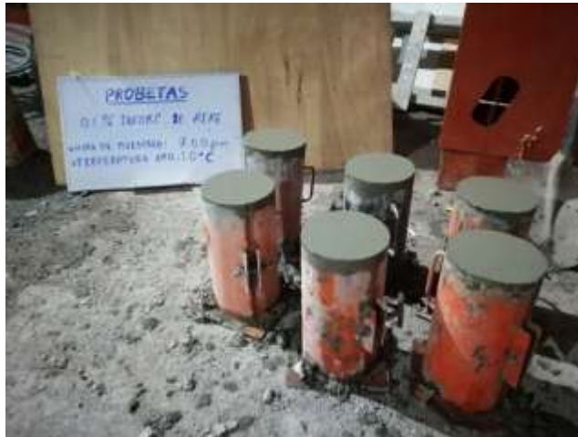
Ilustración N° 7: probetas de concreto con 0.1% de aire incorporado
