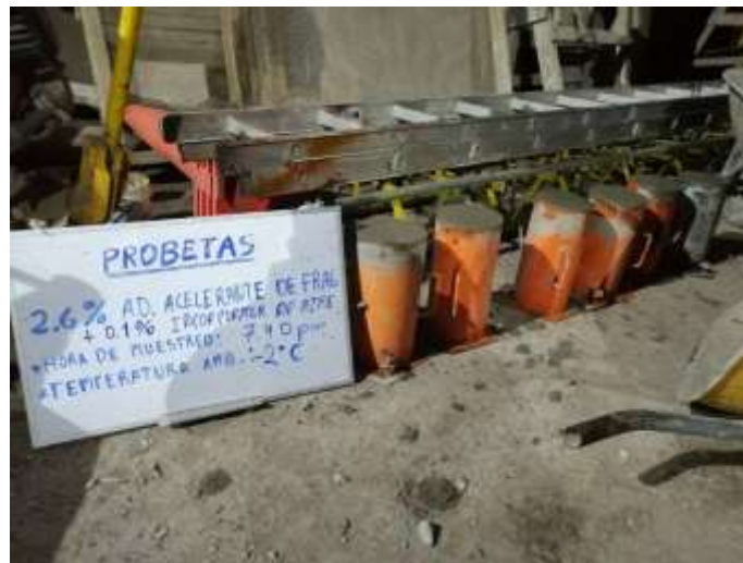
Ilustración N° 8: probetas de concreto con 2.6% de acelerante de fragua + 0.1% de aire incorporado
