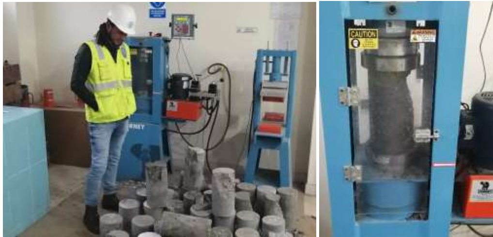
Ilustración N° 4: rotura de las probetas - ensayo a compresión
