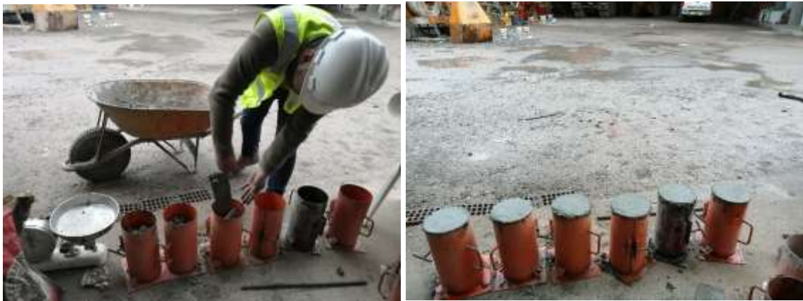
Ilustración N° 3: elaboración de las probetas
