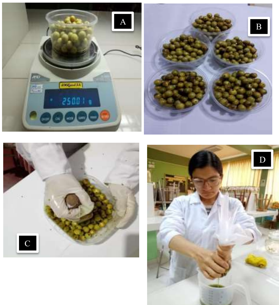
Figura 3: A) Peso del fruto. B) Frutos pesados para los 5 tratamientos. C) Trituración del fruto. D) filtrando el extracto para eliminar los restos de cascara del fruto
