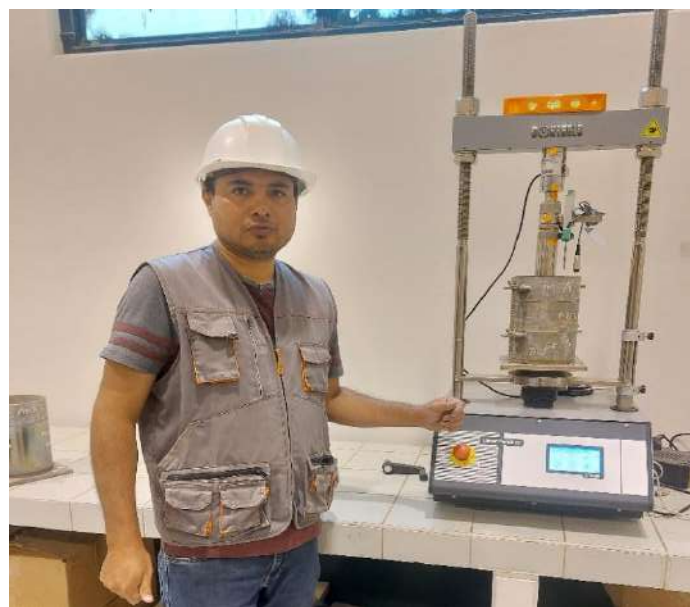
Fotografía 45: Penetración del suelo con el equipo CBR
