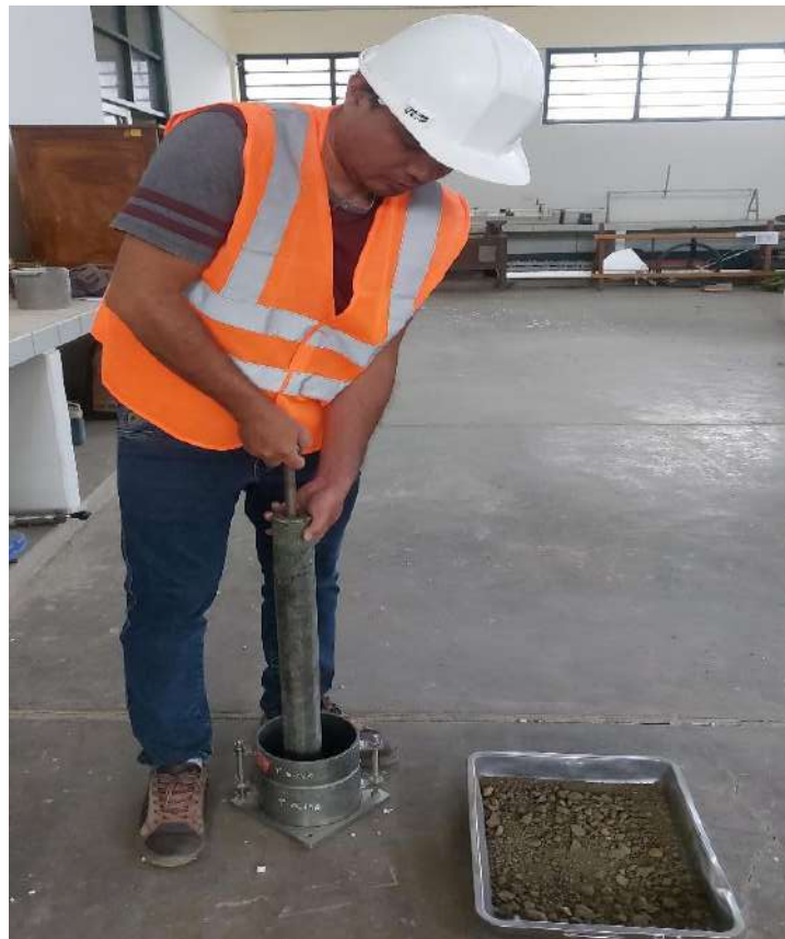
Fotografía 41: Compactado de la muestra con martillo Proctor
