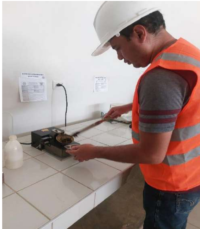
Fotografía 36: Colocación de la muestra a la copa de Casagrande
