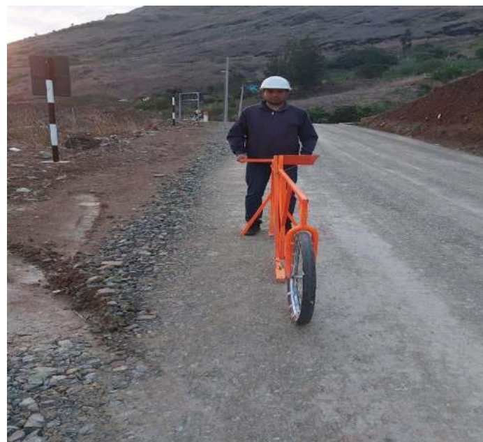
Fotografía 58: Medición de la rugosidad con el equipo merlín Prog, 0+ 030.00 – 0+040.00 (Tramo con afirmado + CBCA)
