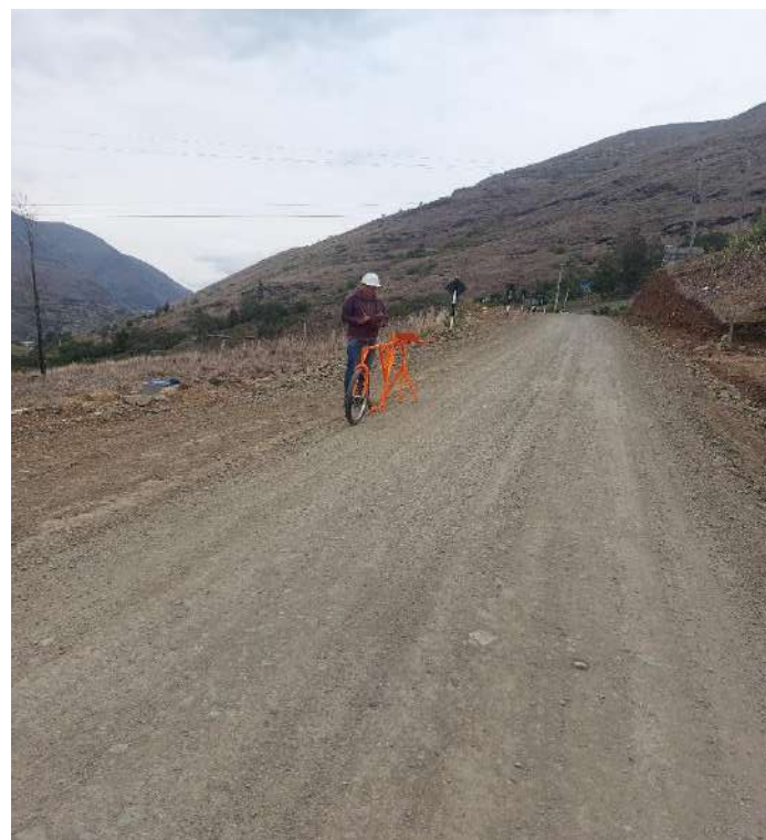
Fotografía 62: Medición de la rugosidad con el equipo merlín Prog, 0+ 090.00 – 0+102.40 (Tramo con afirmado + CBCA + cal)
