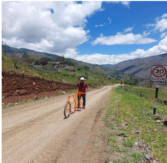
Fotografía 59: Medición de la rugosidad con el equipo merlín Prog, 0+ 045.80 – 0+060.00 (Tramo con solo afirmado)
