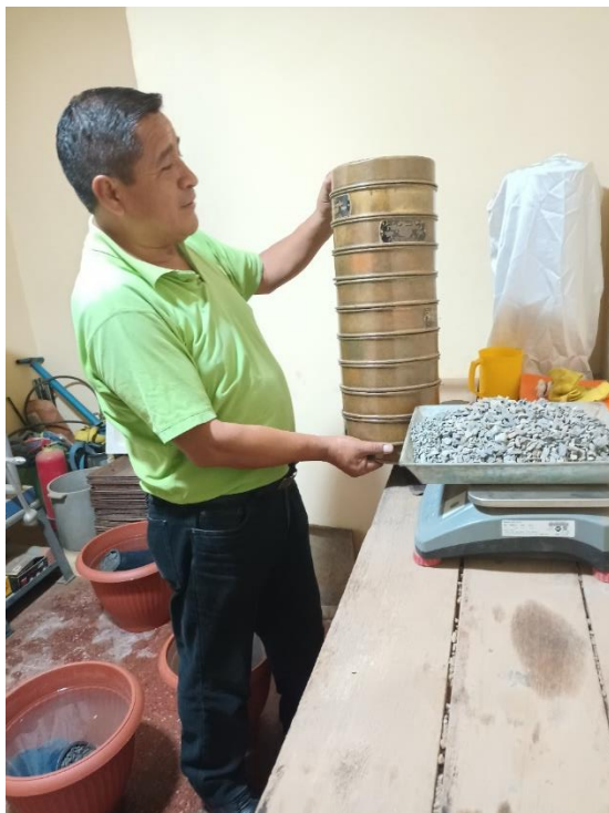
Figura N° 08: Granulometría del agregado con mallas estándar.
