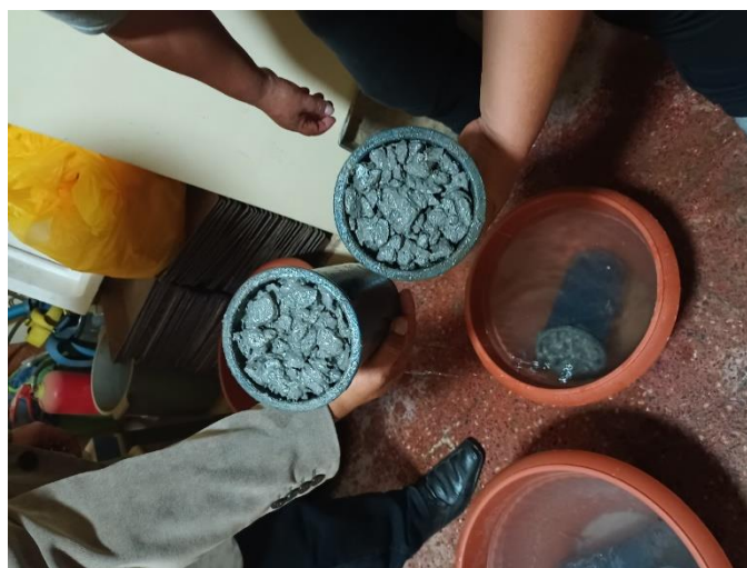
Figura N° 10: Textura de pavimento poroso, ensayo de permeabilidad.
