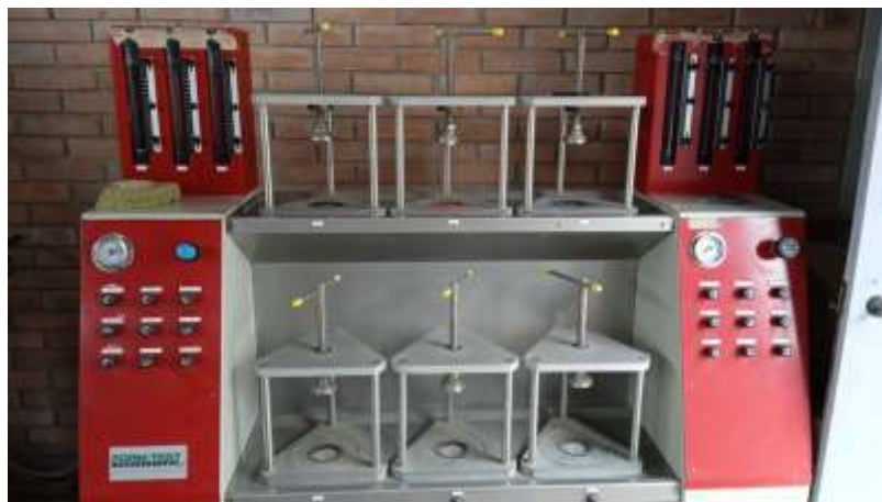
Figura 99 Equipo de aplicación de presión de agua.
