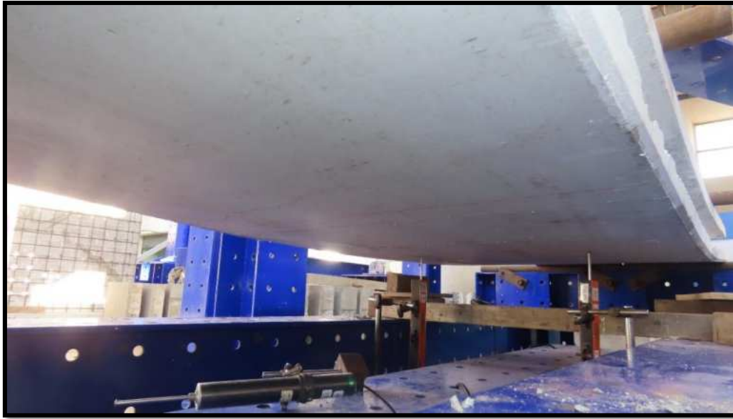
Figura N°56. Espécimen: SPBD02 – Ensayo finalizado, agrietamiento en la zona inferior de la losa aligerada.
