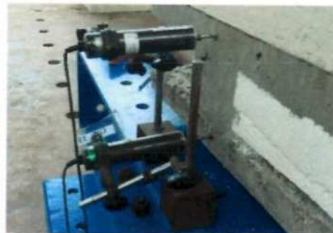
Foto 4. Transductores laterales cara Norte (CH-05 y CH-06).
