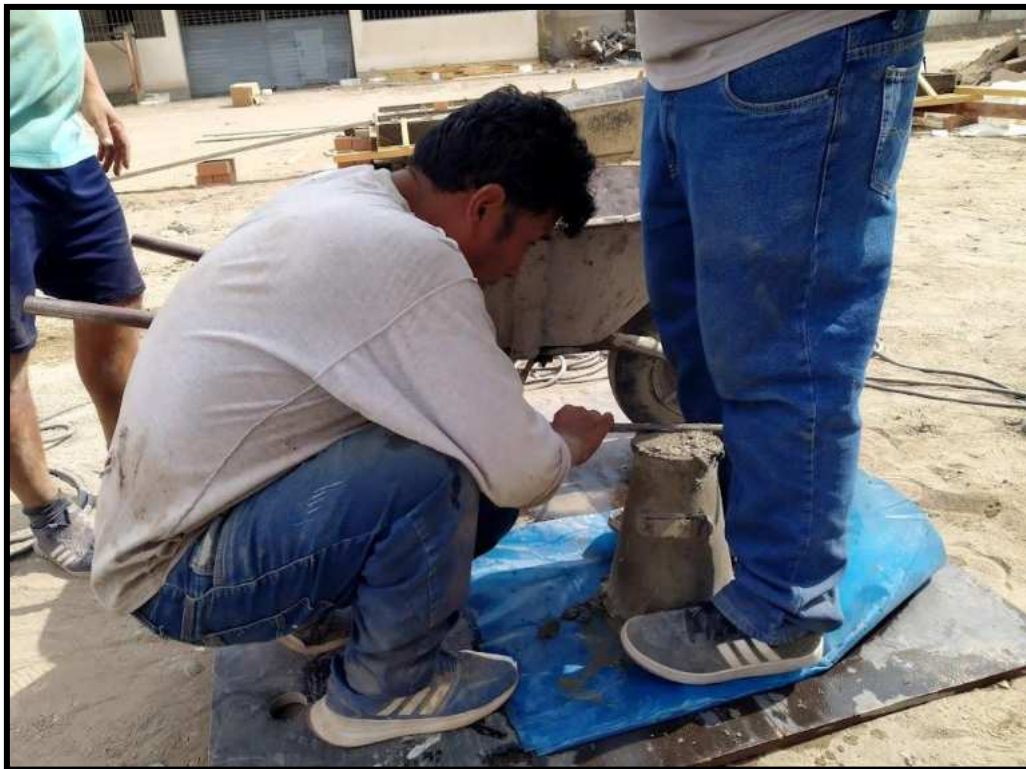
Figura N°19. Culminación del procedimiento del ensayo de consistencia del concreto.
