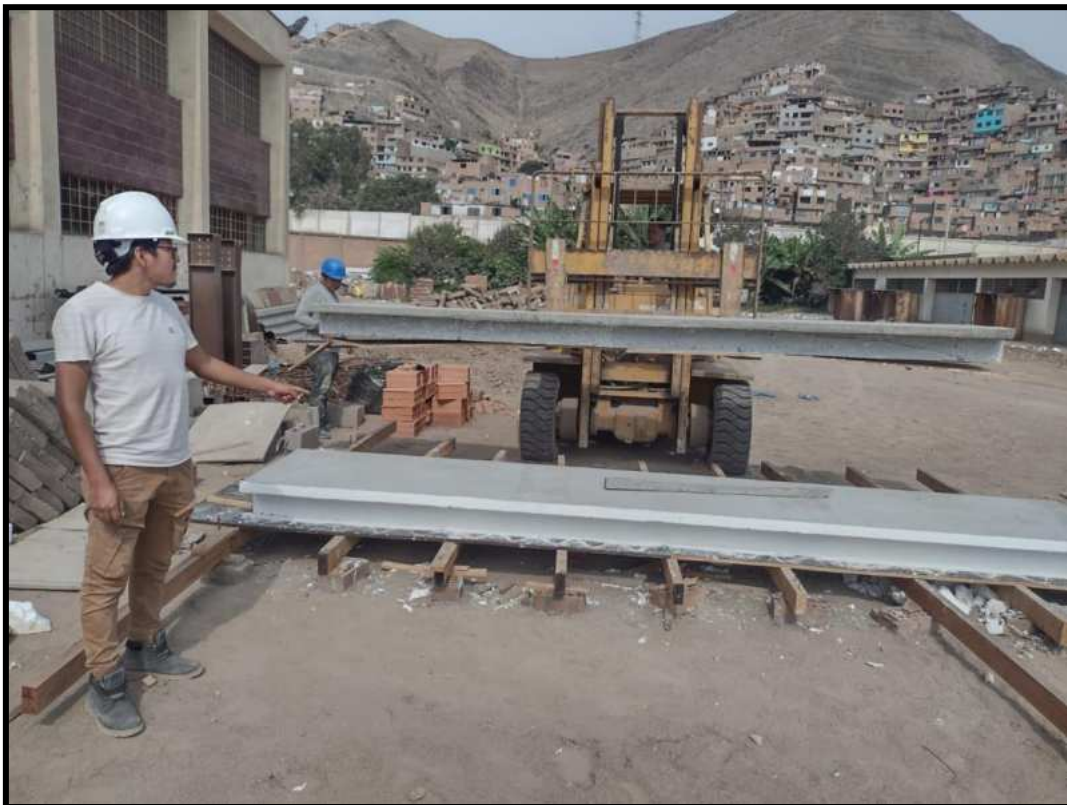
Figura N°33. Traslado hacia el interior del laboratorio de los prototipos de SCLA con montacarga.
