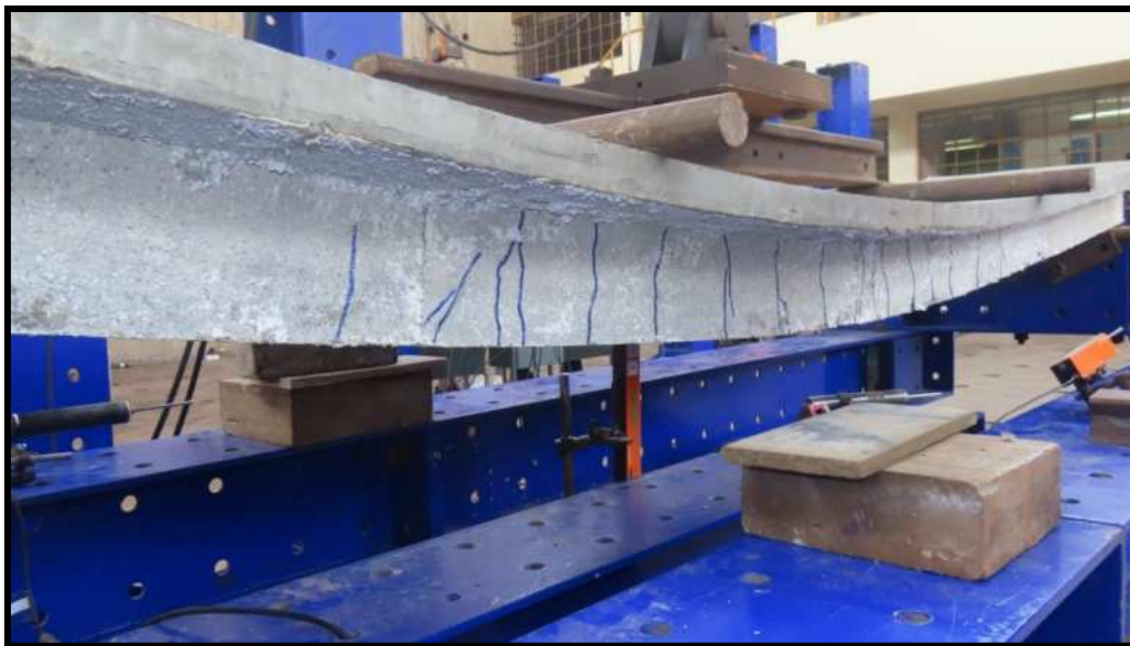
Figura N°47. Espécimen: SCLA02 – Vista lateral derecha del prototipo SCLA02, al finalizar el ensayo de flexión de la losa.
