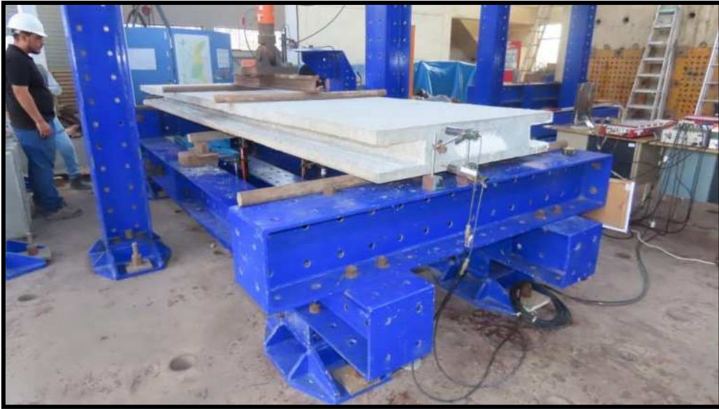
Figura N°54. Espécimen: SPBD02 – Inicio del ensayo a flexión estática de losas con los sensores ya colocados.
