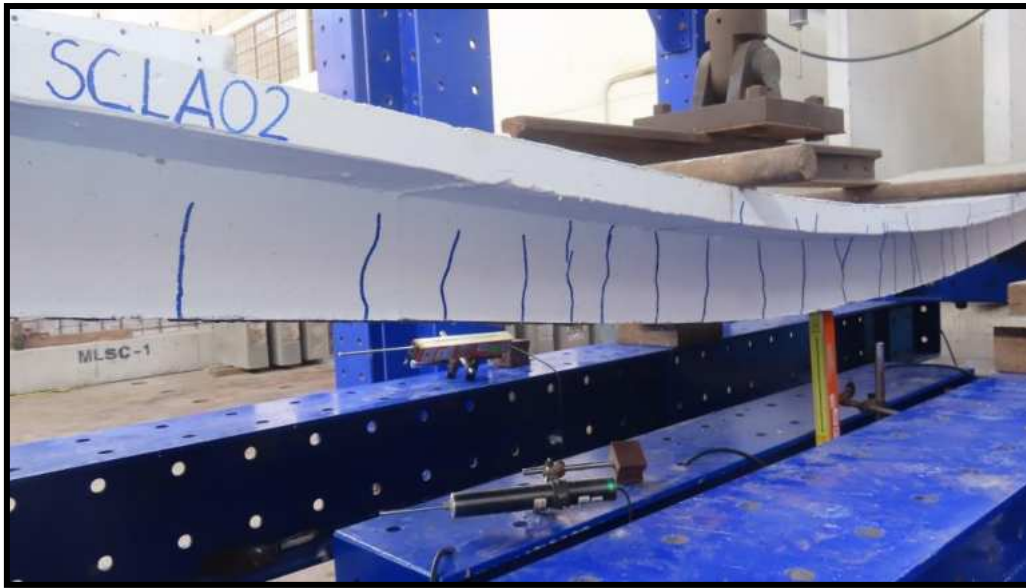
Figura N°46. Espécimen: SCLA02 – Vista lateral izquierda del prototipo SCLA02, al finalizar el ensayo de flexión de la losa.
