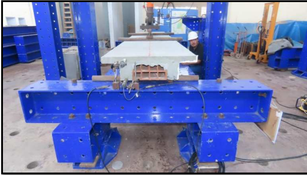
Figura N°44. Espécimen: SCLA02 – Vista frontal del prototipo SCLA02, para el inicio del ensayo de deflexión de la losa
