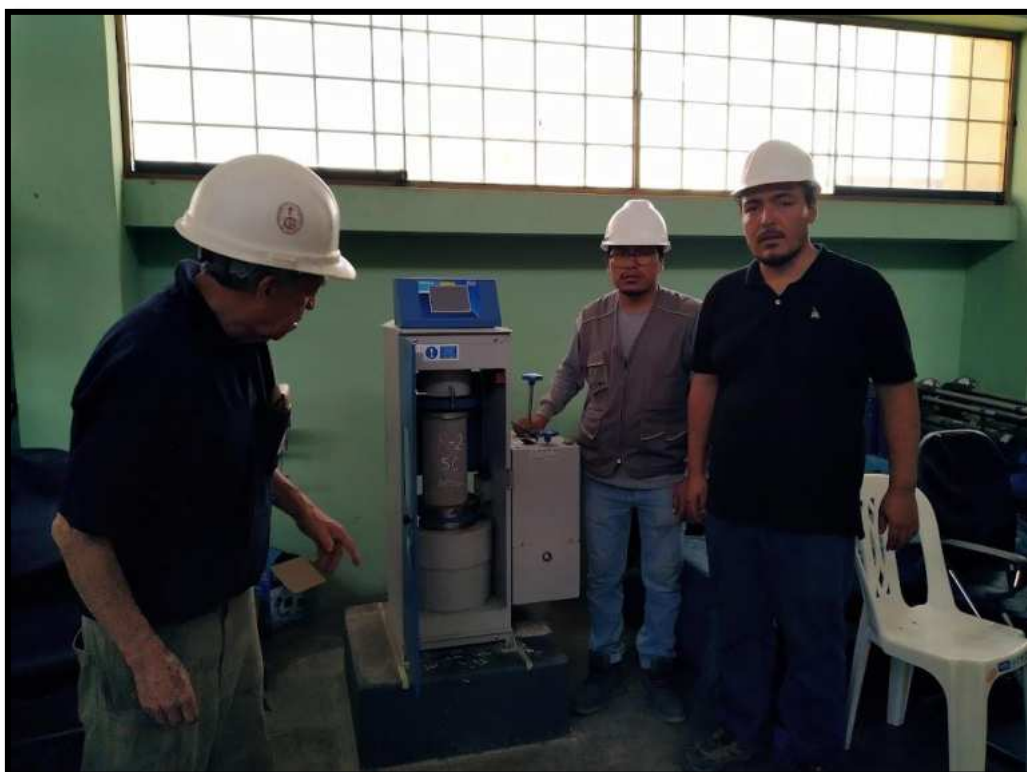
Figura N°59. Rotura de probetas para la validación de la resistencia a la compresión.
