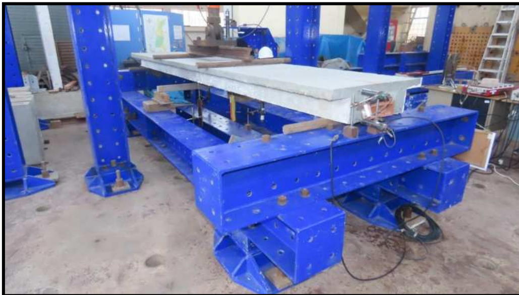
Figura N°45. Espécimen: SCLA02 – Vista frontal del prototipo SCLA02, para el inicio del ensayo de deflexión de la losa
