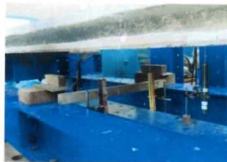
Foto 2. Transductores interiores a los tercios (CH-03 y CH-04).
