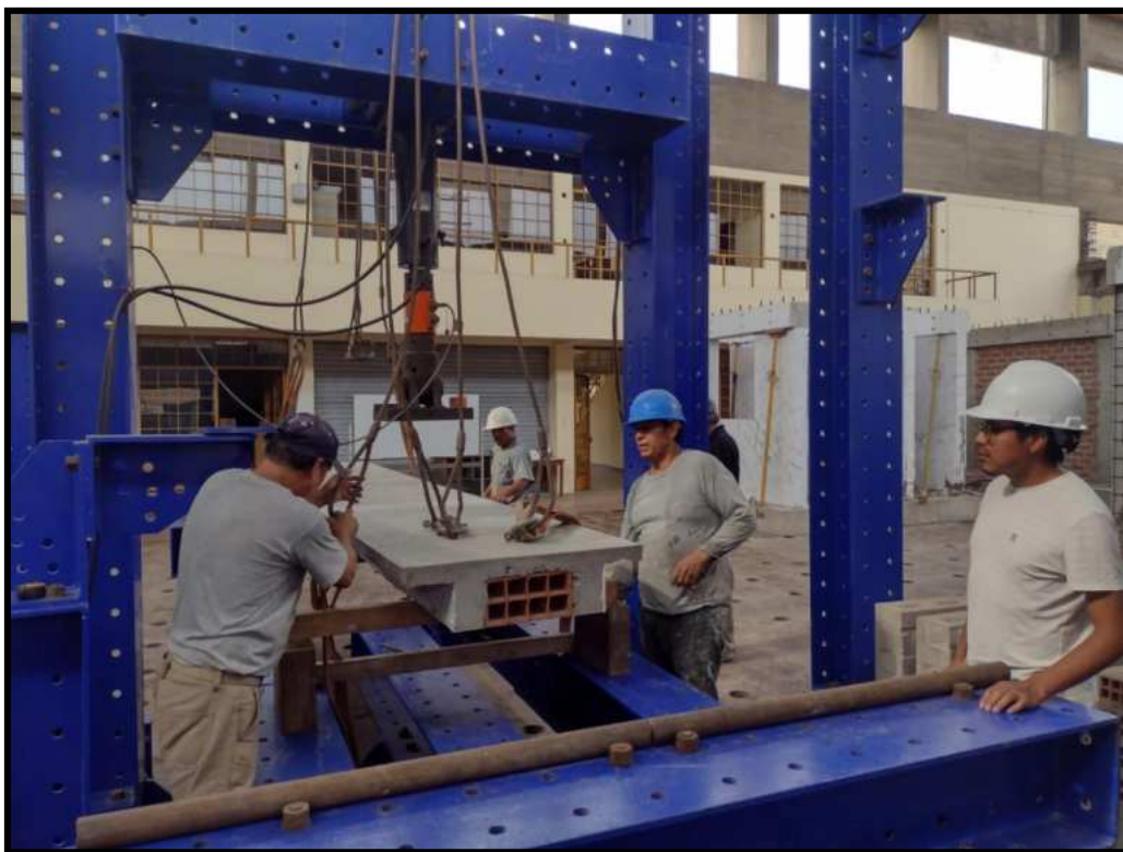
Figura N°37. Instalación y calibración del prototipo SCLA02 en el mecano.
