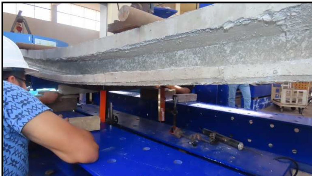
Figura N°51. Espécimen: SPBD01 – Colapso de la sección I de la losa aligerada SPBD01
