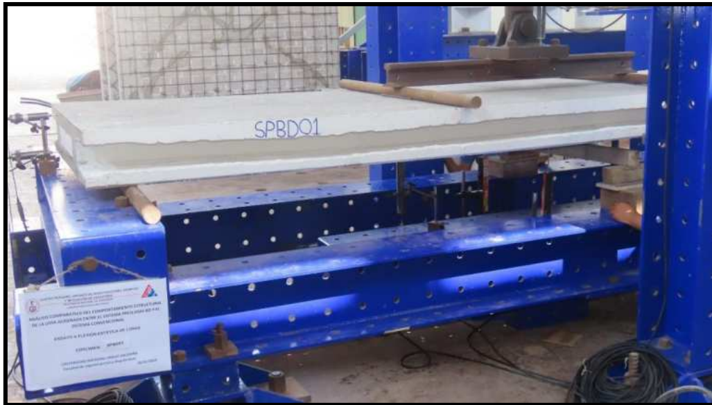
Figura N°50. Espécimen: SPBD01 – Prototipo ya colocado en el mecano con los sensores verticales y horizontales y la carga inicial 0.
