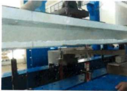
Foto 1. Celda de carga y transductores centrales (CH-01 y CH-02).
