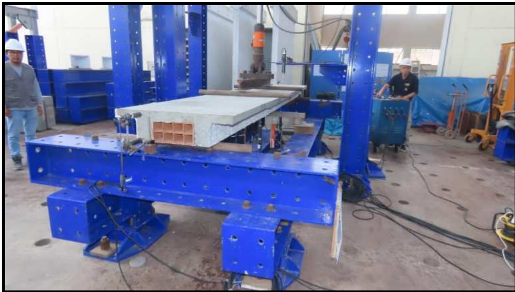
Figura N°39. Espécimen: SCLA01 – Inicio del ensayo a flexión estática de losas
