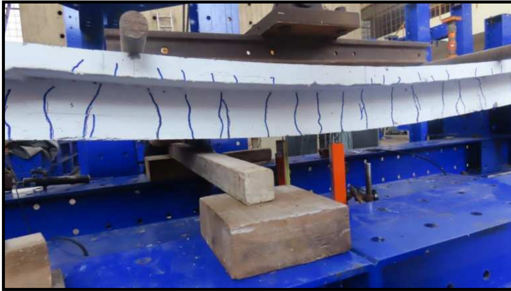
Figura N°42. Espécimen: SCLA01 – Marcas de fisuramiento durante el ensayo a la flexión en la otra cara lateral.
