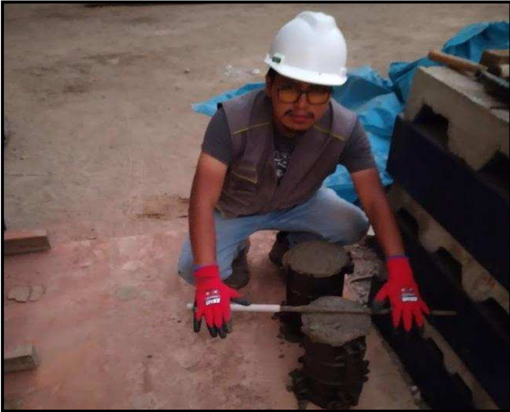
Figura N°22. Se aprecia el enrase de las probetas.
