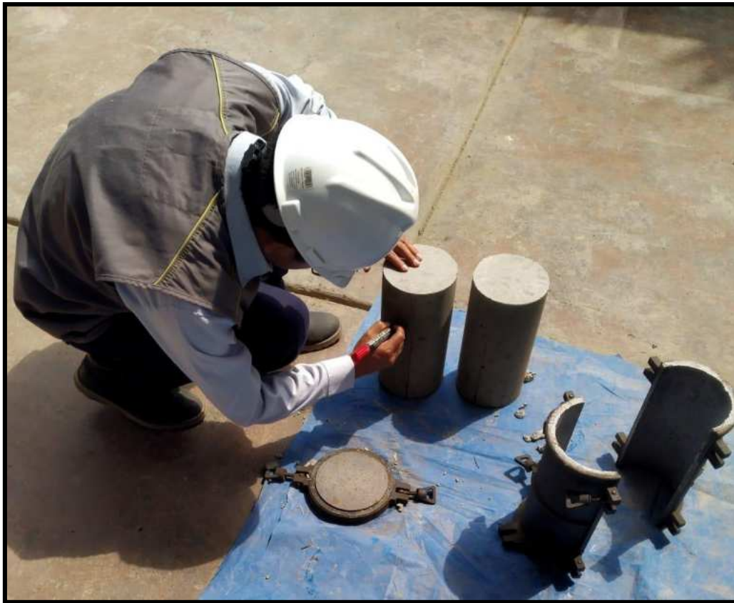
Figura N°34. Desencofrado de los moldes y rotulado de las probetas.
