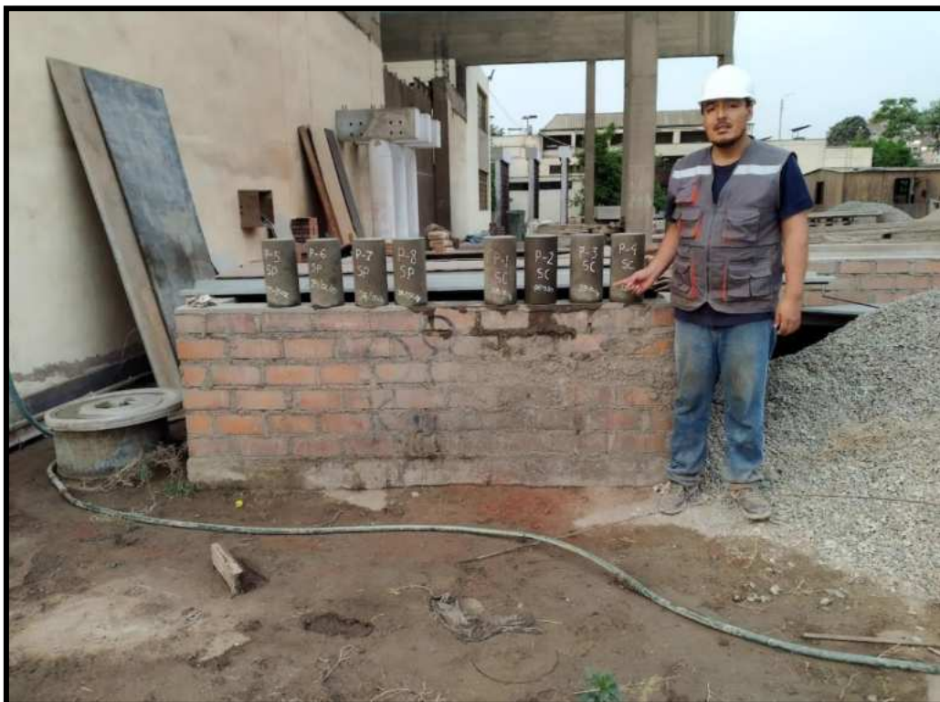
Figura N°35. Colocación de probetas en la poza de curado.
