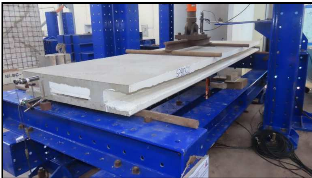
Figura N°49. Espécimen: SPBD01 – Prototipo ya colocado en el mecano con los sensores verticales y horizontales y la carga inicial 0.
