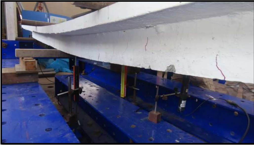
Figura N°40. Espécimen: SCLA01 – Marcas de fisuramiento durante el ensayo a la flexión en la otra cara lateral izquierda.
