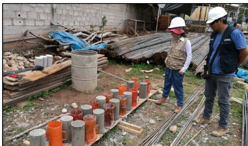
Fotografía 17.- Verificación del curado y desmoldado de probetas
