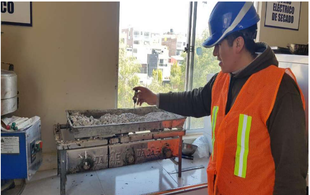
Anexo 42: calentado de los agregados a una temperatura de 140°.
