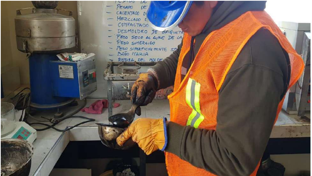
Anexo 26: mezclado de la mezcla asfáltica hasta obtener una mezcla homogénea.
