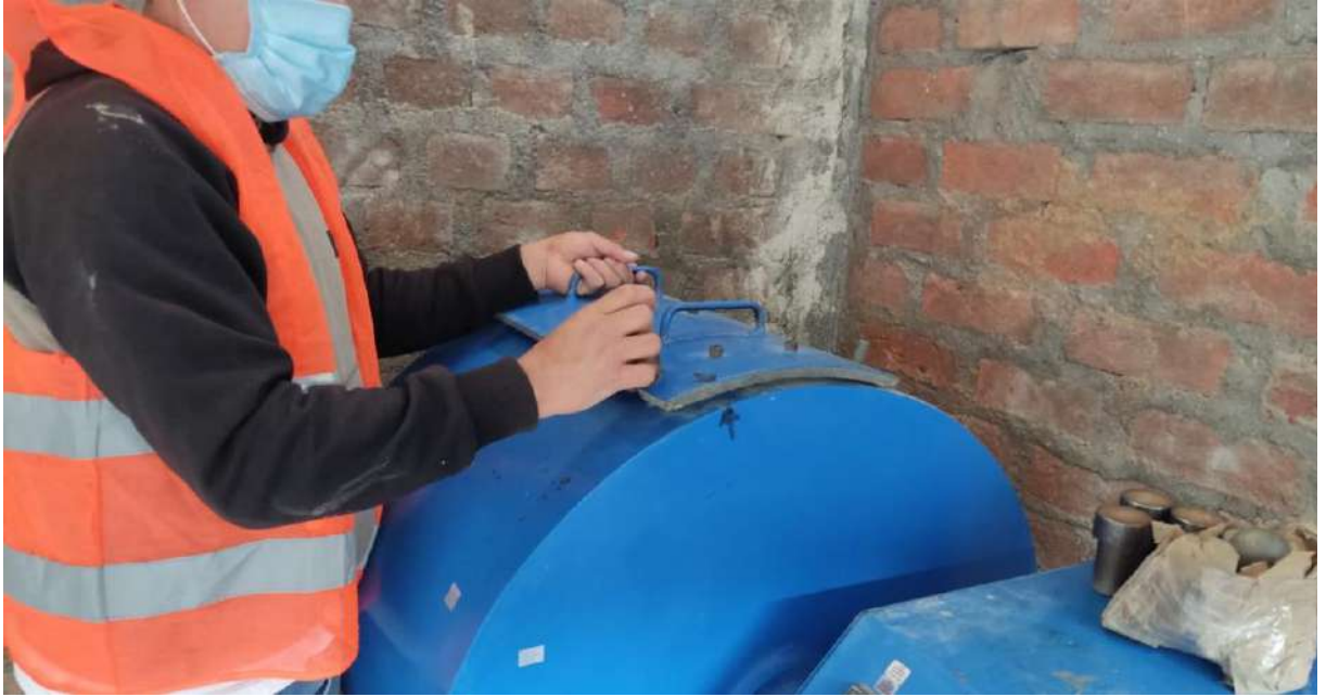
Anexo 12: colocado de las bolas de acero para desgastar a los agregados.
