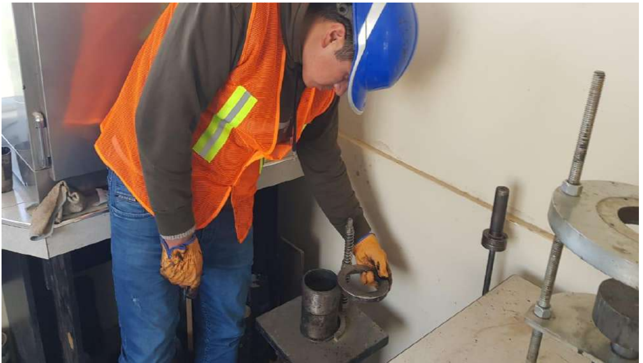
Anexo 28: colocado del collarín sobre el molde para el compactado de la mezcla.
