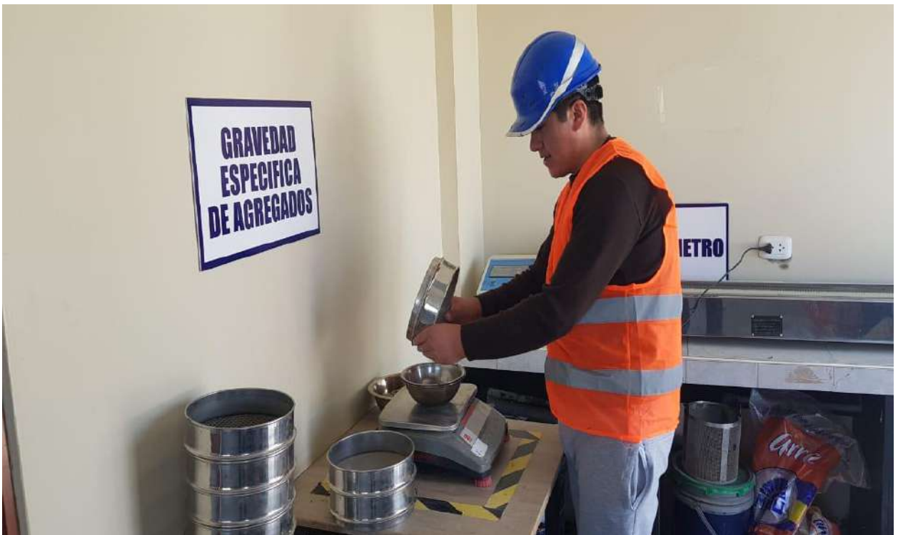
Anexo 16: pesado de las muestras de agregado retenidos en cada tamiz.
