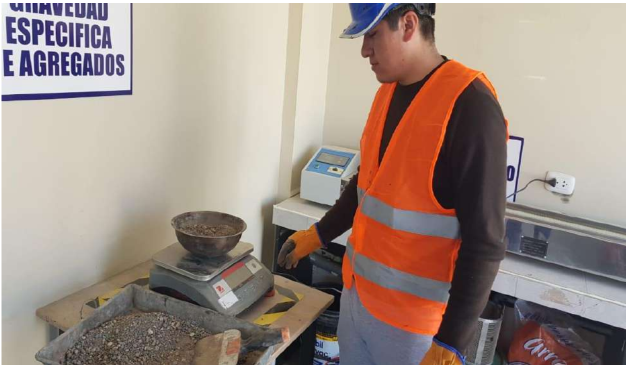
Anexo 18: pesado de la combinación de agregados por tamices
