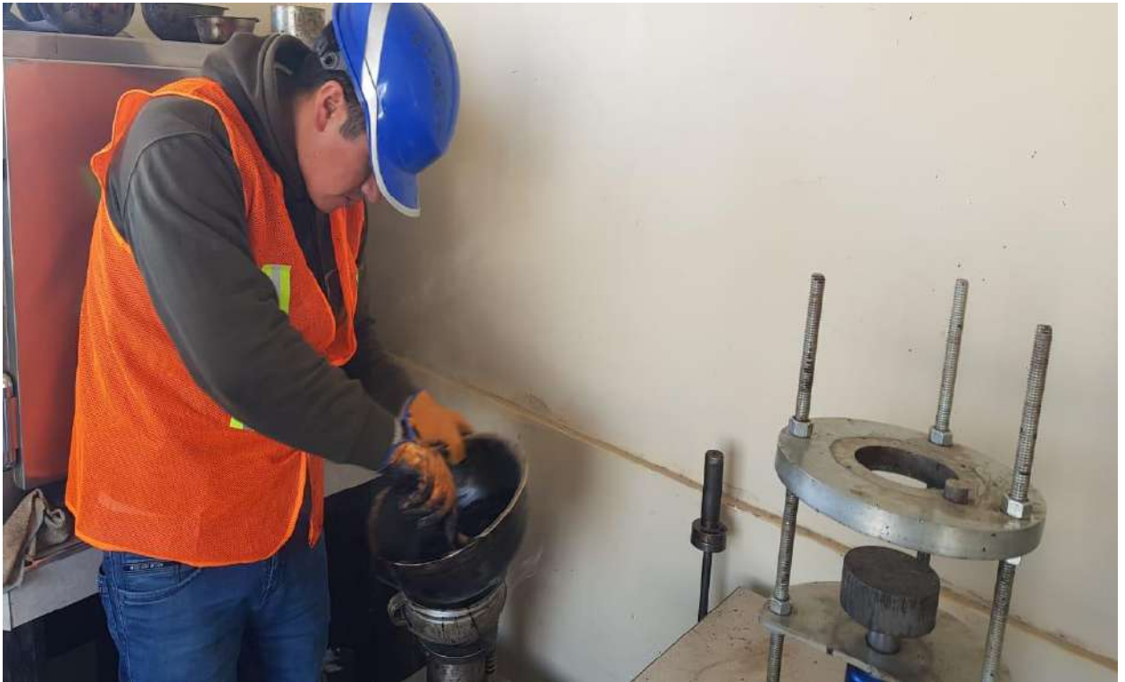
Anexo 30: compactado del molde con 75, 50 y 35 golpes para los diseños MAC-1, MAC-2 y MAC-3 respectivamente.
