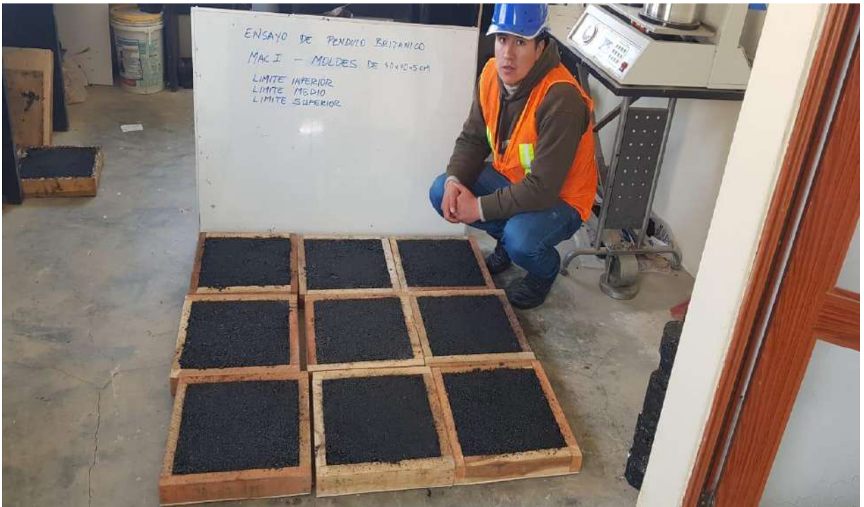
Anexo 48: presentación de los moldes con diseño MAC-1 con límite superior, medio e inferior.
