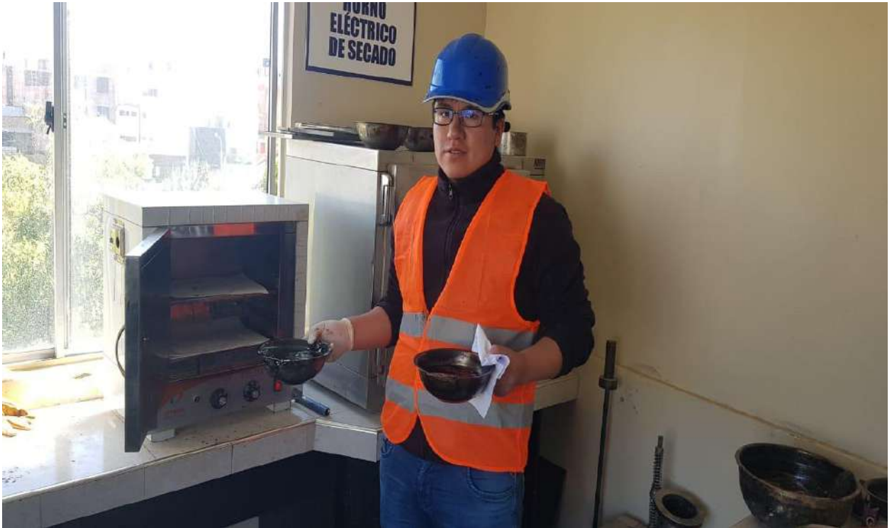
Anexo 24: calentamiento de los agregados a una temperatura de 140°.
