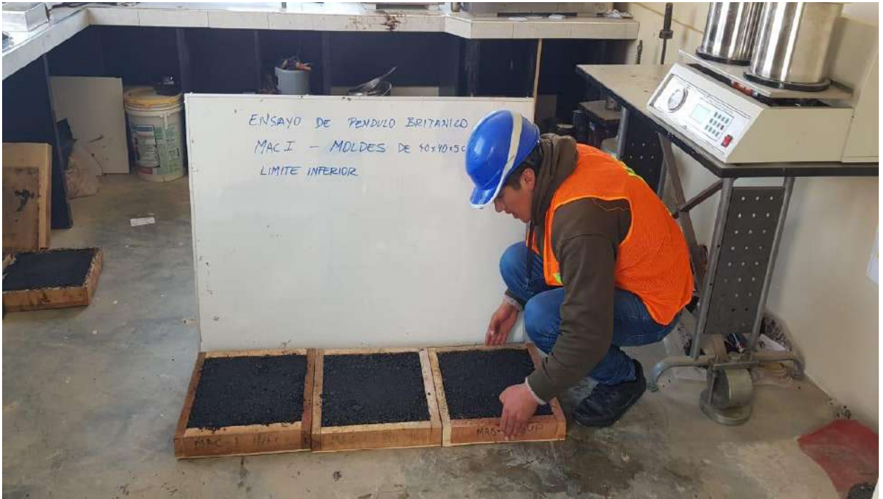
Anexo 48: presentación de los moldes con diseño MAC-1 con límite superior, medio e inferior.
