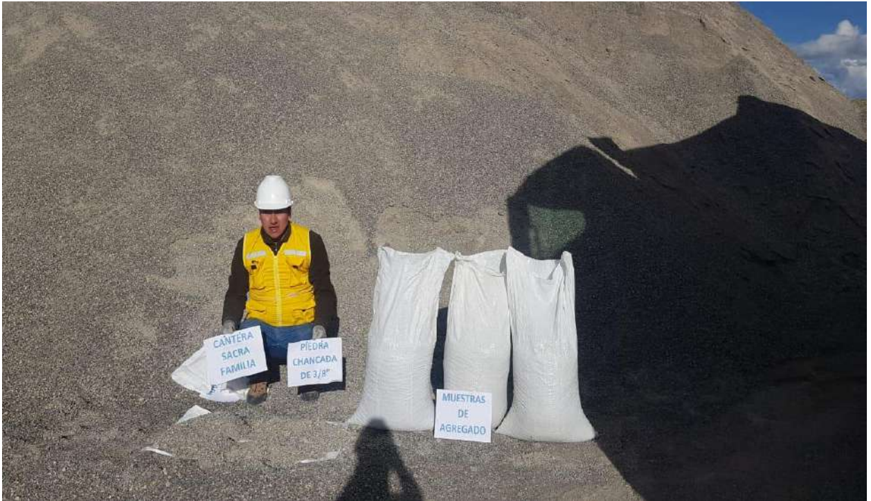
Anexo 1: acopio de agregado fino, arena chancada
