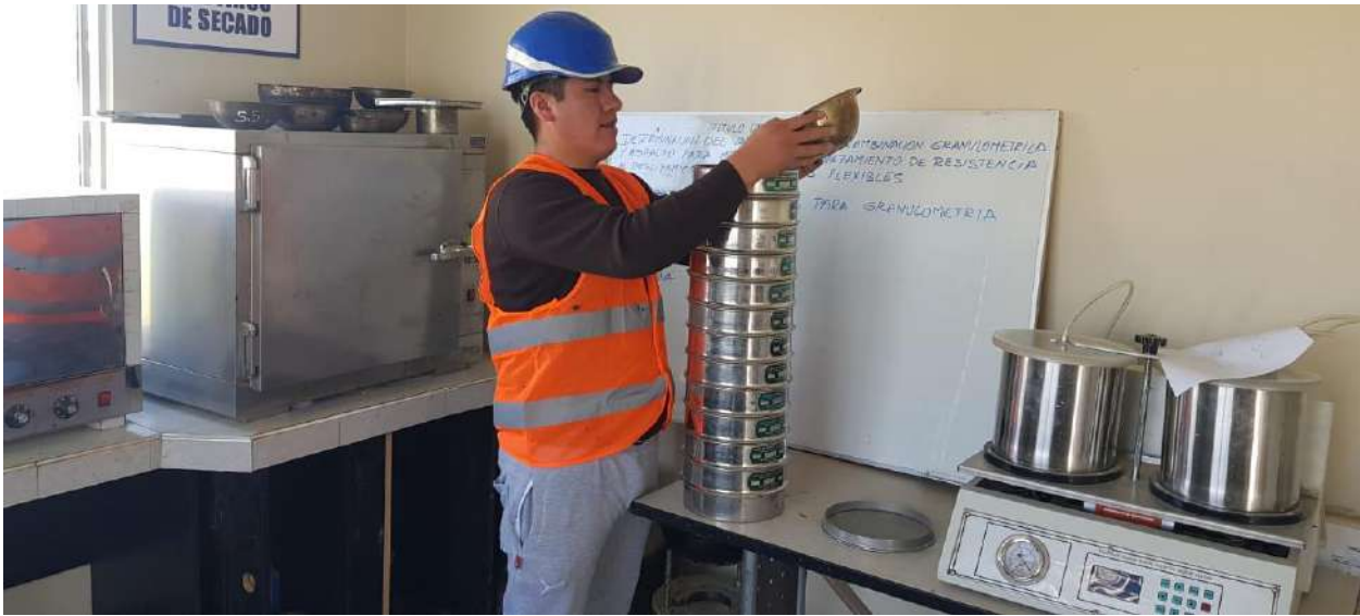
Ensayo de granulometría de los agregados gruesos, finos y filler.
