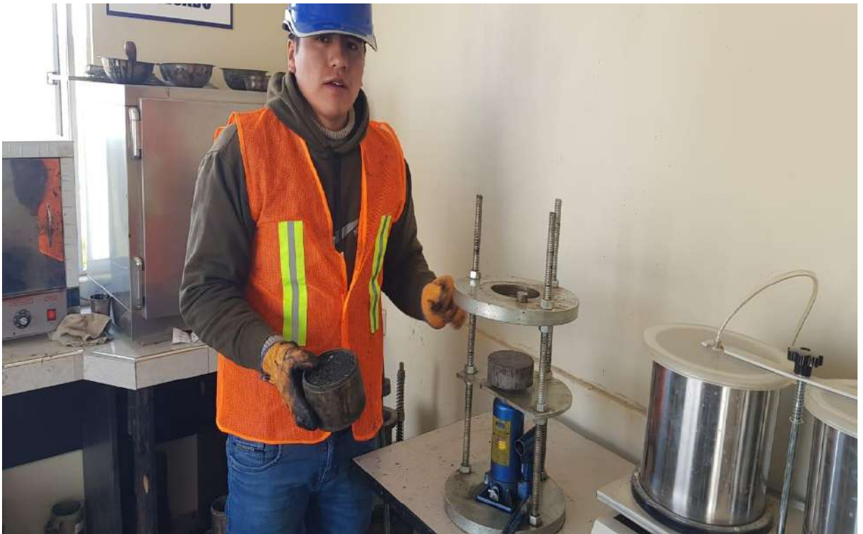
Anexo 32: prensa hidráulica para desmoldar el molde.
