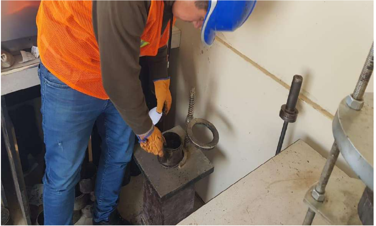
Anexo 28: colocado del collarín sobre el molde para el compactado de la mezcla.
