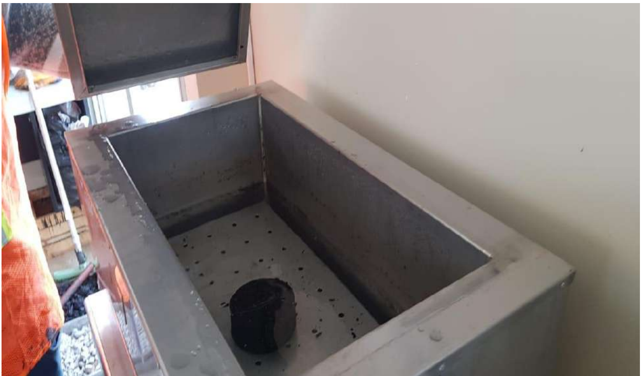
Anexo 38: ensayo de baño a maría del molde por un tiempo de 30 minutos a 60° de temperatura.
