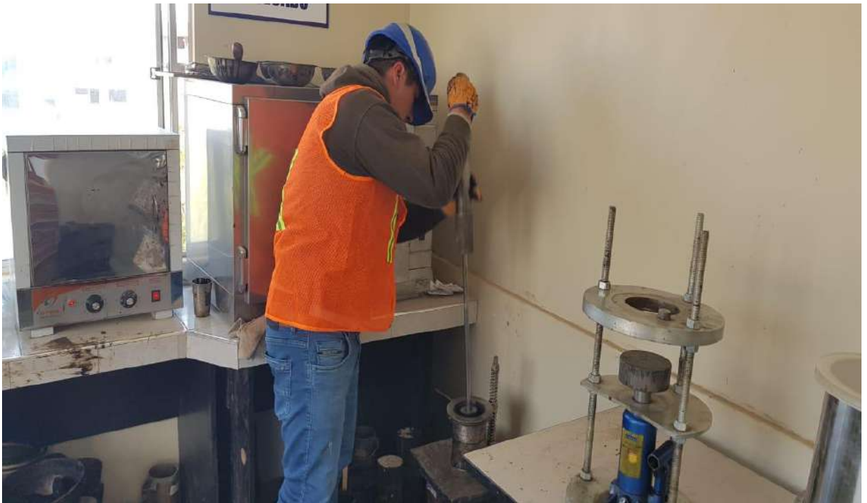
Anexo 30: compactado del molde con 75, 50 y 35 golpes para los diseños MAC-1, MAC-2 y MAC-3 respectivamente.
