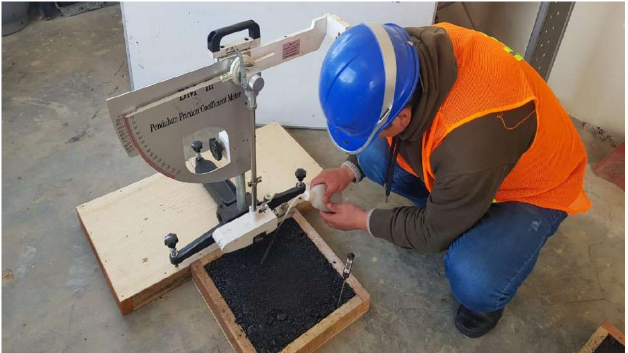
Anexo 52: lectura de los números de péndulo británico al soltar el brazo del péndulo británico.
