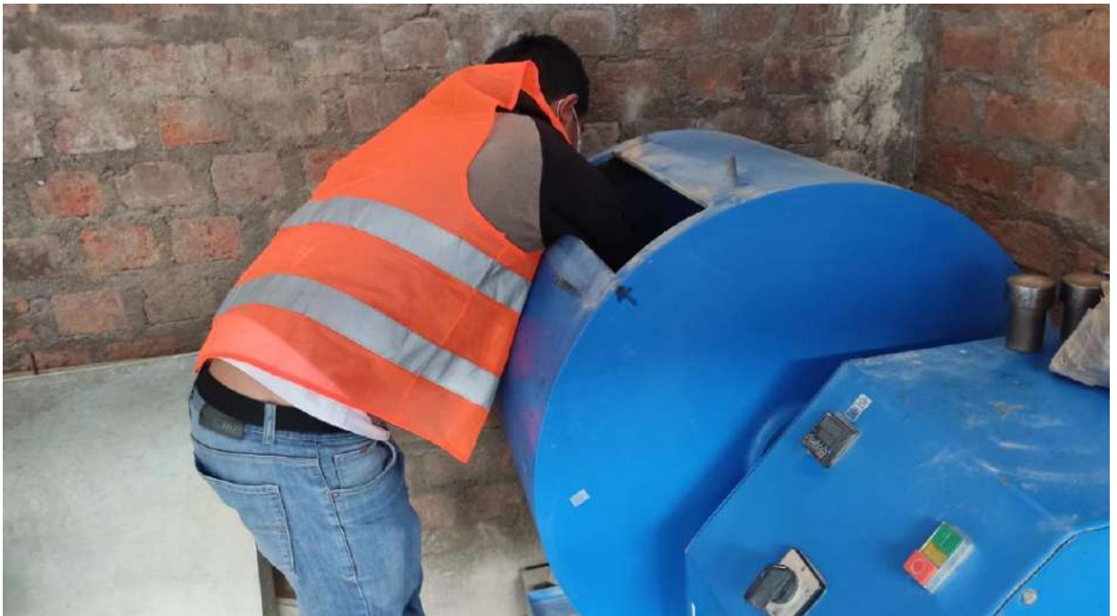
Anexo 12: colocado de las bolas de acero para desgastar a los agregados.
