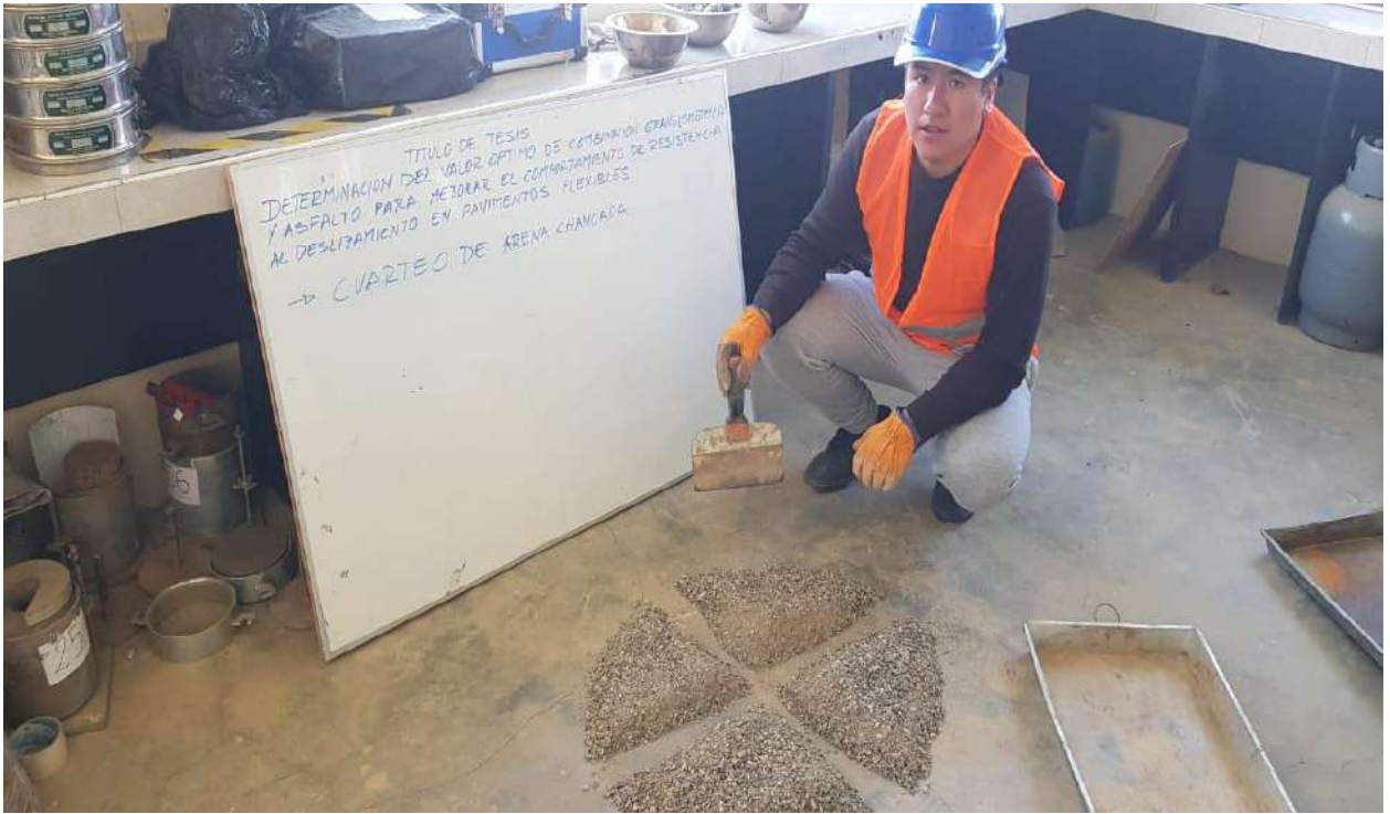
Anexo 6: pesado de los agregados para realizar el ensayo granulométrico con 3000 gr.
