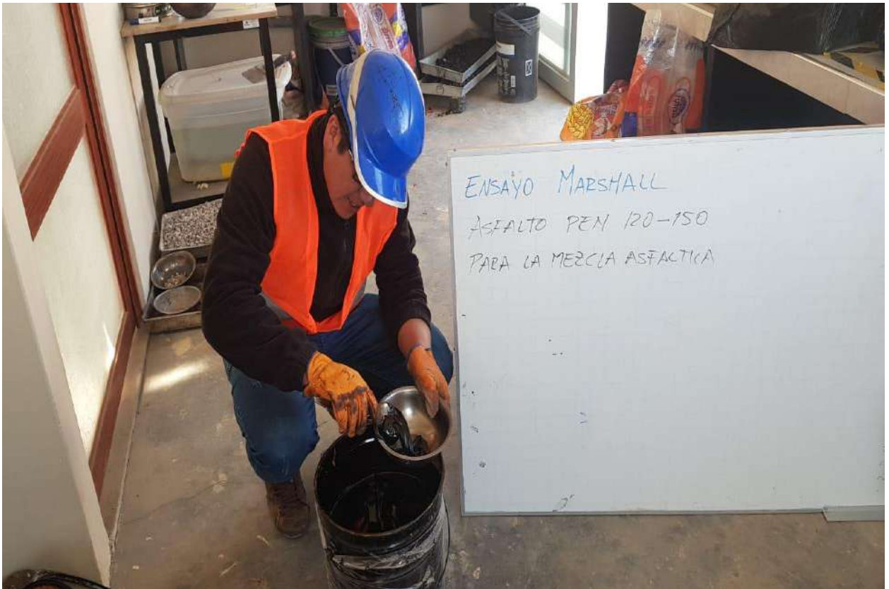
Anexo 22: cemento asfáltico PEN 120-150 para calentarlo en el horno.
