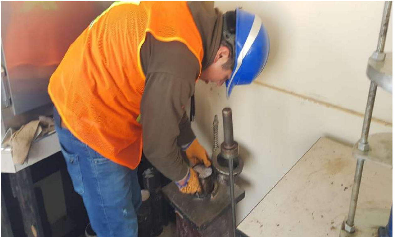
Anexo 32: prensa hidráulica para desmoldar el molde.
