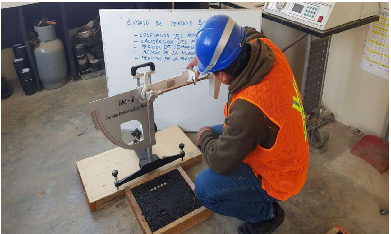
Anexo 52: lectura de los números de péndulo británico al soltar el brazo del péndulo británico.
