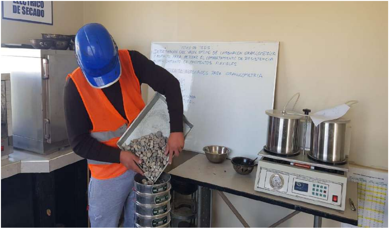
Anexo 16: pesado de las muestras de agregado retenidos en cada tamiz.
