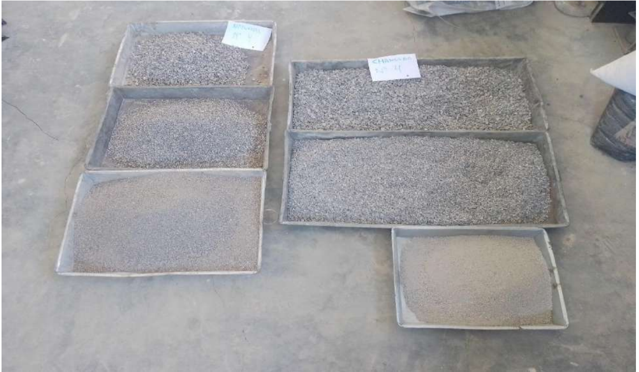
Anexo 18: pesado de la combinación de agregados por tamices
