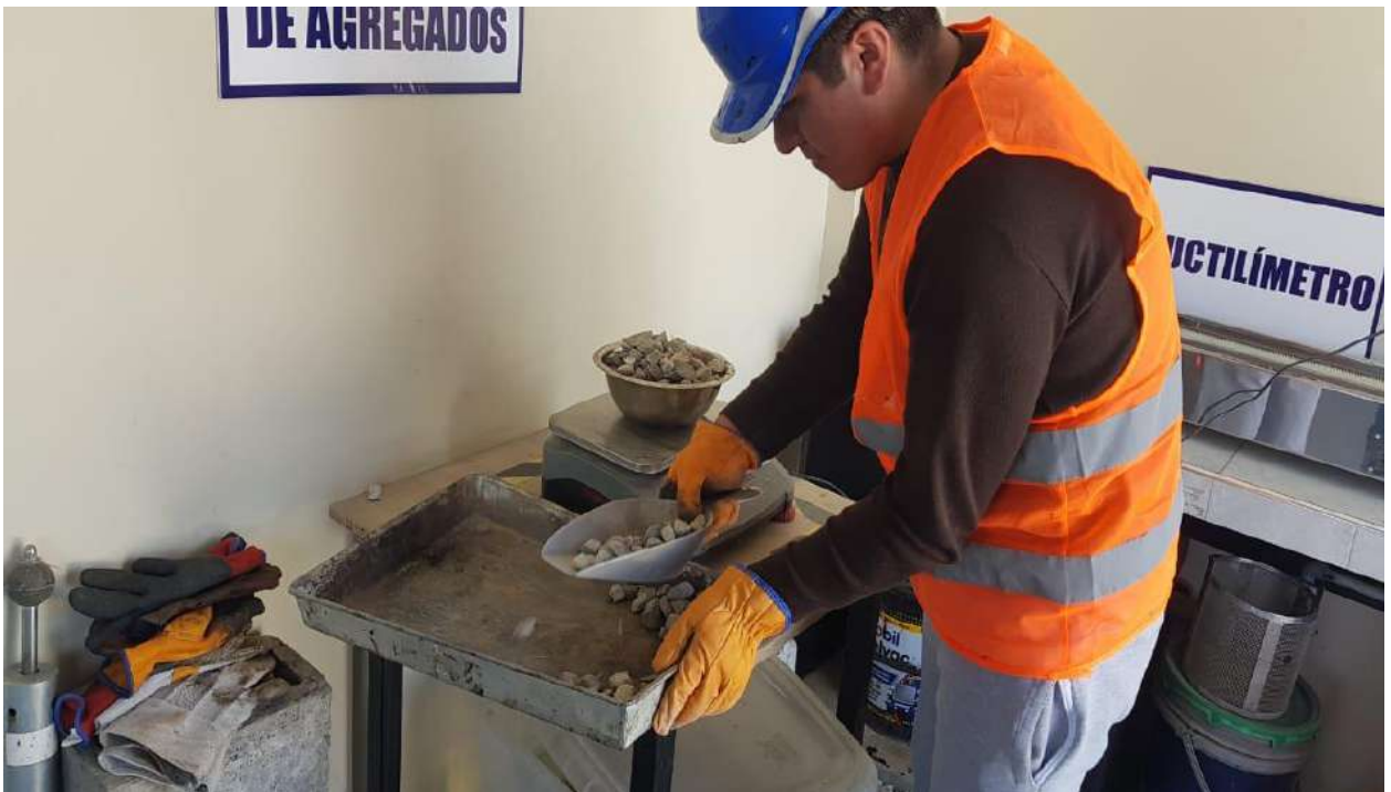
Anexo 6: pesado de los agregados para realizar el ensayo granulométrico con 3000 gr.
