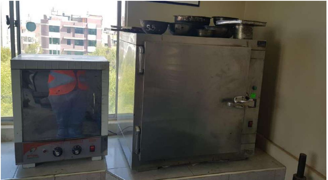
Anexo 22: cemento asfáltico PEN 120-150 para calentarlo en el horno.
