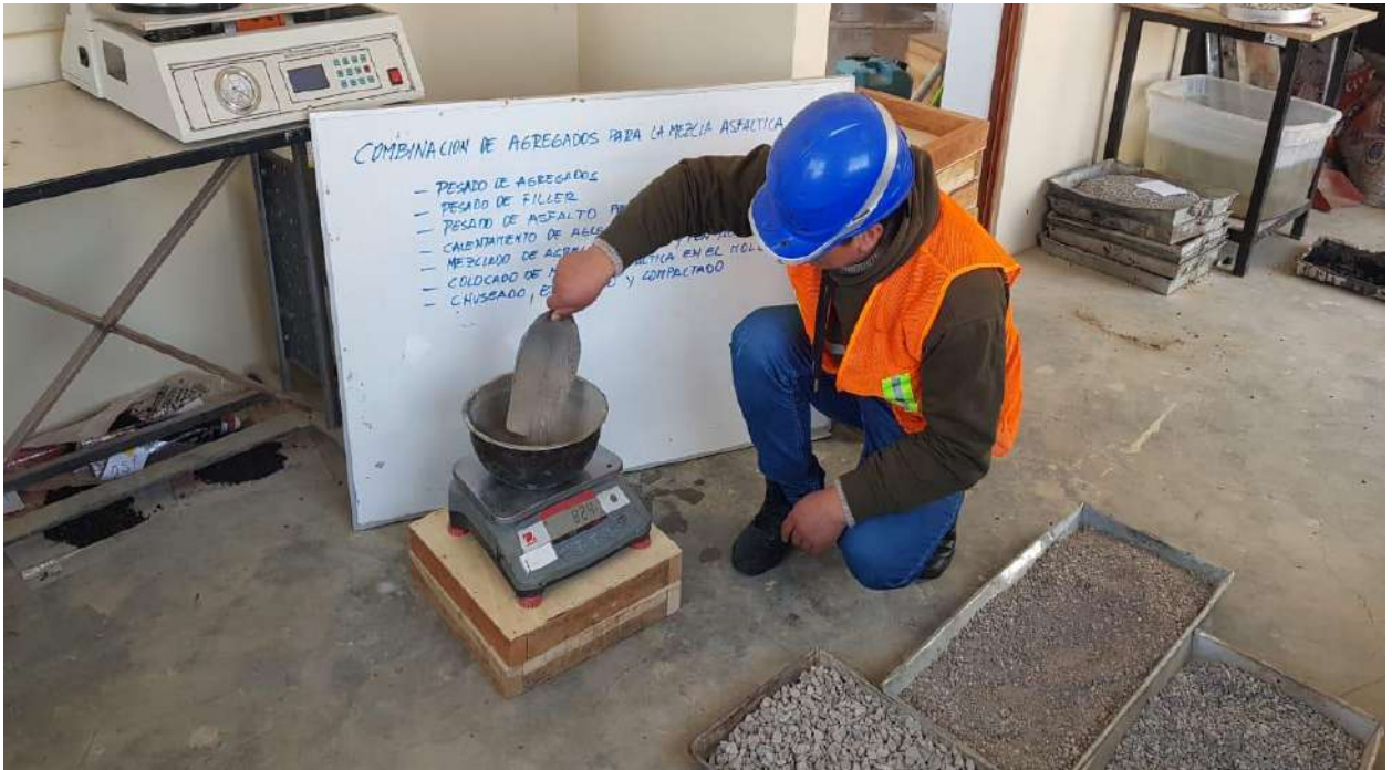
Anexo 42: calentado de los agregados a una temperatura de 140°.
