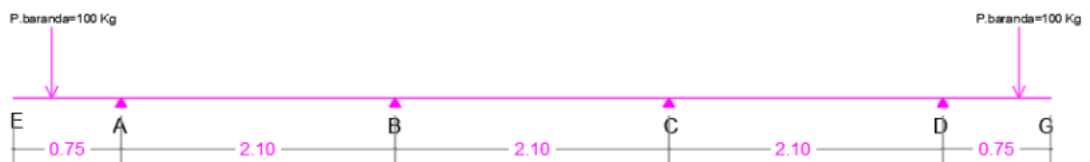
Figura 33 Idealización del peso de las barandas
