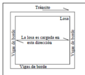
Figura 14 Losa cargada en la dirección del tránsito
