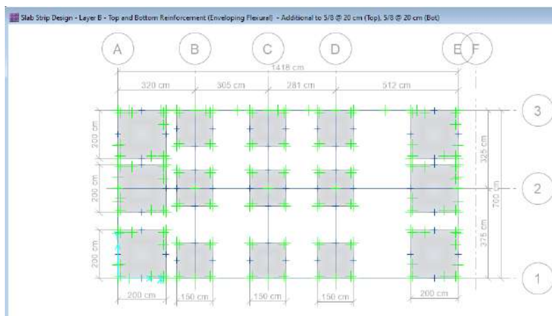
Figura 79 Distribución de acero en las zapatas aisladas-SAFE
