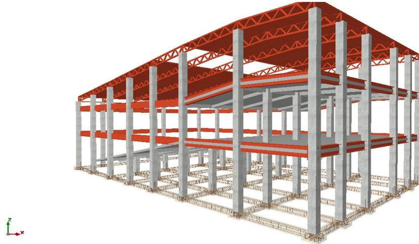
Nota: En la anterior imagen se puede apreciar la vista isométrica del modelamiento completo de la estructura para el diseño estructural de un auditorio en el software CYPE 3D.
