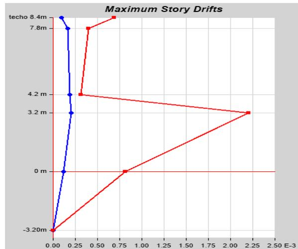
Nota: En la anterior imagen se puede apreciar las derivas elásticas Y-Y con elementos predimensionados de la norma E030 2018 de la estructura para el diseño estructural de un auditorio en el software ETABS.
