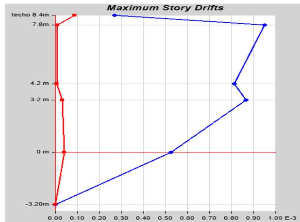
Nota: En la anterior imagen se puede apreciar las derivas elásticas X-X con elementos predimensionados de la norma E030 2018 de la estructura para el diseño estructural de un auditorio en el software ETABS.
