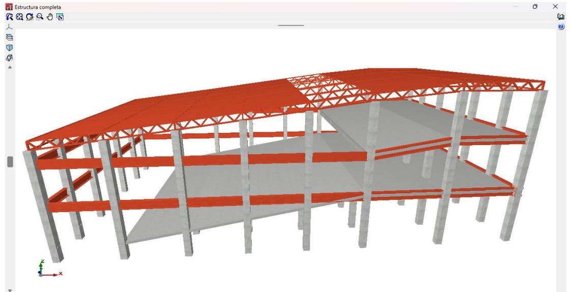
Nota: En la anterior imagen se puede apreciar la vista 3D del modelamiento completo de la estructura para el diseño estructural de un auditorio en el software CYPE 3D.
