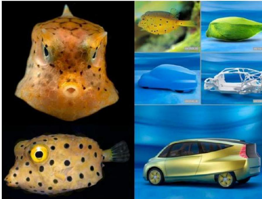
Nota: En la imagen se visualiza la ilustración de un diseño estructural con soft kill option y analogía al pez cofre en el diseño de coche. Fuente: Tesis Modelo metodológico de diseño conceptual con enfoque biomimético.
