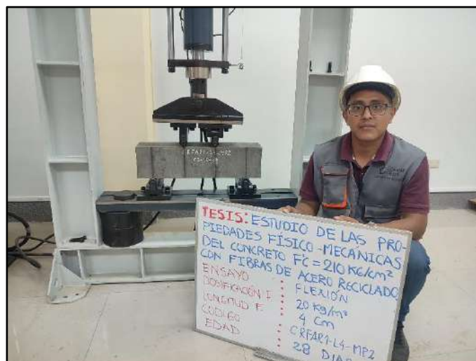
Figura 55 Prueba de concreto a la flexión
