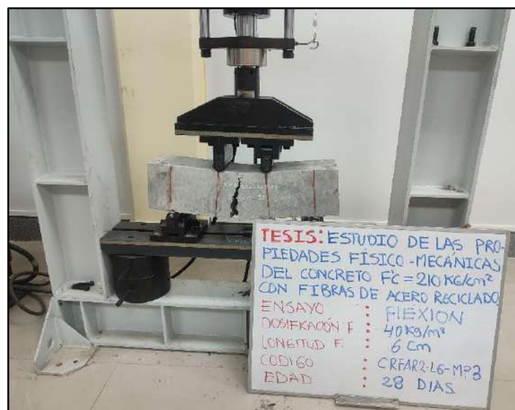
Figura 57 Viga de concreto prismática posterior al ensayo
