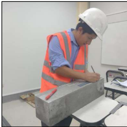
Figura 54 Medición de probetas de concreto prismáticas
