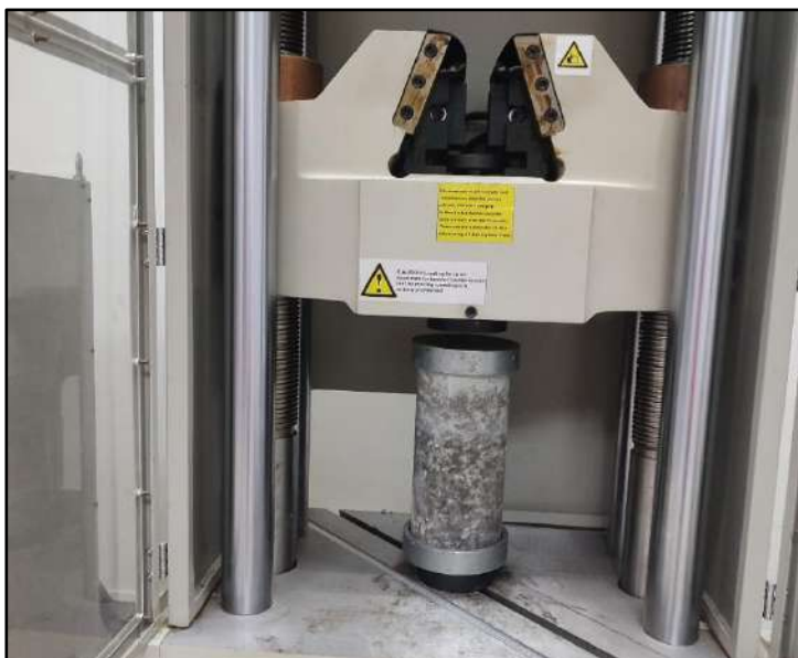
Figura 2 Ensayo de resistencia a la compresión del concreto
