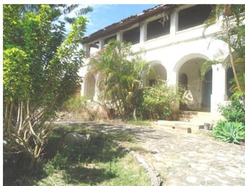
Imagen120, 121: Los Arcos rebajados son la característica principal de la estructura del Módulo A, B y C originalmente eran de adobe y mortero de barro y paja.
