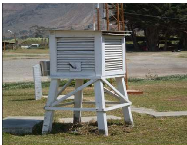
Imagen N° 131 Caseta Meteorológica; Fuente: toma fotográfica propia
