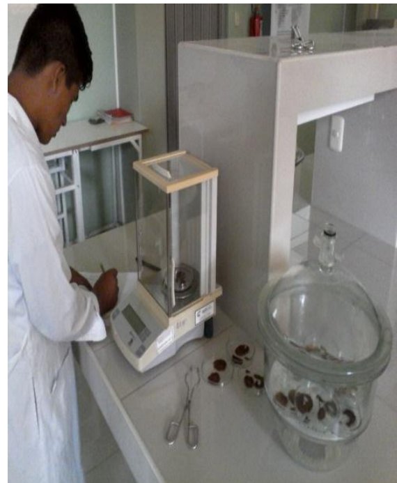
Figura 8. Determinación de humedad
