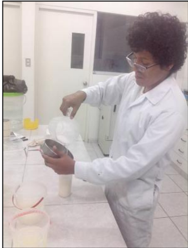
Figura 58. Segundo filtrado: separación de residuos de fibra.
