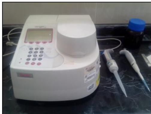
Figura 67. Lectura de absorbancia en el almidón de yuca por medio del espectrofotómetro.
