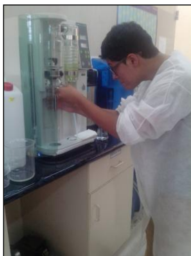
Figura 72. Destilación del HCN contenido en las muestras.
