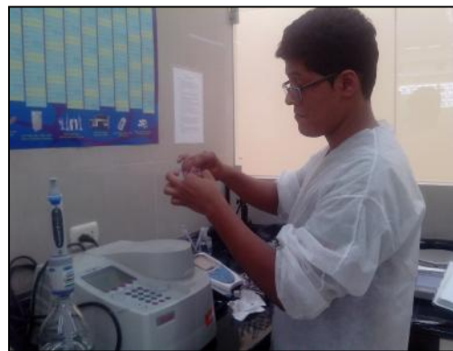
Figura 73. Determinación colorimétrica de HCN en muestras
