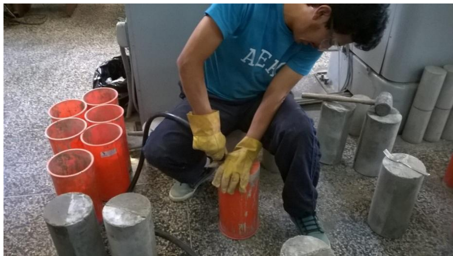
Figura 2.19. Desencofrado con aire comprimido de las probetas experimentales de concreto pegado con adhesivo epóxico. Fuente: Propia, basada en el desarrollo de la presente tesis.
