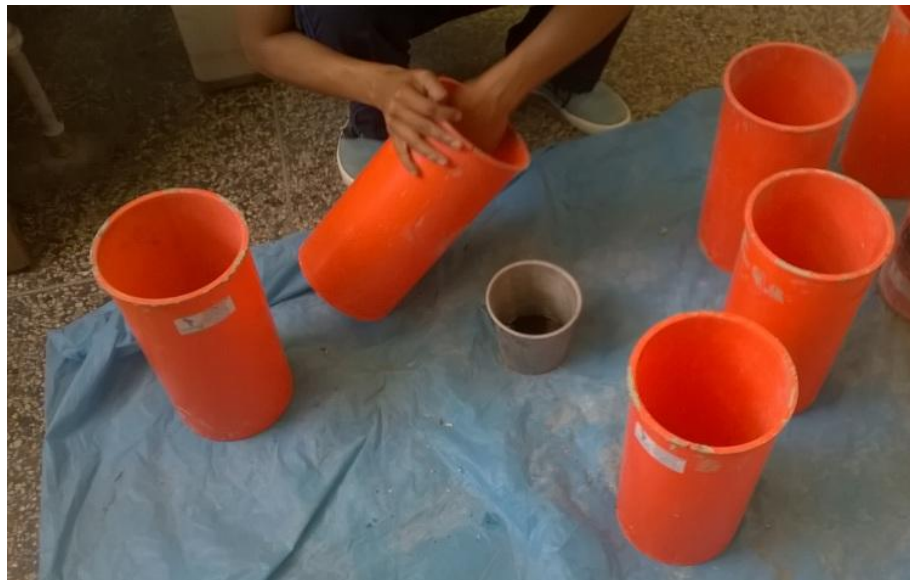
Figura 2.4. Habilitado de la probeta de plástico (6"x12")
