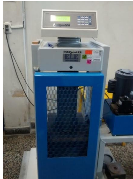
Figura 2.30. Ensayo a compresión de la probeta de control.
