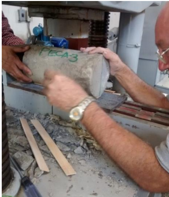
Figura 2.27. Ensayo a compresión diametral a 7 días.
