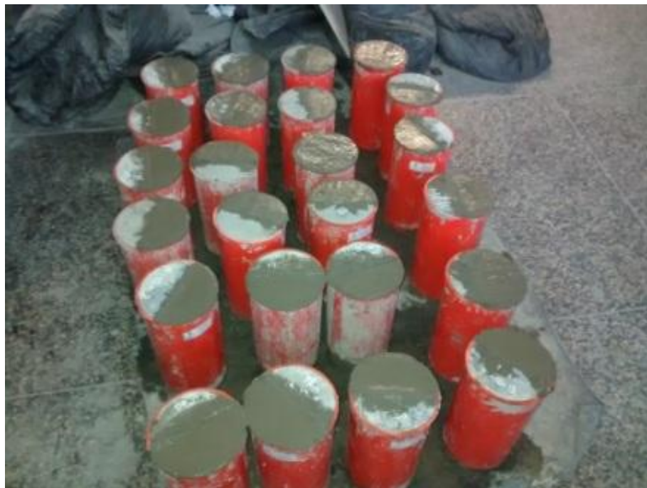
Figura 2.17. Completado de las probetas experimentales de concreto tratadas (pegadas) con adhesivo epóxico
