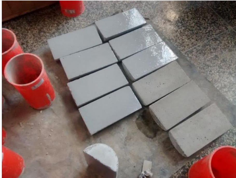
Figura 2.15. Aplicación del adhesivo epóxico en las medias probetas experimentales de concreto.
