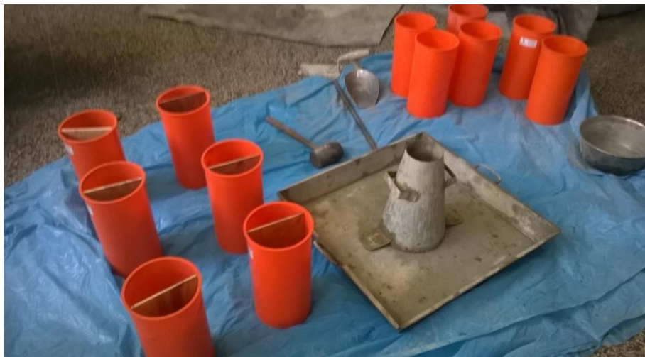
Figura 2.6. Colocación de del triplay ( e=4\text{mm} ) en los moldes de plástico.
