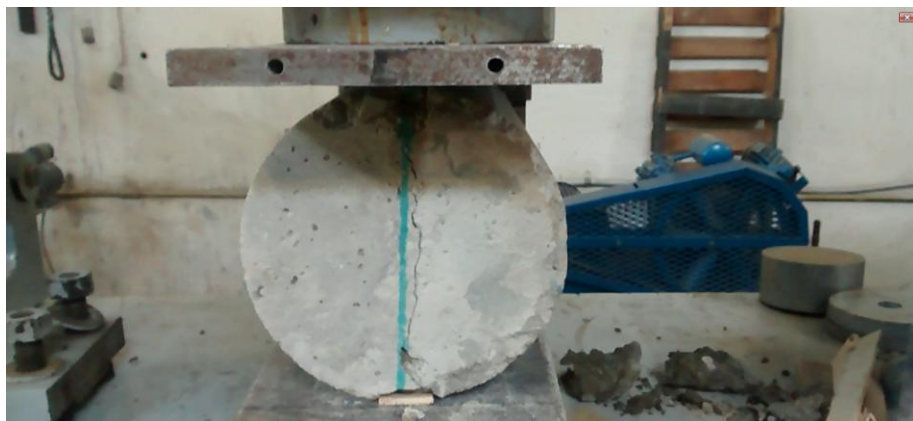
Figura 2.39. Lectura confiable después del ensayo a compresión diametral o Split test de la probeta experimental.
