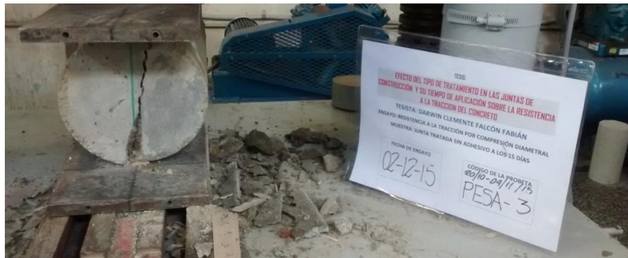
Figura 2.38. Mala señal de diámetro de la probeta experimental antes del ensayo a compresión diametral o Split test.
