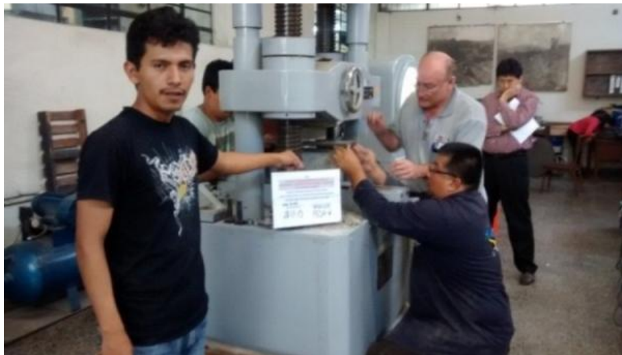
Figura 2.24. Ensayo a compresión diametral a los 7 días de las probetas experimentales sin adhesivo.
