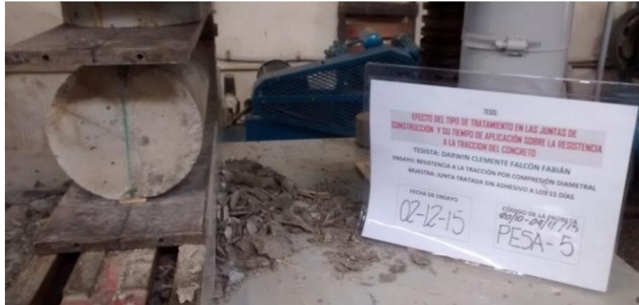
Figura 2.25. Ensayo a compresión diametral o Split test a los 15 días de las probetas experimentales sin adhesivo epóxico.
