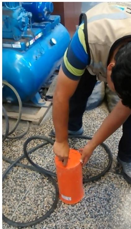
Figura 2.8. Desencofrado con aire comprimido de las probetas.
