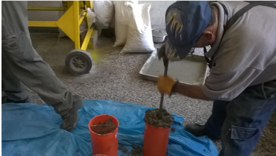
Figura 2.7. Vaciado de las probetas experimentales
