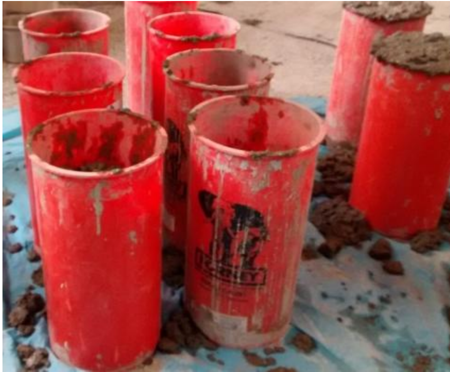
Figura 2.5. Vaciado con concreto sobre las probetas de plástico (6"x12").
