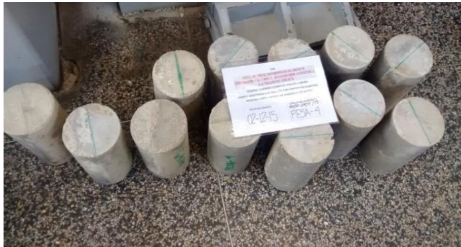
Figura 2.22. Probetas experimentales de concreto con junta tratada sin adhesivo epóxico a los 15 días.
