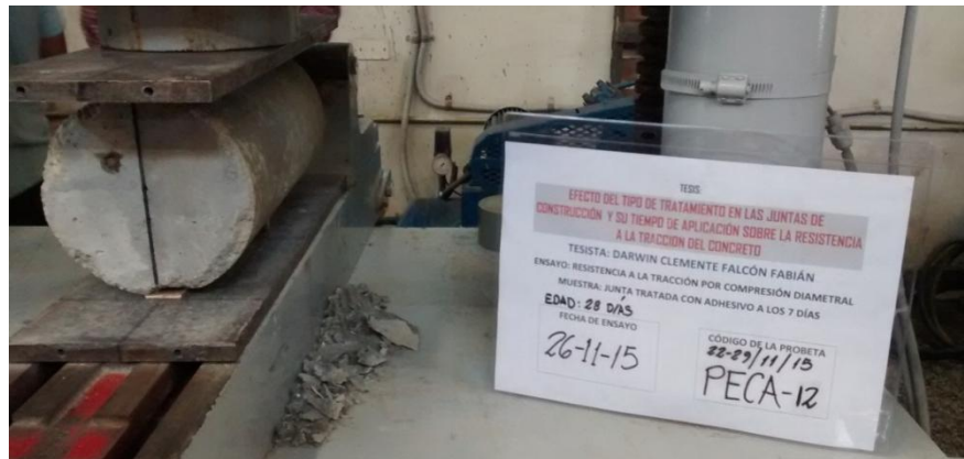
Figura 2.36. Probeta experimental con adhesivo antes del ensayo.
