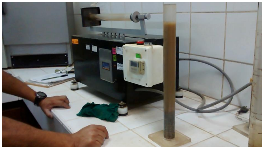
Figura 2.2. Ensayo de equivalente de arena para el agregado fino.
