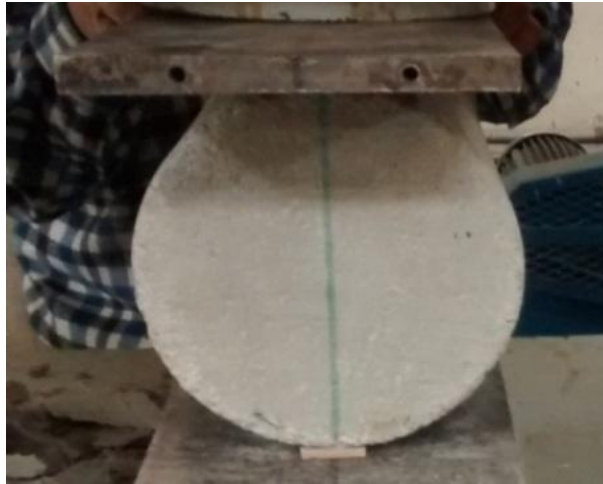
Figura 1.3. Ensayo a tracción por compresión diametral o split test de una probeta de concreto (6"x12").
