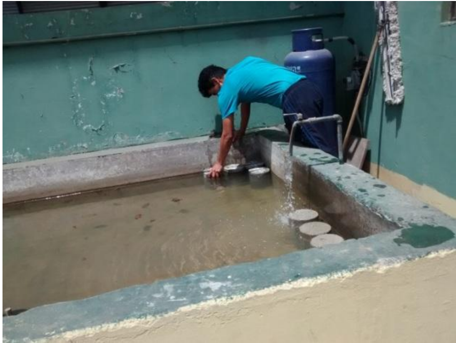
Figura 2.10. Colocación de probetas experimentales de concreto en la piscina de curado.
