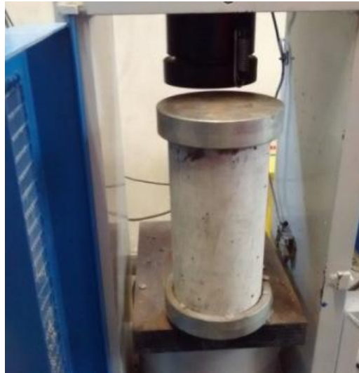
Figura 1.1. Ensayo a compresión de una probeta de concreto de 6"x12".
