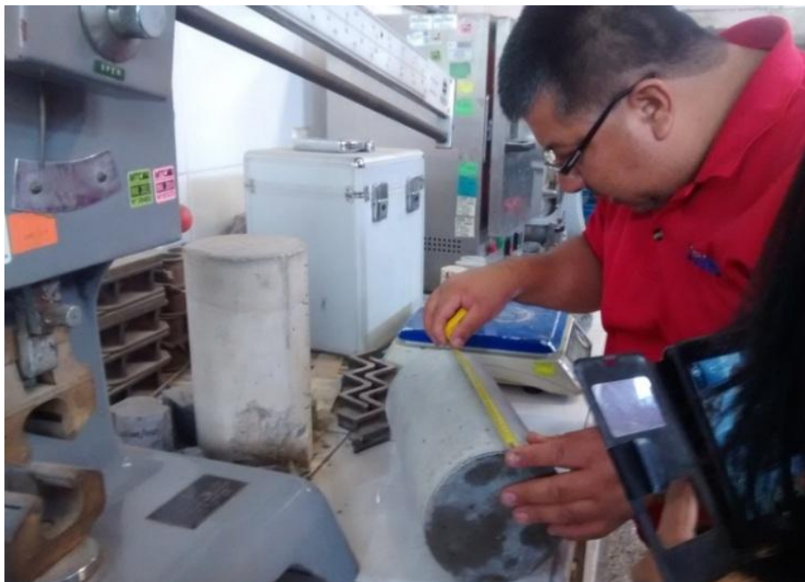
Figura 2.29. Mediciones del peso, altura y diámetro de la probeta de concreto.
