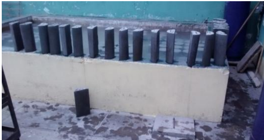
Figura 2.11. Secado superficial de las medias probetas experimentales.
