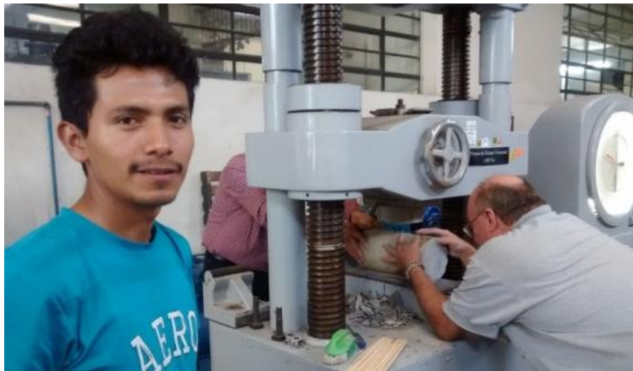
Figura 2.28. Ensayo a compresión diametral de la probeta de control.
