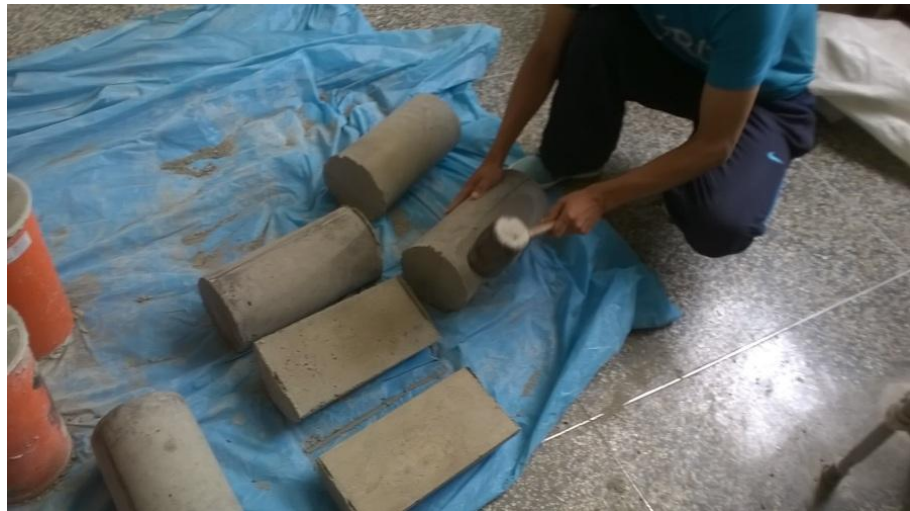
Figura 2.9. Procedimiento de la obtención de 2 medias probetas después del desencofrado de las probetas experimentales.
