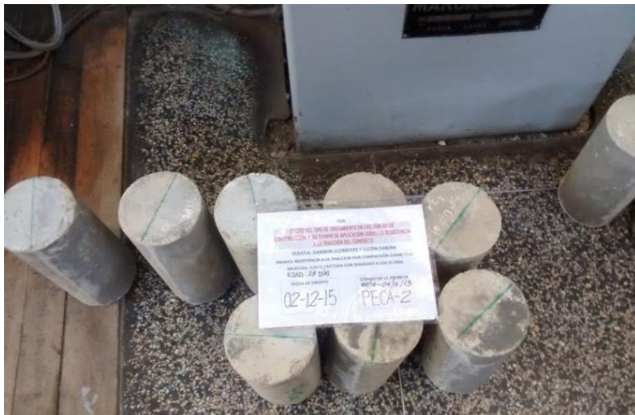
Figura 2.21. Probetas experimentales de concreto con junta tratada con adhesivo epóxico a los 15 días.
