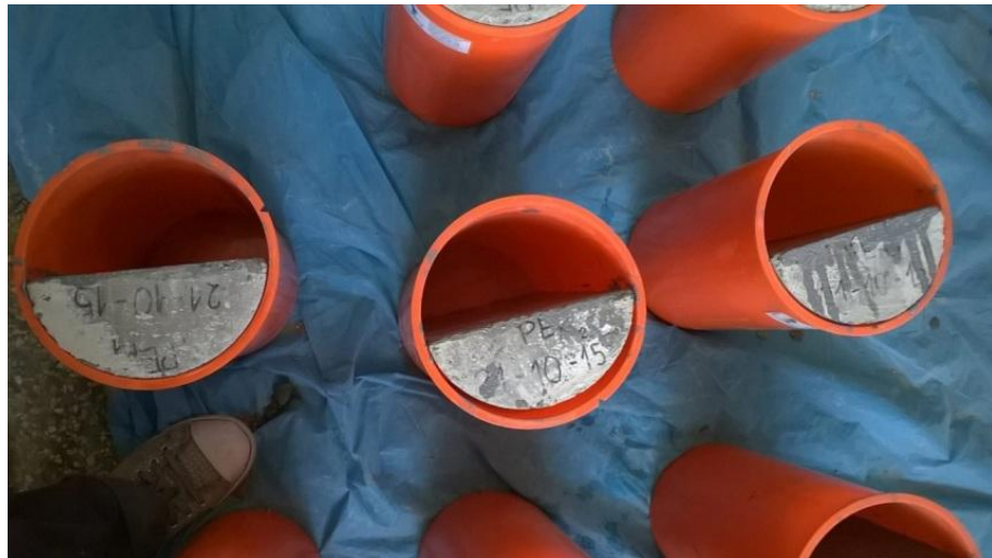
Figura 2.16. Medias probetas de concreto tratadas con adhesivo epóxico.
