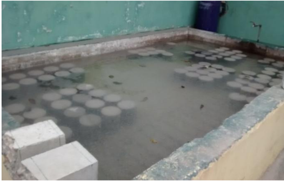
Figura 2.20. Curado de las probetas de concreto experimentales y de control.
