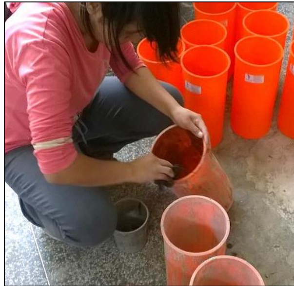
Figura 2.23 – Humedecido de los moldes con petróleo FUENTE: Elaboración propia
