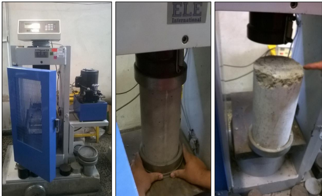
Figura 2.27 – Ensayo de resistencia a compresión FUENTE: Elaboración propia
