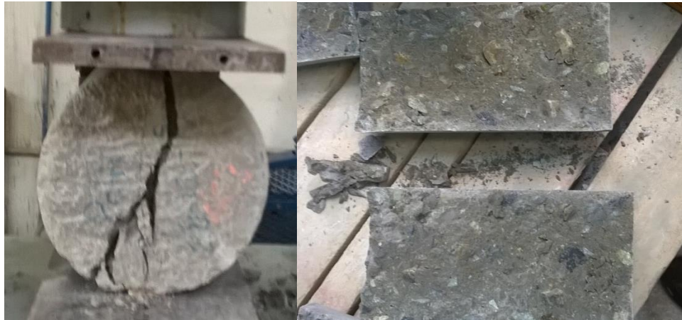
Figura 2.46 – Probeta MCT21-5 ensayada a resistencia de tracción por compresión diametral a 28 días FUENTE: Elaboración propia
