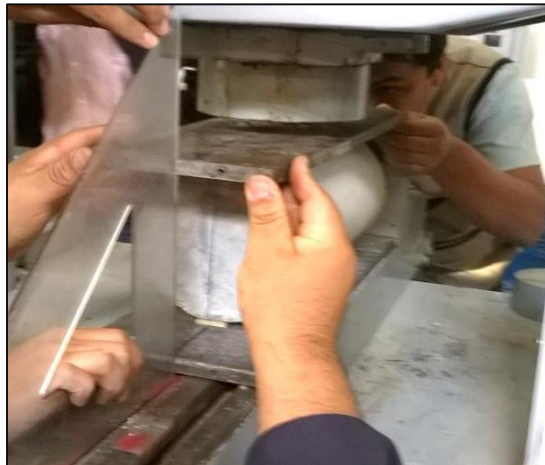
Figura 2.32 – Verificación del colocado de la probeta en la maquina uniaxial FUENTE: Elaboración propia
