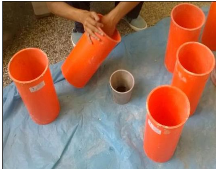
Figura 2.4 – Humedecido de los moldes FUENTE: Elaboración propia
