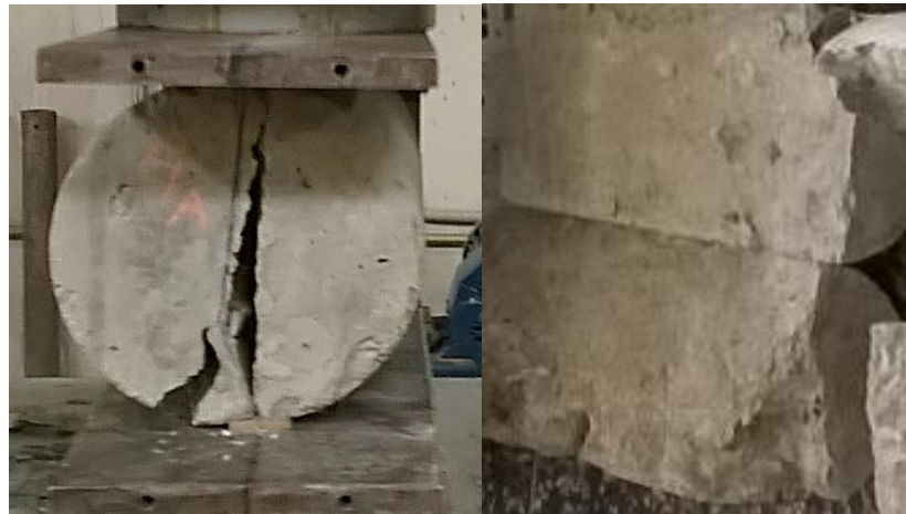
Figura 2.44 – Probeta MESA28-4 ensayada a resistencia de tracción por compresión diametral a 28 días FUENTE: Elaboración propia
