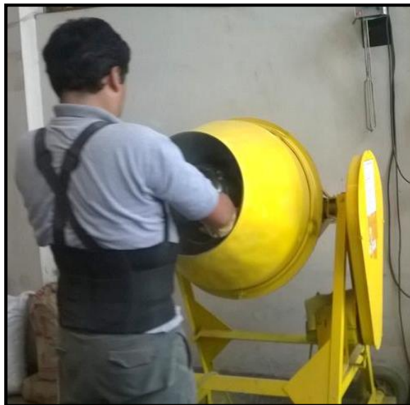
Figura 2.13 – Preparación de mezcla de concreto para probetas experimentales
