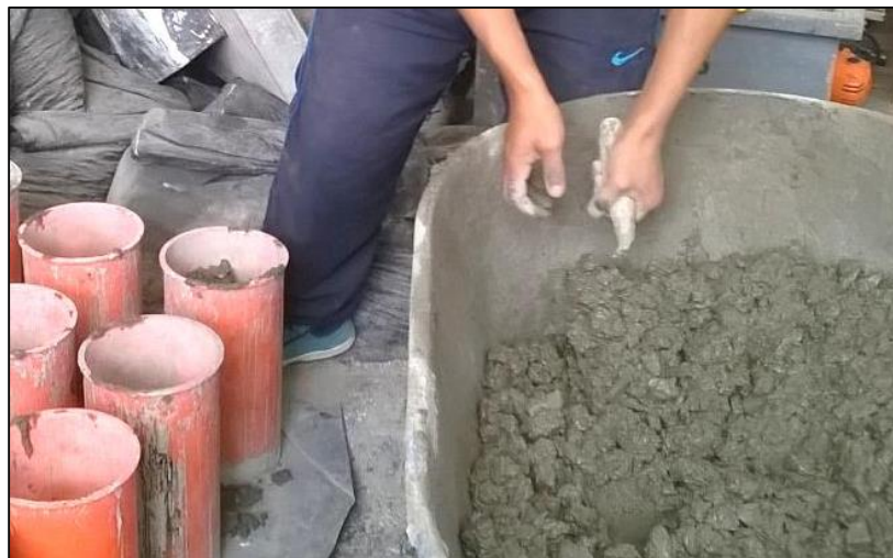
Figura 2.9 – Vaciado de probetas monolíticas
