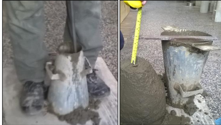
Figura 2.8 – Cálculo de asentamiento de la mezcla del concreto
