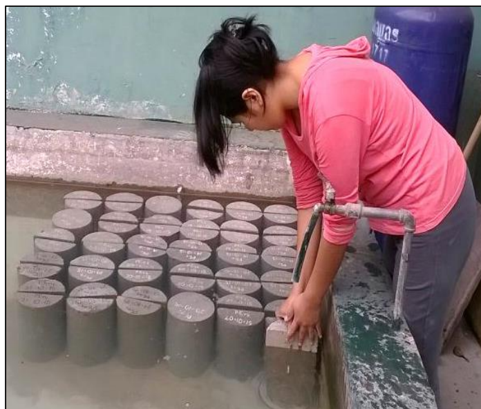
Figura 2.17 – Colocado de mitades - probetas experimentales en piscina de curado FUENTE: Elaboración propia
