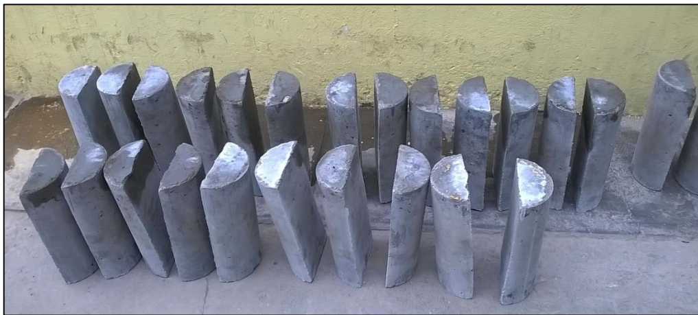
Figura 2.18 – Secado de mitades de probetas experimentales FUENTE: Elaboración propia
