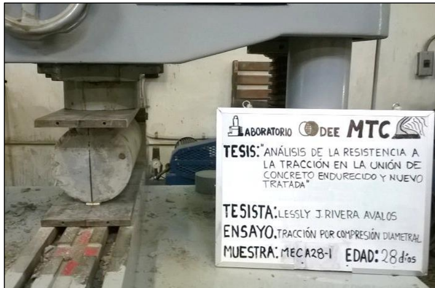
Figura 2.35 – Ensayo de resistencia a tracción de unión con adhesivo (antes) FUENTE: Elaboración propia
