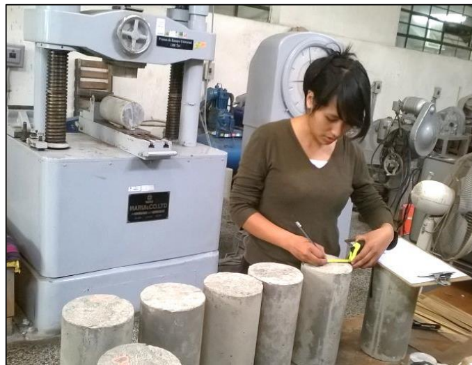
Figura 2.29 – Trazado de líneas de contacto de probetas control y experimentales FUENTE: Elaboración propia
