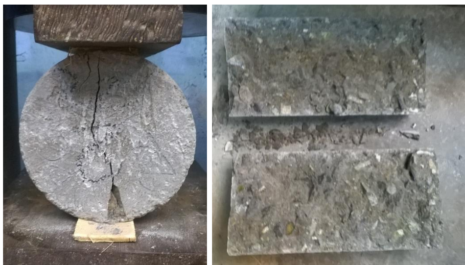
Figura 2.40 – Probeta MCT22-7 ensayada a resistencia de tracción por compresión diametral a 7 días
