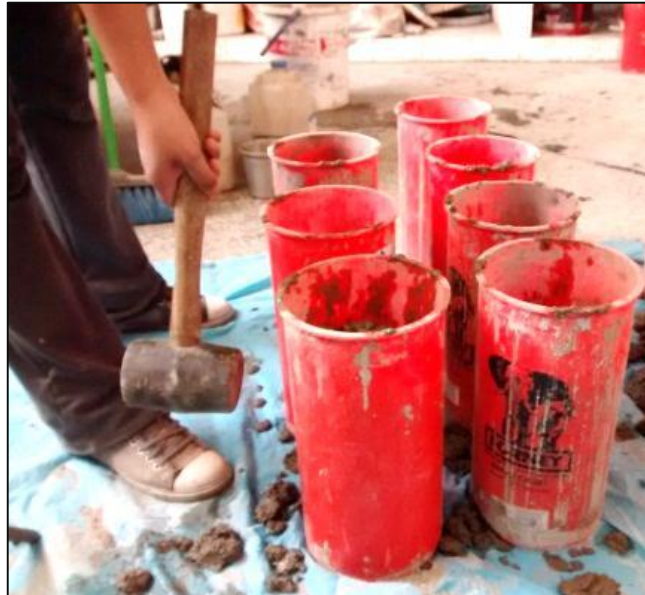
Figura 2.10 – Golpeado a lados de los moldes para liberar las burbujas de aire
