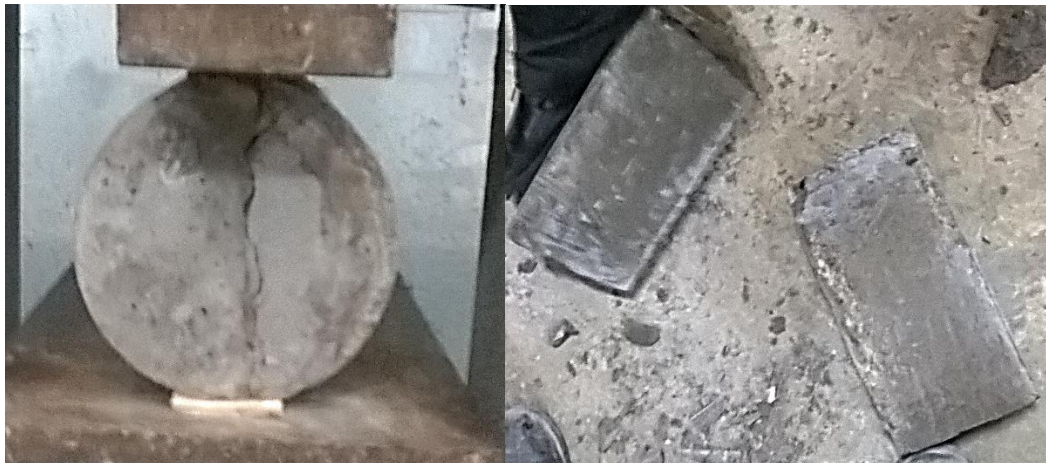
Figura 2.37 –Probeta MECA28-1 ensayada a resistencia de tracción por compresión diametral a 7 días
