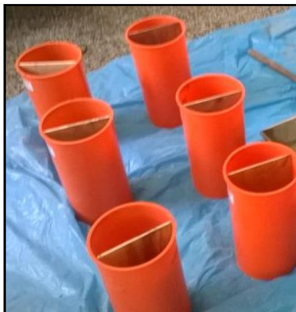
Figura 2.12 – Colocado de divisiones
