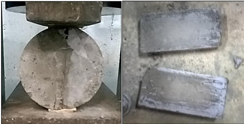
Figura 2.38 – Probeta MECA28-4 ensayada a resistencia de tracción por compresión diametral a 7 días FUENTE: Elaboración propia
