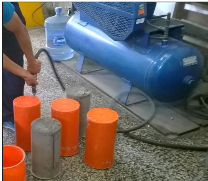
Figura 2.16 – Desencofrado de mitades de las probetas experimentales FUENTE: Elaboración propia
