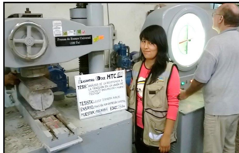
Figura 2.33 – Ensayo de resistencia a tracción por compresión diametral FUENTE: Elaboración propia
