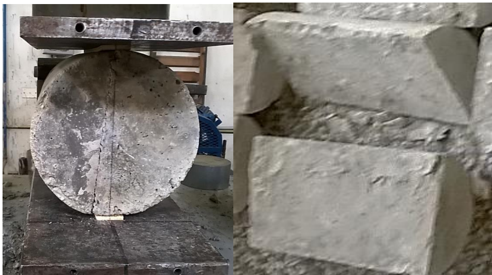
Figura 2.43 – Probeta MESA28-1 ensayada a resistencia de tracción por compresión diametral a 28 días
