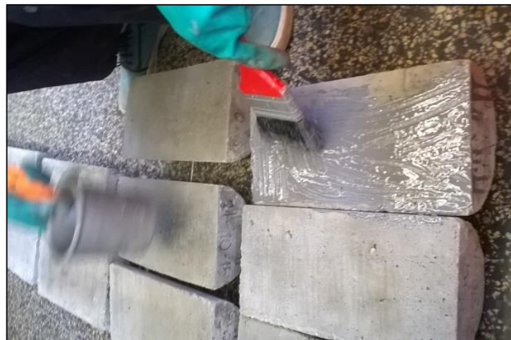
Figura 2.20 – Tratamiento con adhesivo epóxico de probetas experimentales FUENTE: Elaboración propia
