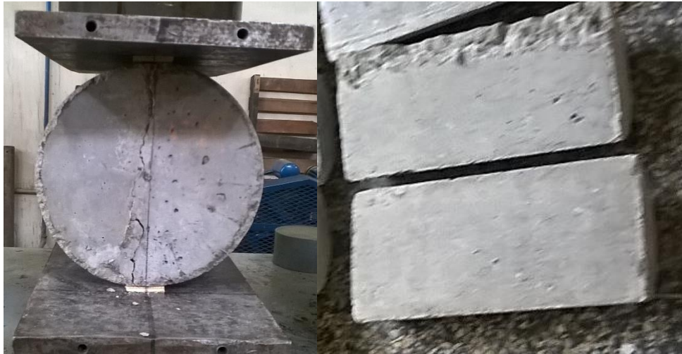
Figura 2.42 – Probeta MESA27-3 ensayada a resistencia de tracción por compresión diametral a 28 días
