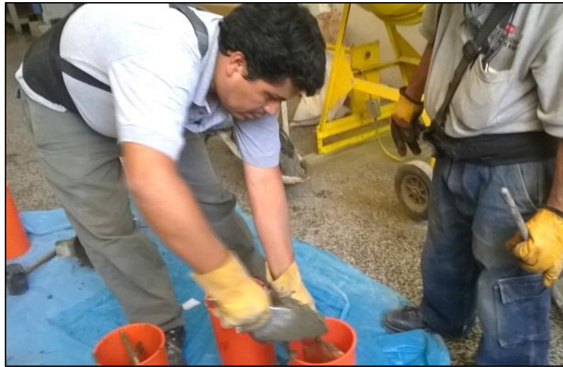
Figura 2.14 – Vaciado del concreto de probetas experimentales FUENTE: Elaboración propia
