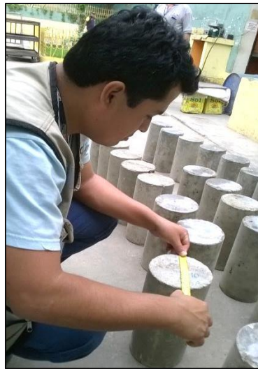
Figura 2.28 – Mediciones de las probetas control y experimentales FUENTE: Elaboración propia
