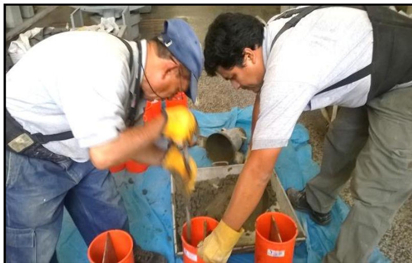
Figura 2.15 – Varillado del concreto de probetas experimentales FUENTE: Elaboración propia
