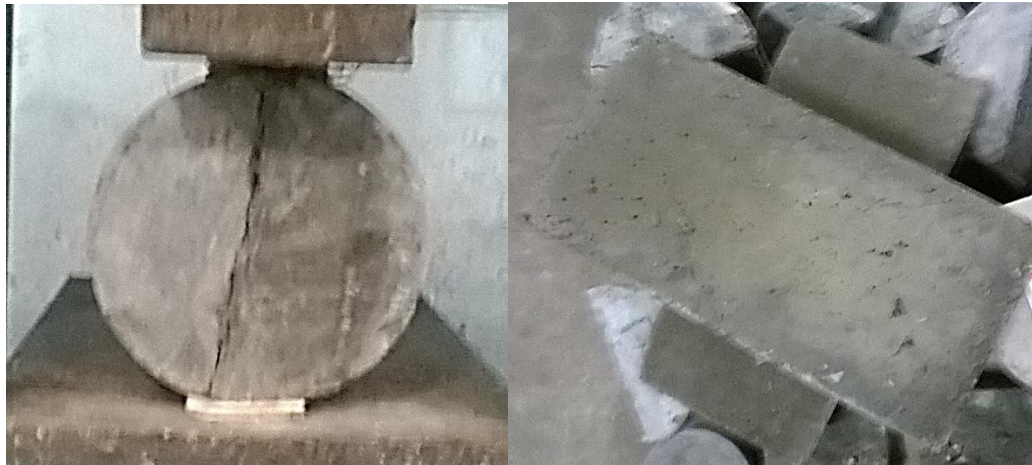
Figura 2.39 – Probeta MESA28-1 ensayada a resistencia de tracción por compresión diametral a 7 días
