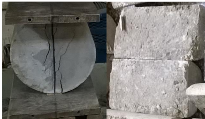
Figura 2.45 – Probeta MESA28-5 ensayada a resistencia de tracción por compresión diametral a 28 días FUENTE: Elaboración propia
