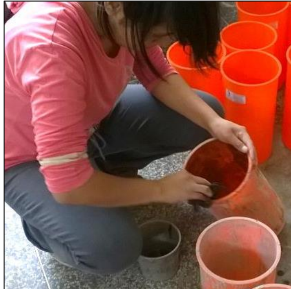
Figura 2.11 – Humedecido de los moldes
