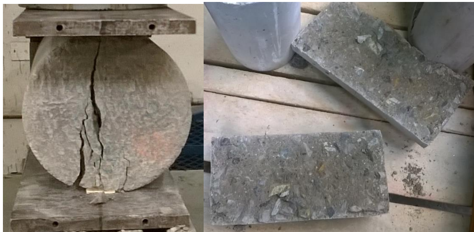
Figura 2.47 – Probeta MCT21-6 ensayada a resistencia de tracción por compresión diametral a 28 días FUENTE: Elaboración propia
