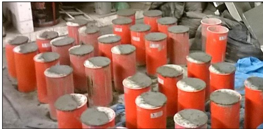
Figura 2.25 – Probetas unidas con y sin adhesivo epóxico.
