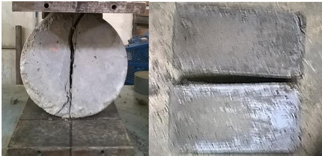
Figura 2.41 – Probeta MECA27-6 ensayada a resistencia de tracción por compresión diametral a 28 días FUENTE: Elaboración propia
