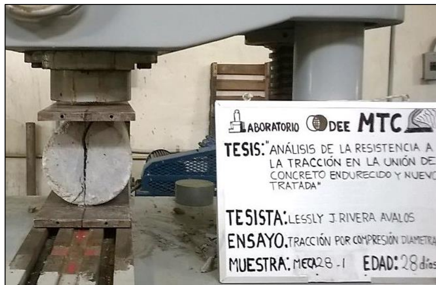
Figura 2.36 – Ensayo de resistencia a tracción de unión con adhesivo (después) FUENTE: Elaboración propia
