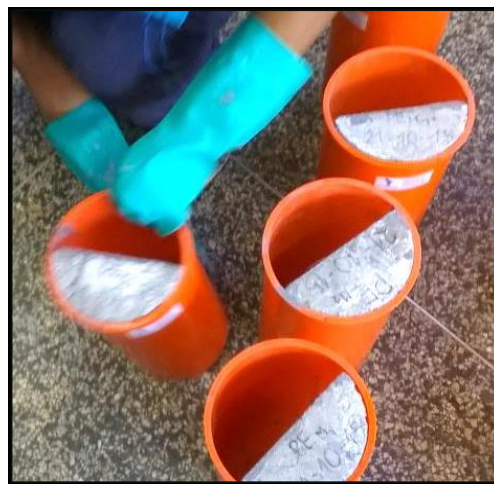
Figura 2.24 –Colocado de mitades en los moldes FUENTE: Elaboración propia
