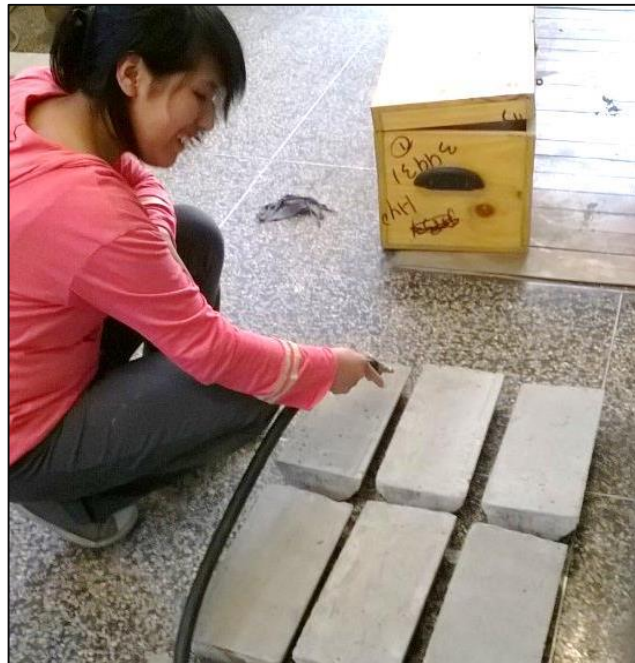
Figura 2.22 – Limpieza de superficie de contacto con aire comprimido FUENTE: Elaboración propia
