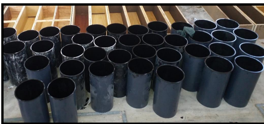
Fig. 9: Moldes cilíndricos de plástico
