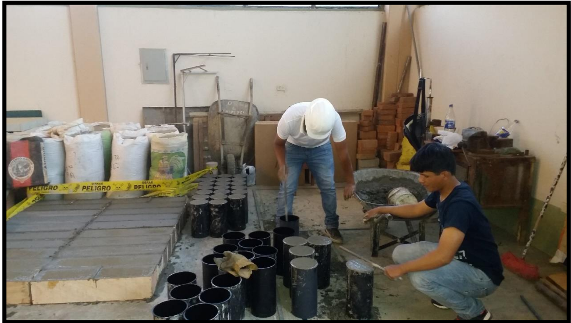
Fig. 11: Llenado de concreto en las probetas de plástico
