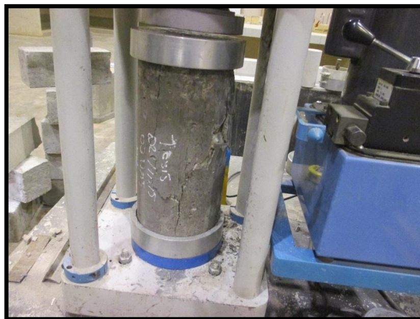
Fig. 13: Refrentado de cilindros de concreto (mortero de azufre y almohadillas de neopreno).
