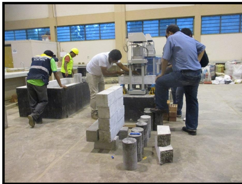
Fig. 34: En la vista se muestra ya el inicio de los ensayos en vigas y testigos cilíndricos; también se pidió al asesor su presencia para las recomendaciones respectivas.
