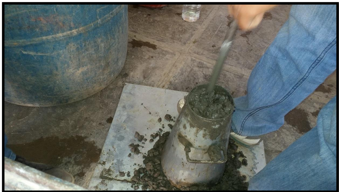
Fig. 29: En la vista se muestra la prueba del slump del concreto el cual se verifica y realiza con el cono de abrhans
