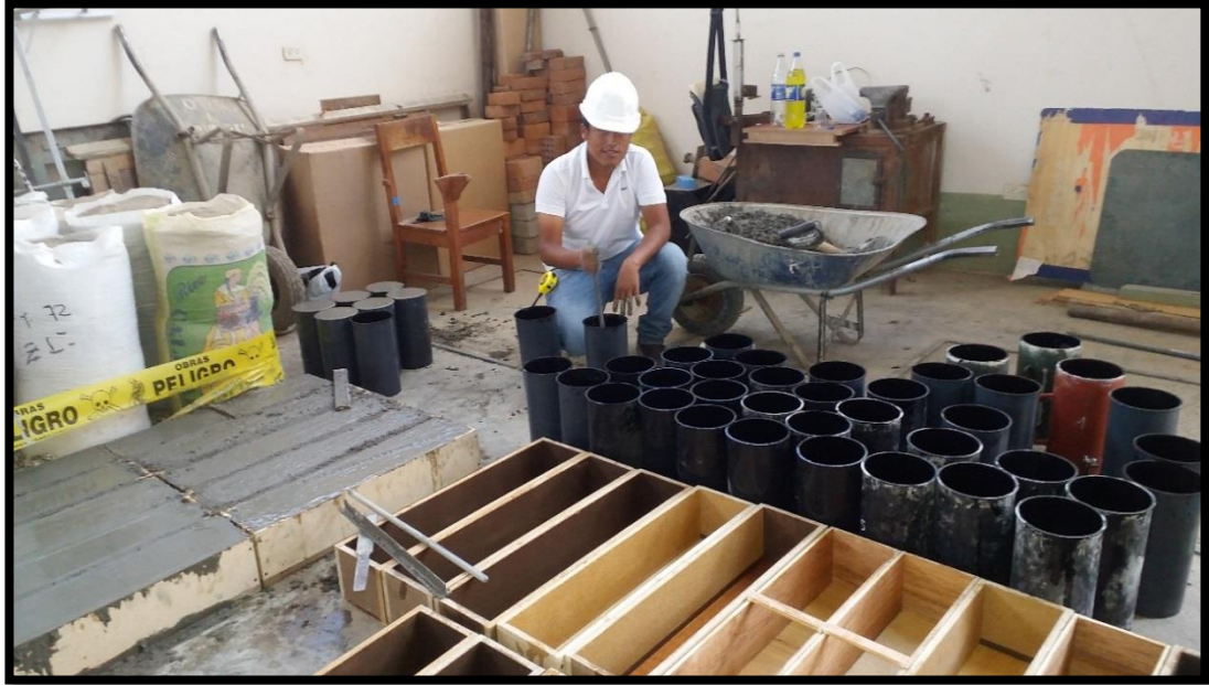
Fig. 32: En la vista se muestra el colocado del concreto en las vigas y colocado del concreto en las probetas
