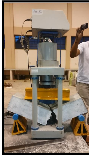
Fig. 49: Se observa la rotura de vigas cuando es sometido a carga; el cual se produce en el tercio central por la que el módulo de rotura se calculara de la siguiente manera
