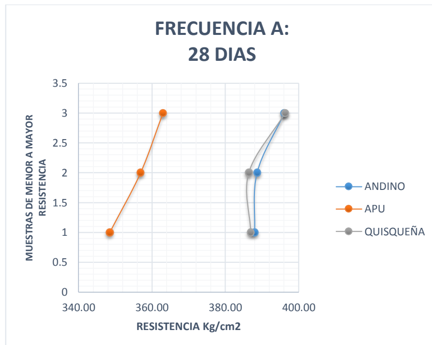
Fig. 41: Curva de la Evolución de la Resistencia a Compresión (28 días)
