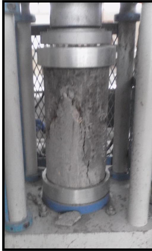
Fig. 14: Ensayo de Resistencia a la Compresión del Concreto.
