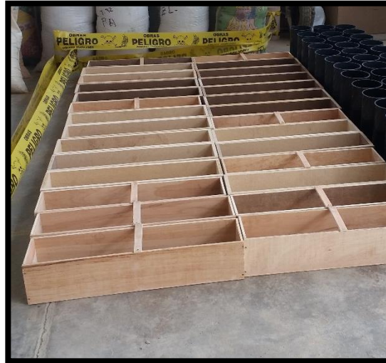
Fig. 15: Moldes de madera para el ensayo a flexión
