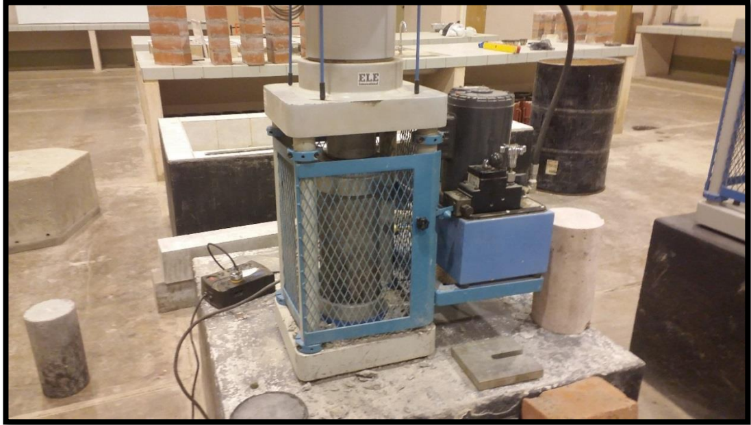
Fig. 36: En la vista se muestra ya el inicio de ensayo en los testigos cilíndricos
