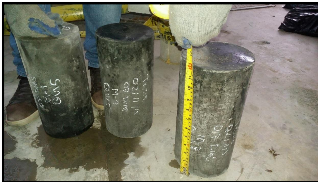
Fig. 35: En la vista se muestra ya todas las vigas y probetas ya vaciados en toda su totalidad
