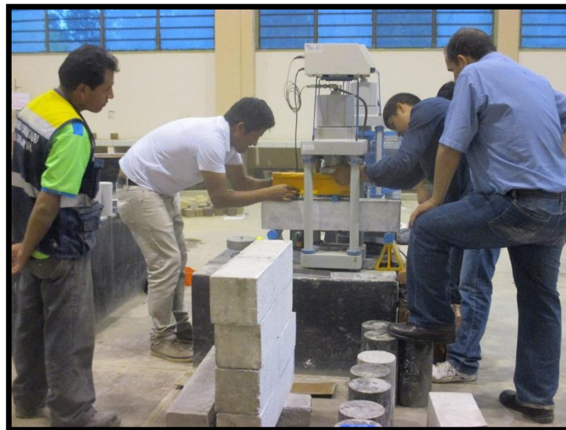
Fig. 48: Colocamos las vigas prismáticos en la máquina para realizar el ensayo respectivo.
