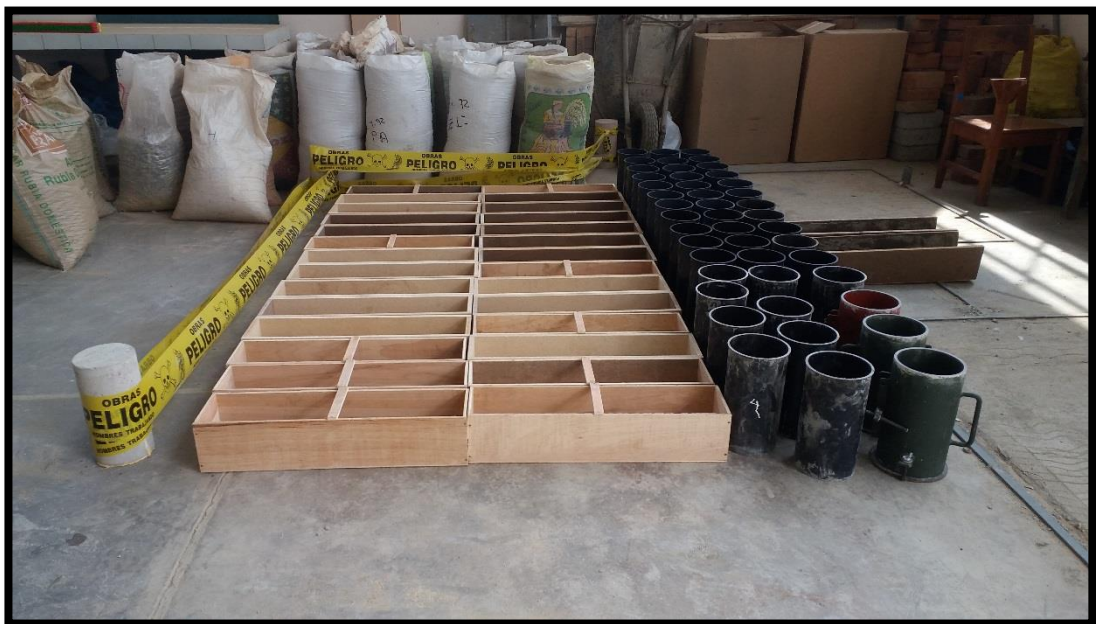
Fig. 25: En la vista se muestra los moldes de las vigas y de las probetas en la cuales se realizará el vaciado de concreto; se aprecia un total de 30 moldes para las vigas y un total de 45 moldes para las probetas cilíndricas
