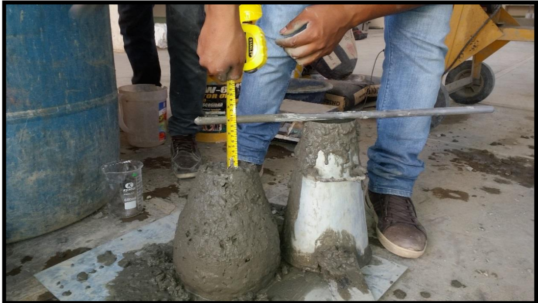
Fig. 31: En la vista se verifica el slump que se asumió en el diseño de mezclas en este caso nos muestra 4"
