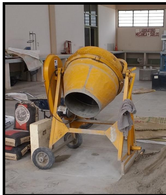
Fig. 8: MEZCLADORA DE CONCRETO
