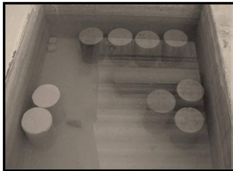
Fig. 12: Almacenamiento del concreto bajo agua
