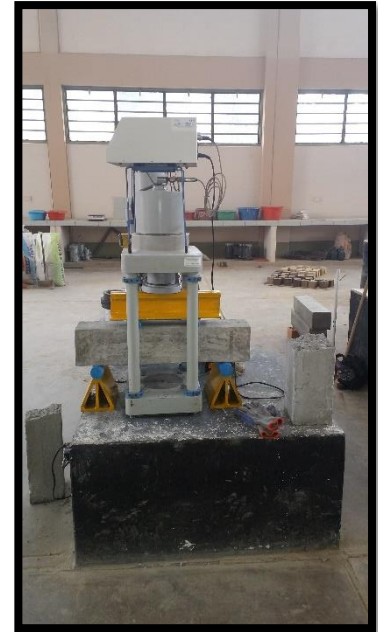
Fig. 47: Ensayo a Flexión. Fuente: Elaboración Propia
