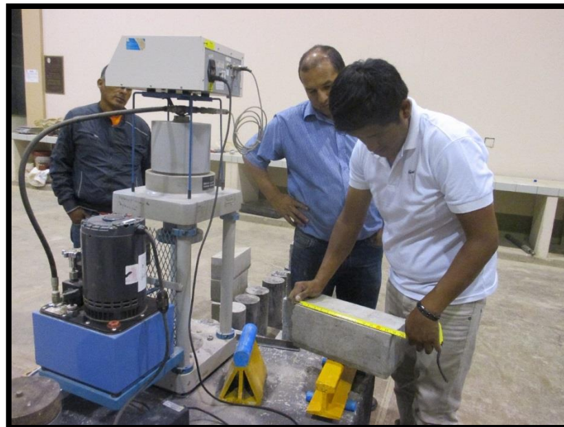
Fig. 50: se verifica si la falla fue en el tercio central
