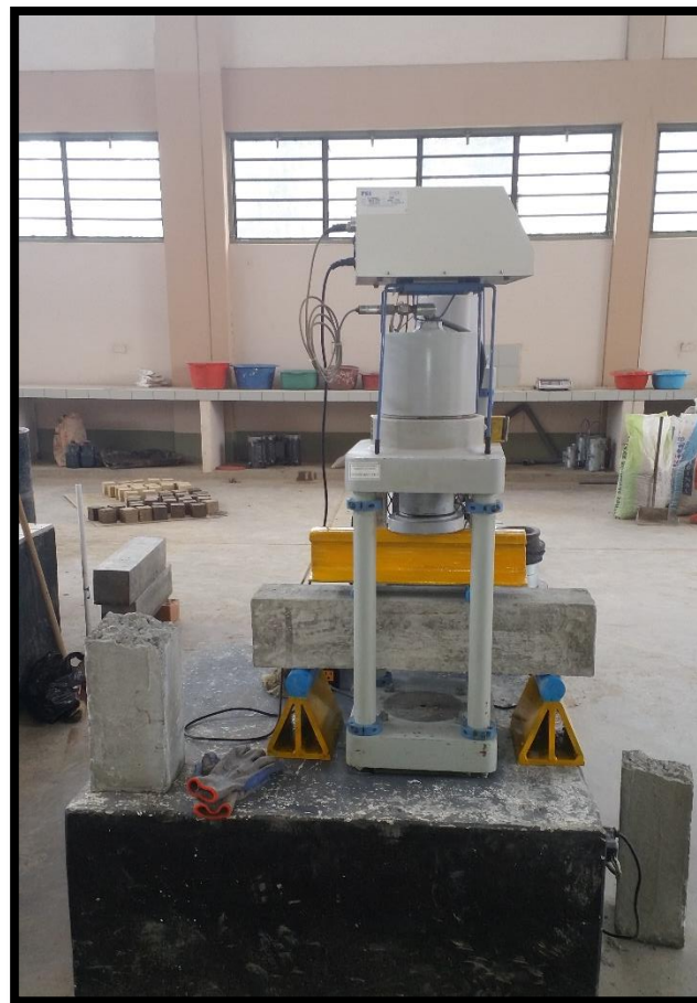
Fig. 17: Ensayo de Resistencia a la flexión. Fuente: Elaboración Propia
