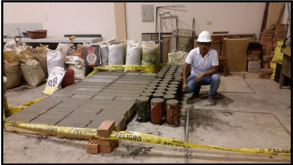
Fig. 32: En la vista se muestra el colocado del concreto en las vigas y colocado del concreto en las probetas
