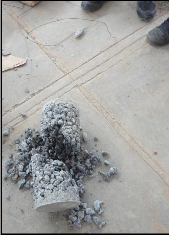
Fotografía N° 13: Se muestra que la mayoría de los testigos tuvieron una falla por cortante, y algunos tuvieron una falla en la base de las probetas.
