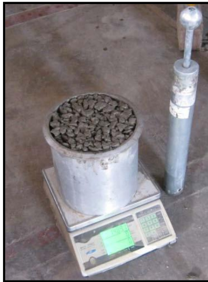
Figura N° 2: Ensayo peso unitario (Olla de Washington-Próctor estándar)
