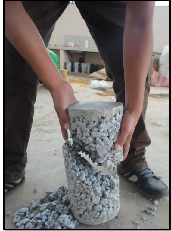
Fotografía N° 13: Se muestra que la mayoría de los testigos tuvieron una falla por cortante, y algunos tuvieron una falla en la base de las probetas.
