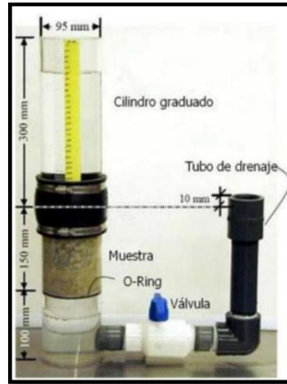
Figura N° 4: Equipos de ensayo de permeabilidad
