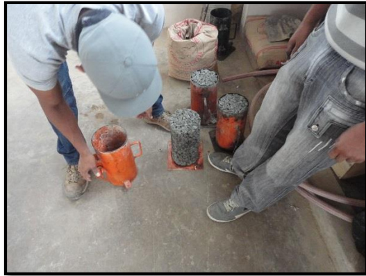
Fotografía N° 8: Se puede observar que el revenimiento es cero.
