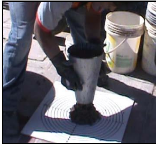
Figura N° 3: Ensayo del cono invertido (Cono de Abrams)
