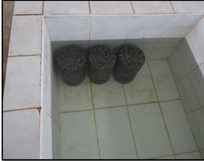
Fotografía N° 9 Las probetas se desmoldaron 24 horas después e inmediatamente colocadas en la poza de curación.
