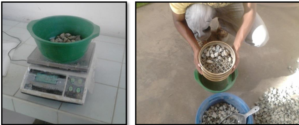
Fotografía N° 2: peso y zarandeo de la muestra cuarteada.
