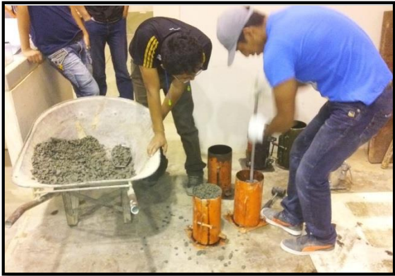
Fotografía N° 8: Se puede observar que el revenimiento es cero.
