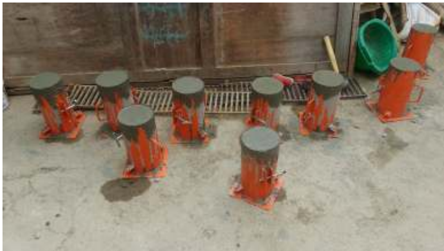
Fotografía N°04: Mezcla compactada en las probetas de ensayo a compresión.
