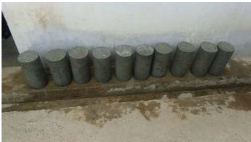
Fotografía N°05: Concreto sacado de la probeta de ensayo listo para ser curado.
