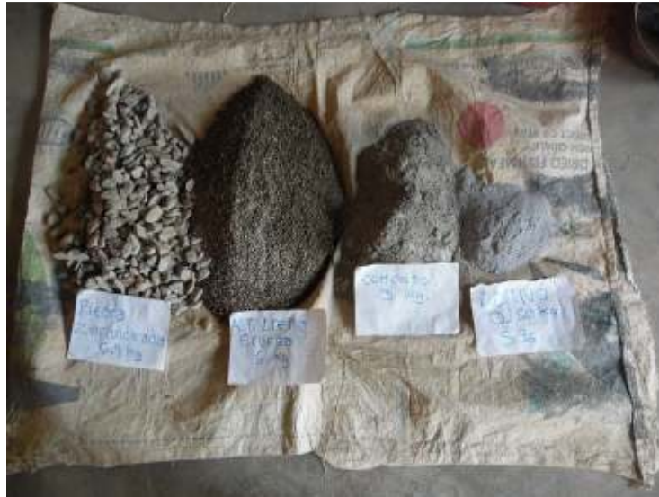
Fotografía N°03: agregados zarandeados listo para el ensayo, dosificados óptimamente.
