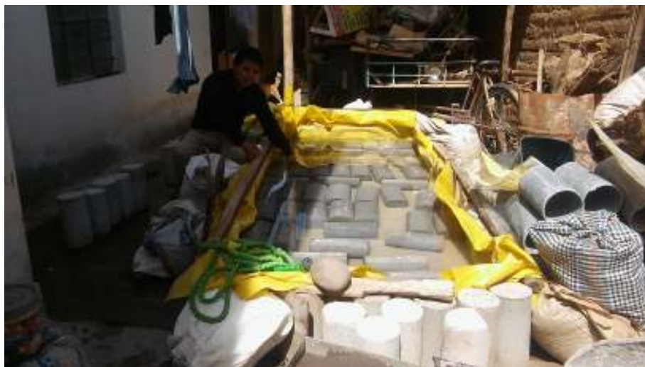
Fotografía N°06: Curado de los concretos en cada dosificación, en un periodo de 7, 14 y 28 días.
