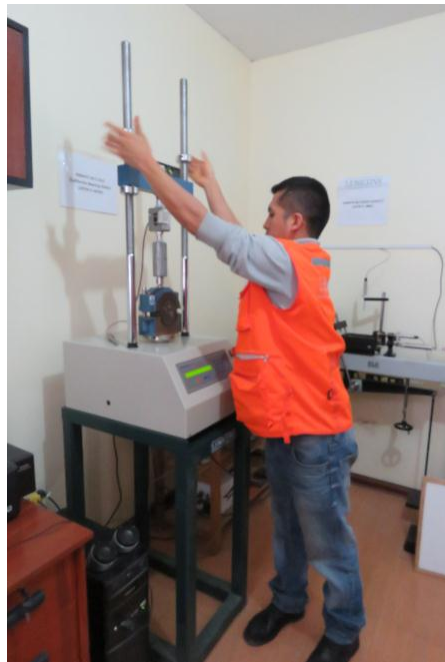
Gráfico 32-D. trabajador realizando el ensayo CBR
