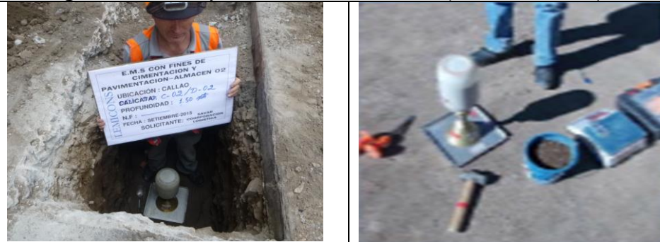
Fotografía 3: Ensayo de densidad natural (cono de arena).
