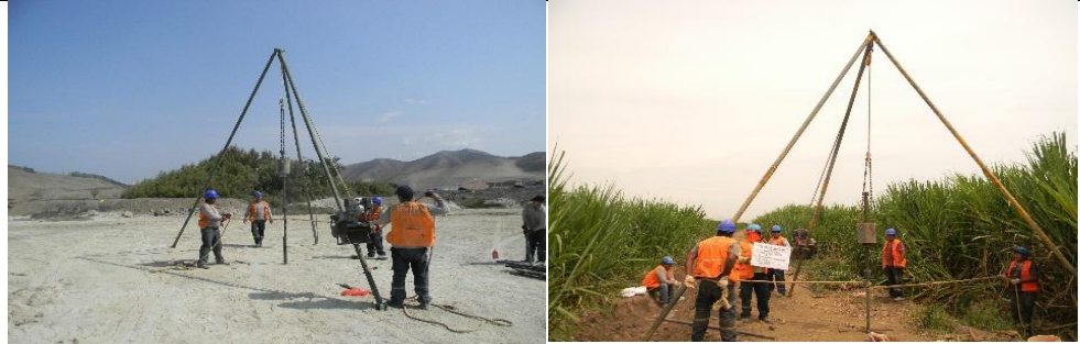
Fotografía 1: Sondajes a profundidad (SPT)
