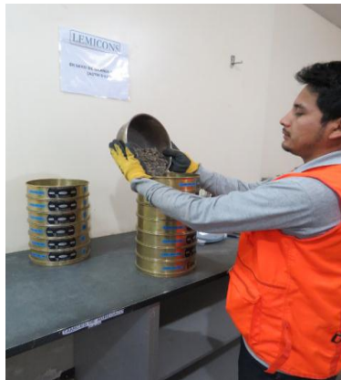
Gráfico 32-B. trabajador realizando el ensayo de Granulometría
