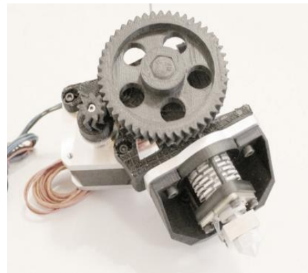
Figuras 44 y 45. Ensamblando del extrusor.
