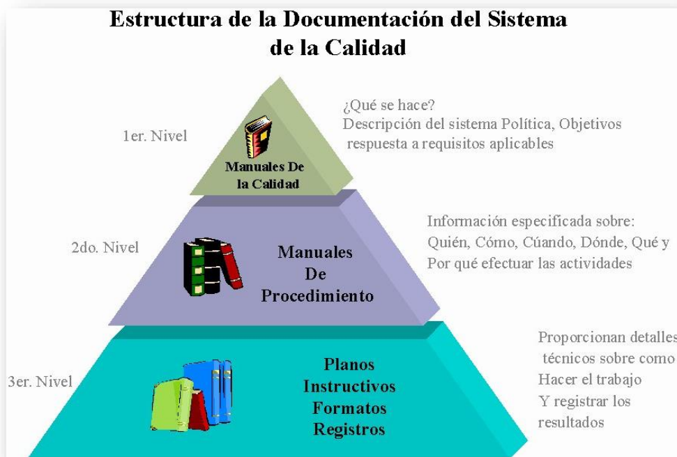
Gráfico N° 02: Estructura para la documentación de un sistema de gestión de la calidad, bajo la norma ISO 9001.
