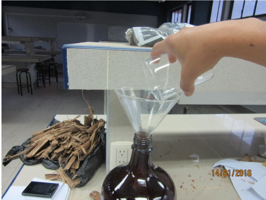
Figura 15: fotografía de la preparación del extracto etanólico de Cecropia sp. mediante el proceso de maceración.
