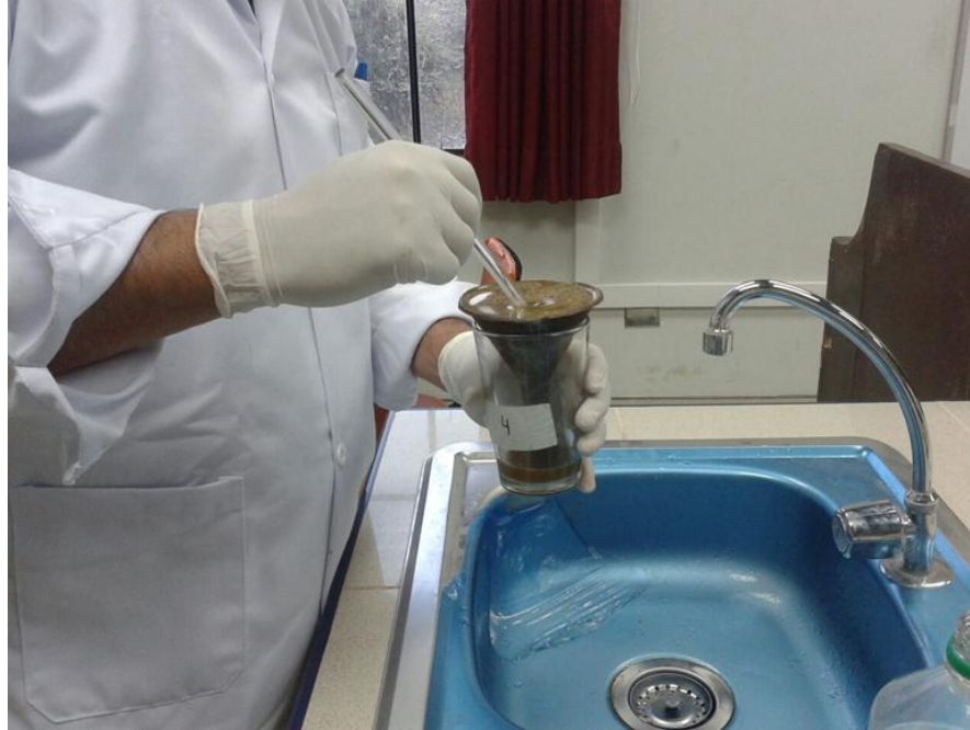
FOTO N° 8. FILTRADO DE LAS MUESTRAS CON LA FINALIDAD DE DESCARTAR MATERIAL GROSERO.
