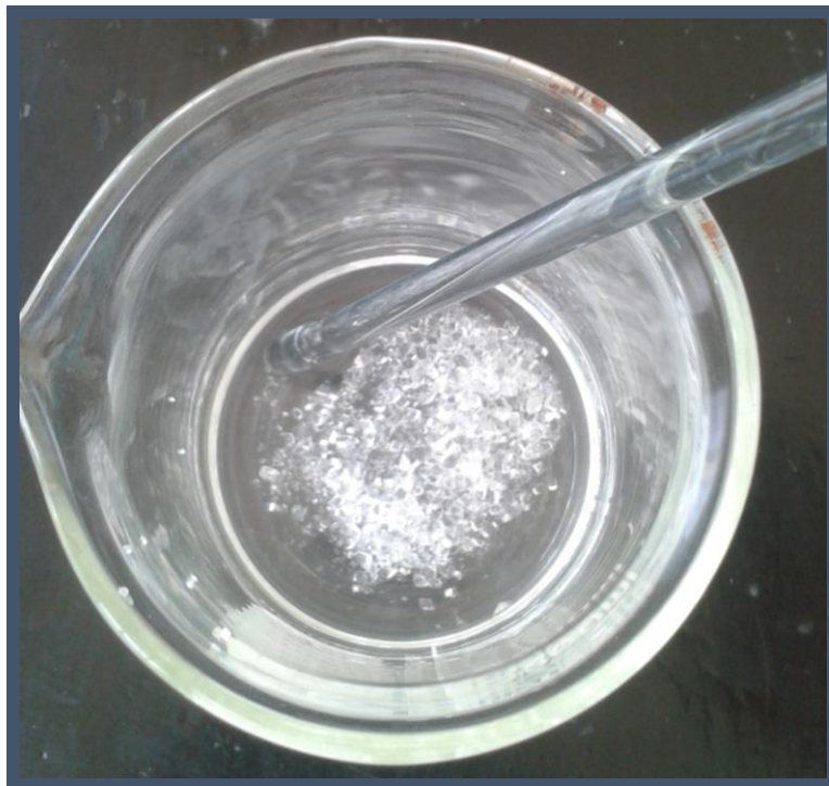
FIG. 17: Se pesa 4gr, de sacarina y se disuelve en 50 ml de agua deshionizada.
