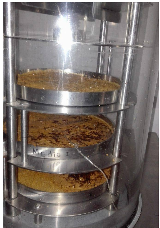
Foto N° 19 y 20. Proceso de liofilización de la muestra por 24 horas
