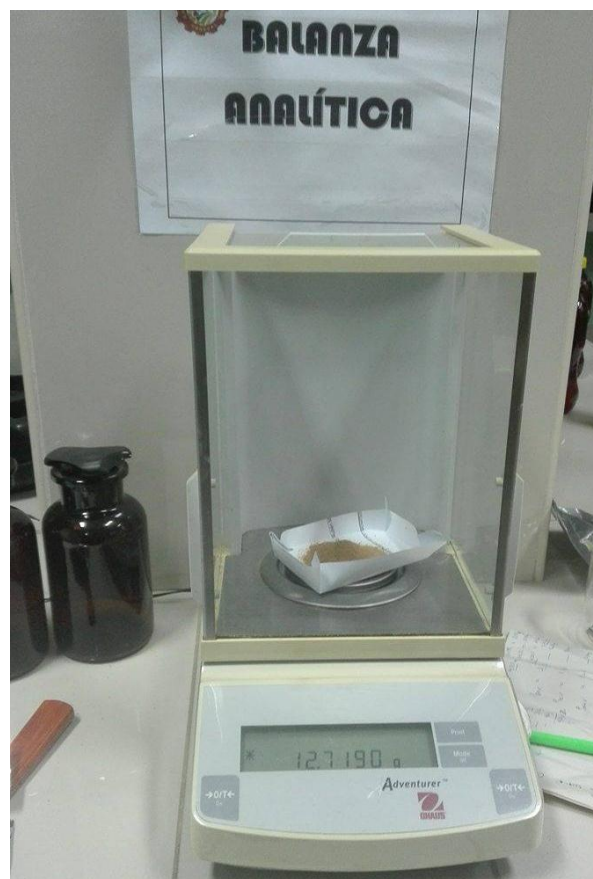
Foto N° 23. Pesado del extracto etanólico de C. spinosa para su posterior dilución.
