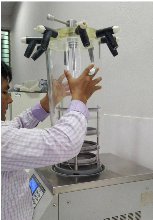
Foto N° 19 y 20. Proceso de liofilización de la muestra por 24 horas
