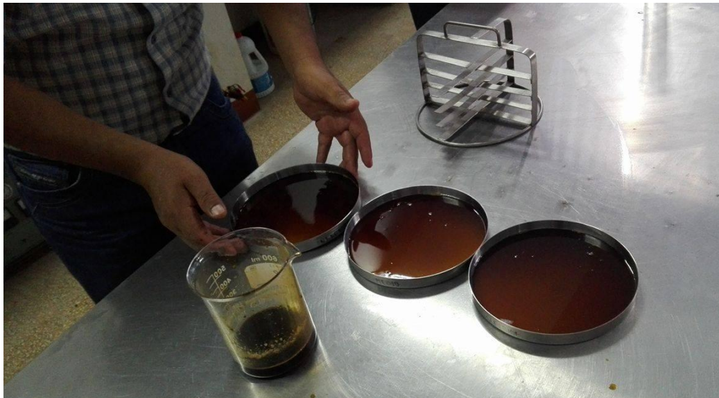
Foto N° 14. Acondicionamiento de la muestra de extracto de tara con la maltodextrina
