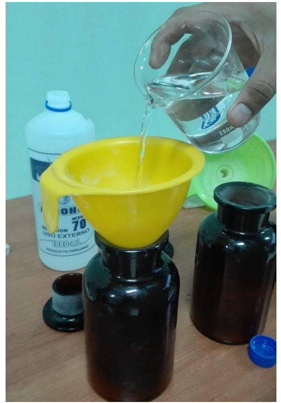
Foto N° 09 y 10. Mezclado de polvo de vaina de tara con el etanol
