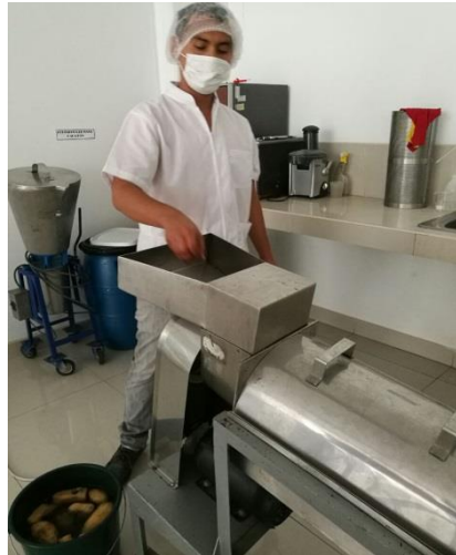
Fig. 2 Despulpado del yacón
