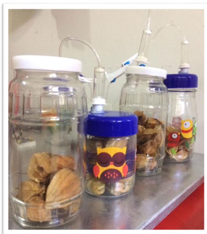
Fotografía 14: Aplicación del gas hidrógeno al aguaymanto.
