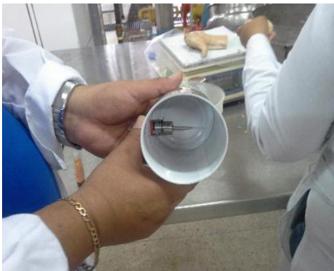
Acondicionamiento del sensor que medirá la penetración de calor.
