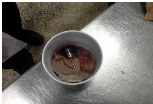
Colocación de la carne en la lata que medirá la penetración de calor.
