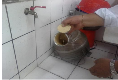
Recuperación del sensor de medida de penetración de calor
