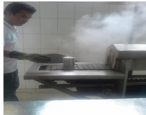
Latas colocadas en el exhauster para la eliminación de aire en los envases.
