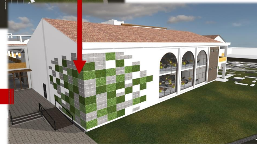
IMAGEN 27: Vista 3D de una esquina de la propuesta donde se utiliza el muro verde tipo damero.
