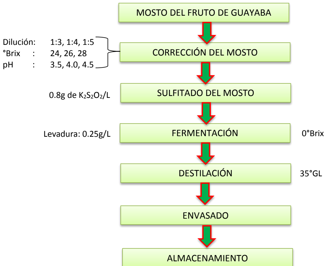
Ilustración 16: Diagrama de flujo para la obtención del aguardiente de guayaba.
