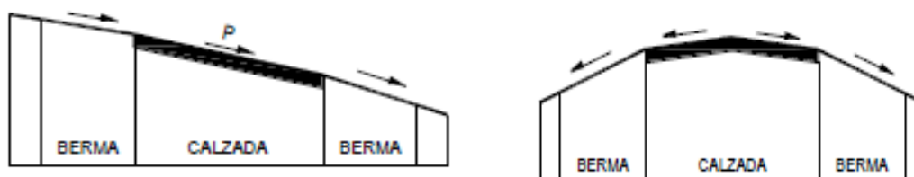
FIGURA 1.10. Inclinación de Bermas en calzada.
