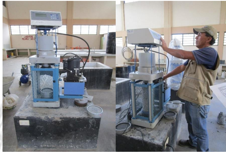
Fotografía N° 11 Ensayo de resistencia a la compresión del concreto poroso
