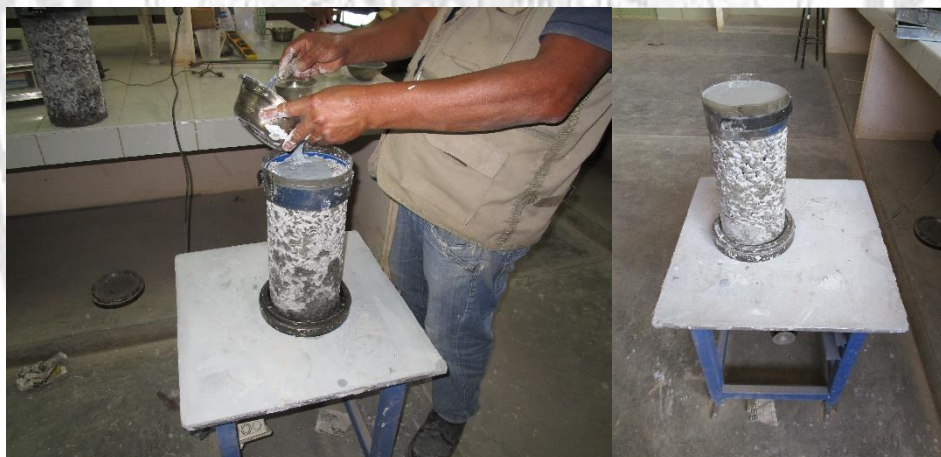
Fotografía N° 8 Capping de probetas de concreto poroso.
