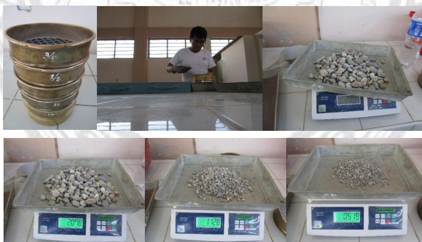
Fotografía N° 4 Ensayo de granulometría.
