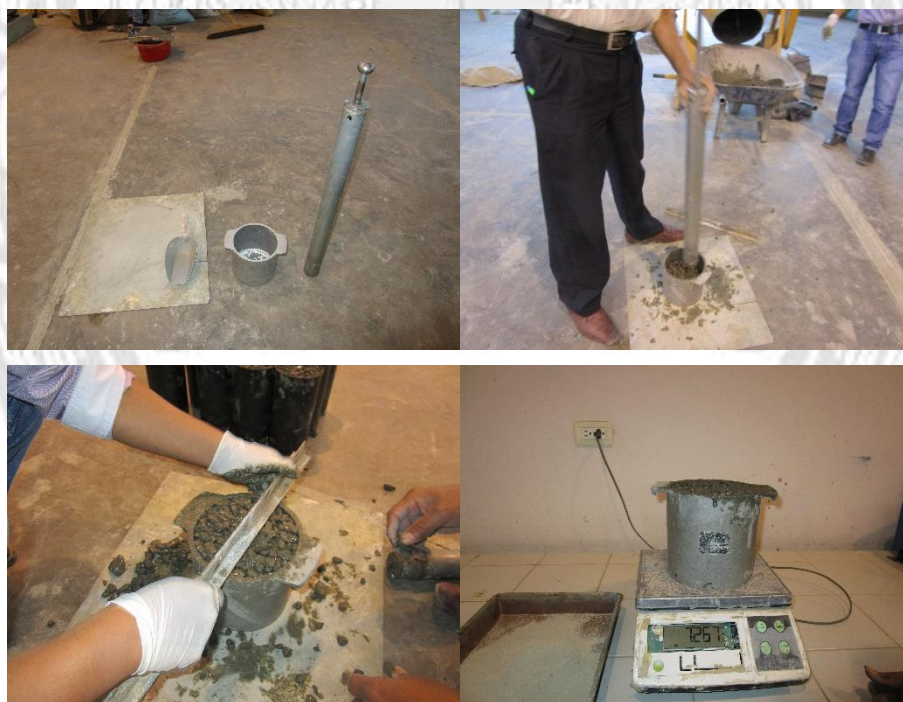
Fotografía N° 9 Ensayo de peso unitario y contenido de aire del concreto poroso.
