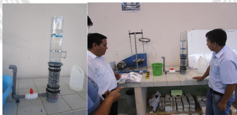
Fotografía N° 12 Ensayo de permeabilidad del concreto poroso.
