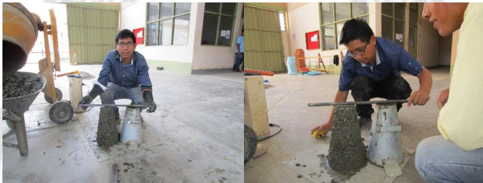
Fotografía N° 10 Ensayo de asentamiento del concreto poroso (Slump).
