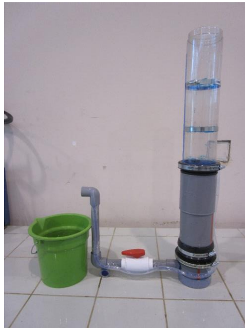
Figura N° 2 Permeámetro Construido de Carga Variable (Basado en ACI 522R-10).
