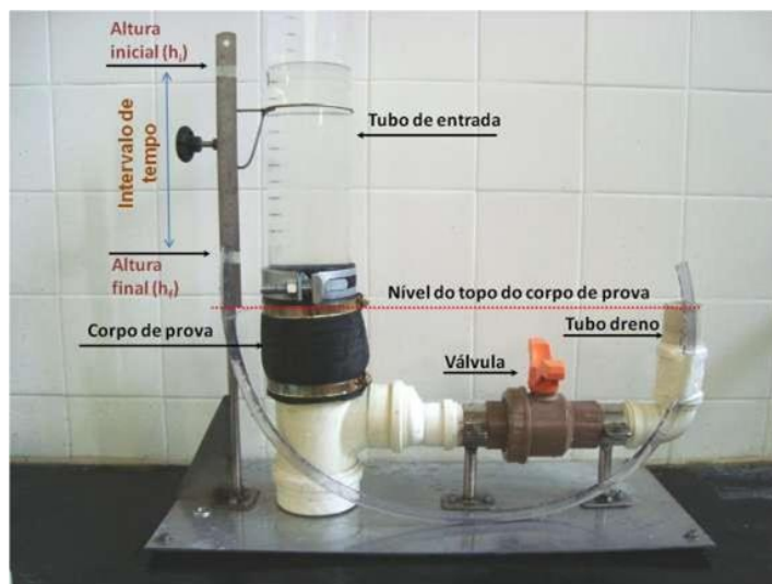
Figura N° 1 Características de Permeámetro de Carga Variable.
