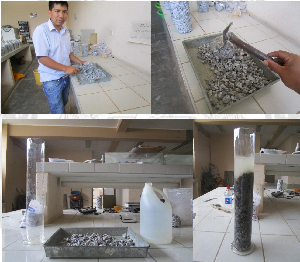
Fotografía N° 13 Ensayo de contenido de vacíos.
