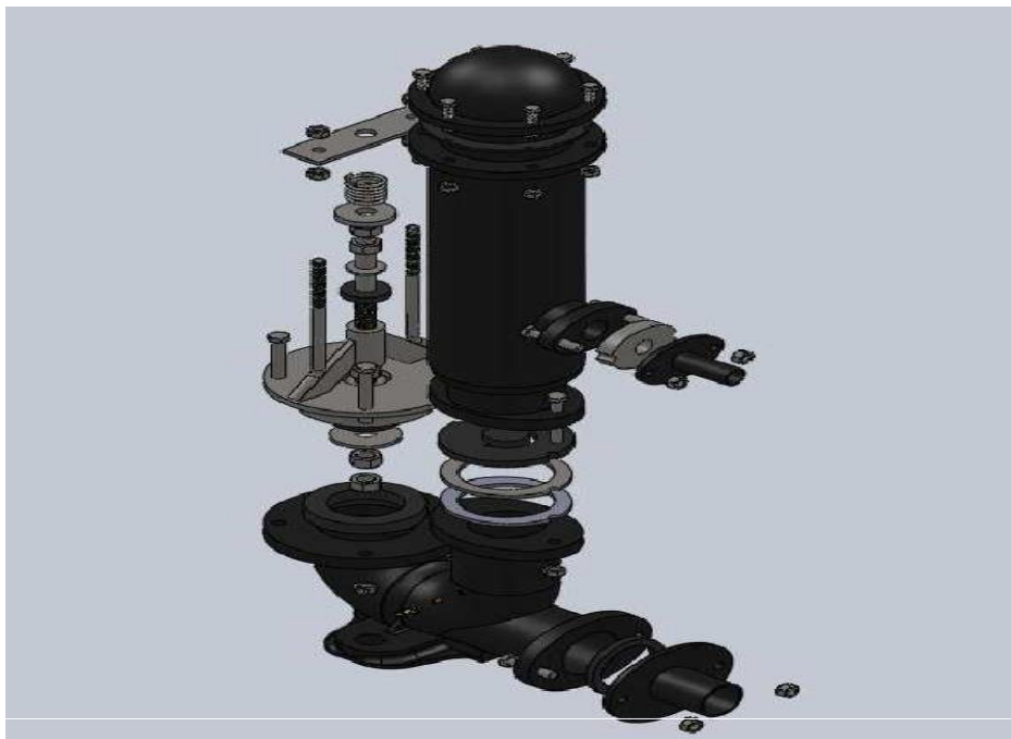
Figura 36. Explotado de la bomba de ariete hidráulico
