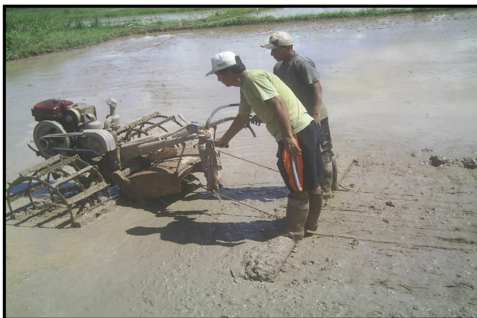
Figura 37. Trabajo de nivelación con la mula mecánica en la posa de almácigo
