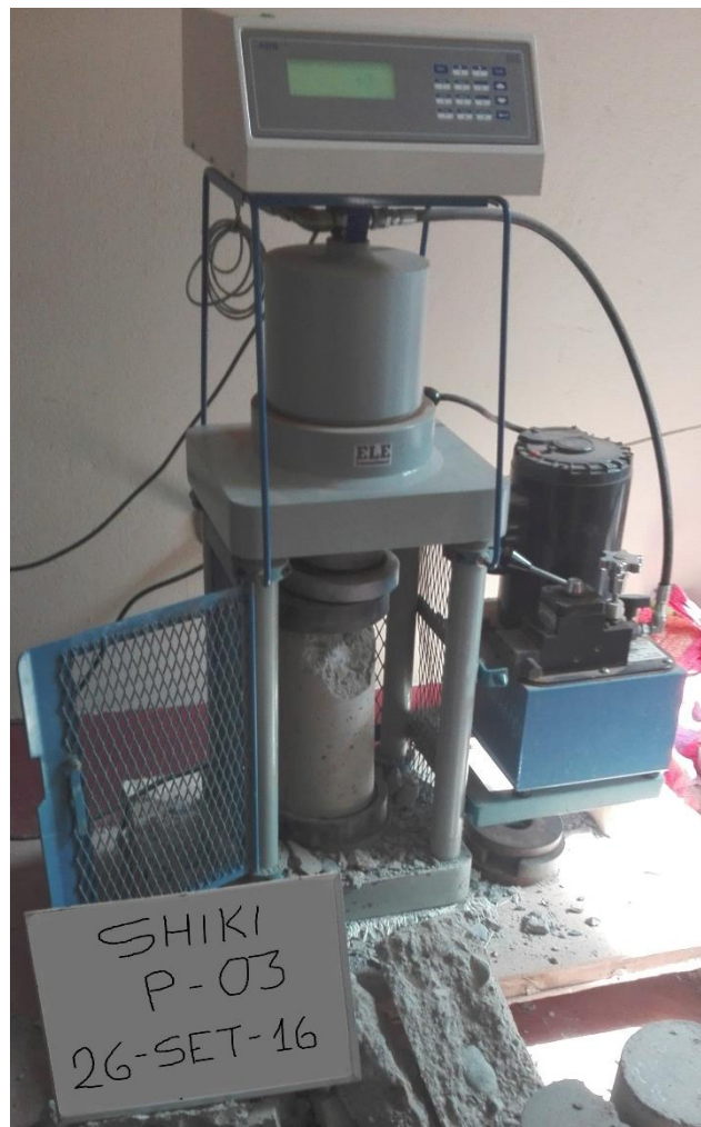
Fig. N° 6: Ensayo de Resistencia a la Compresión.
