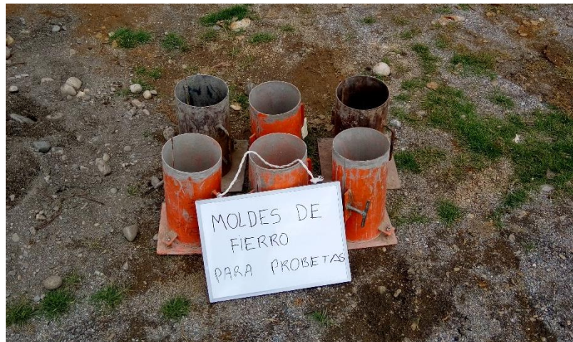
Fig. N° 2: Moldes Metálicos utilizados
