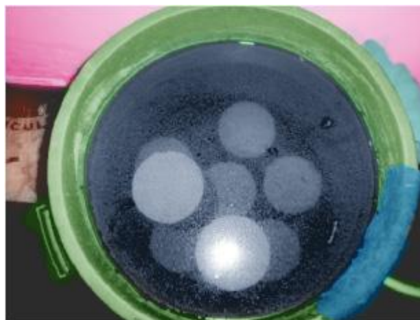
Fig. N° 22: Curado de Probetas Cilíndricas.
