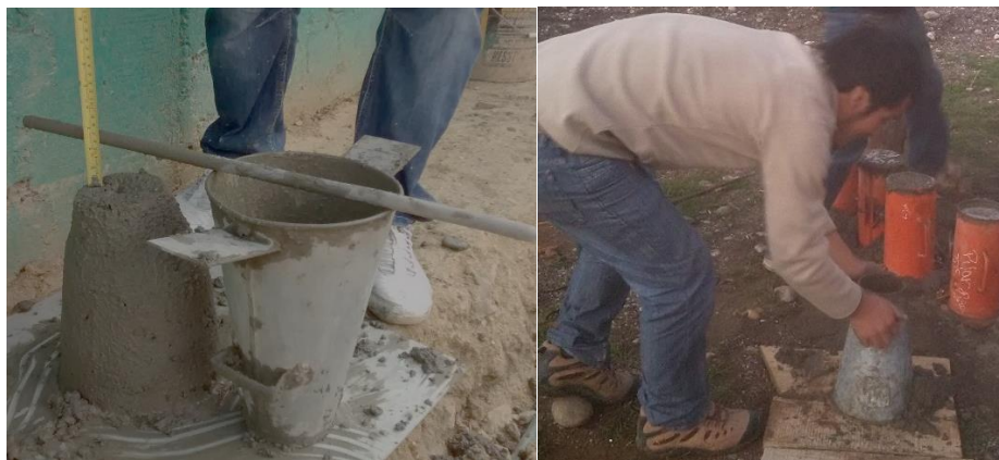
Fig. N° 20: Ensayo de Consistencia o Slump Mediante el Cono de Abrams.
