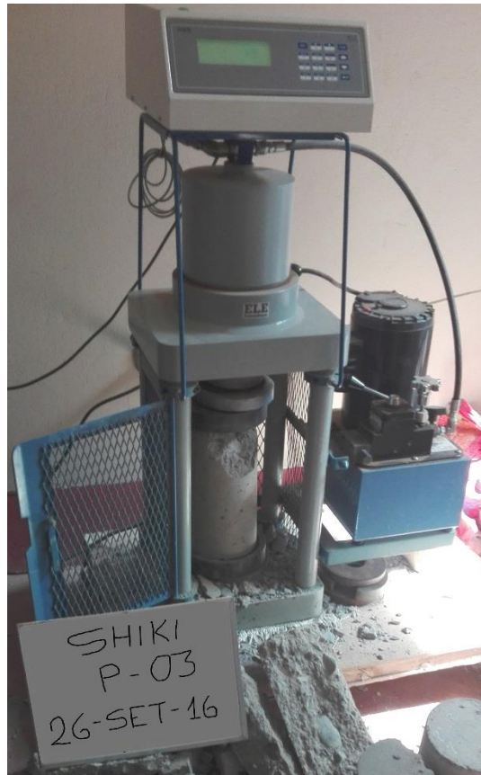
Fig. N° 23: Ensayos de la Resistencia a la Compresión.
