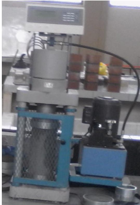
Fig. N° 12: Prensa Para Ensayo de Resistencia a la Compresión ASTM.
