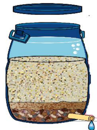
Purificador de agua casero
