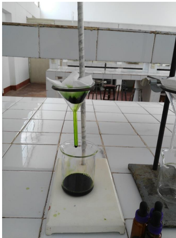
Vista 10. La mezcla es filtrada tres veces para luego ser envasada en recipientes ámbar pequeños y ser enviados al Laboratorio de Etnobotánica de la Universidad Privada Ricardo Palma para la preparación de los extractos etanólicos a concentraciones usadas en el estudio 25%, 50% y 75%
