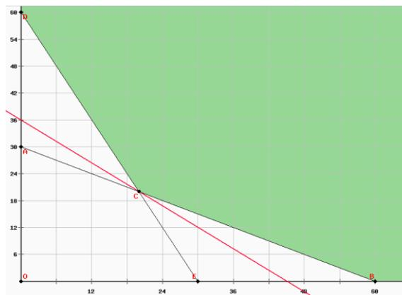
Figura 18. Solución gráfica del ejemplo 2, proceso de minimización con el PHPSimplex.
