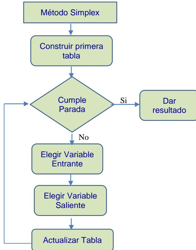
Figura 13. Diagrama de flujo para el proceso ejecución del método Simplex.
