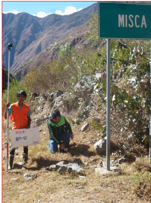
En la Vista Fotográfica se aprecia el BM-02, Instalado en las coordenadas ESTE=350338.2207 NORTE=8857068.8119 COTA=2573.4717 m.s.n.m
