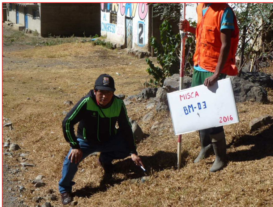
En la Vista Fotográfica se aprecia el BM-03, Instalado en las coordenadas ESTE=350462.0000 NORTE=8857047.0000 COTA=2562.7407 m.s.n.m.
