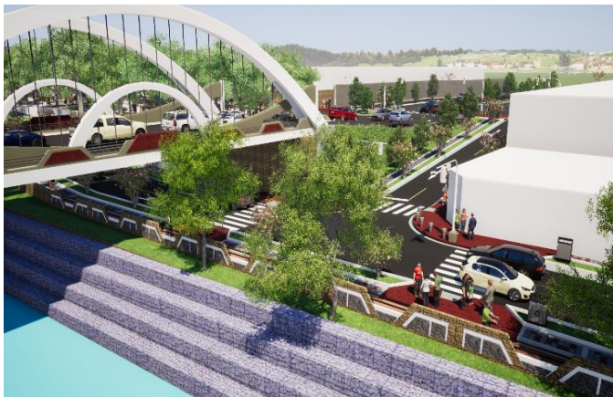
MURO DE GAVIONES
