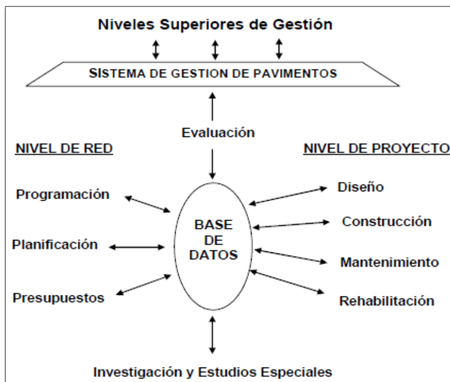
Gráfico N° 5: Principales Componentes de un Sistema de Gestión de Pavimentos Fuente: Haas, R. (1994). Modern Pavement Management.
