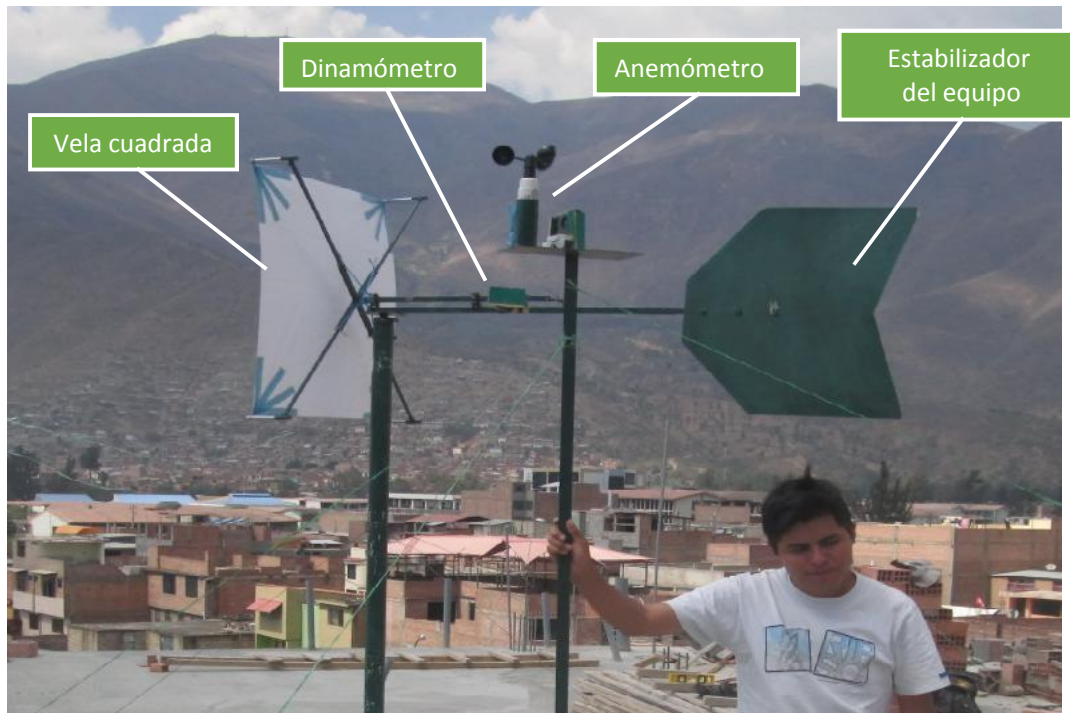
Figura 2.2: Equipo para la medición de la fuerza del viento. Fuente : Elaboración propia.
