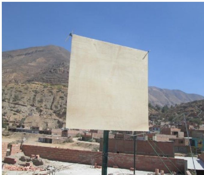
Figura 2.7: Placa plana de 100cmx100cm para prueba de validación de equipo.
