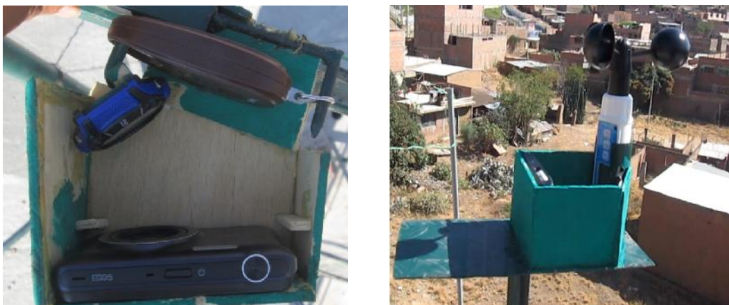
Figura 2.3: Disposición de equipos para su buen funcionamiento: (a) Equipo medidor de fuerza, (b) equipo medidor de velocidad del viento. Fuente: Elaboración propio
