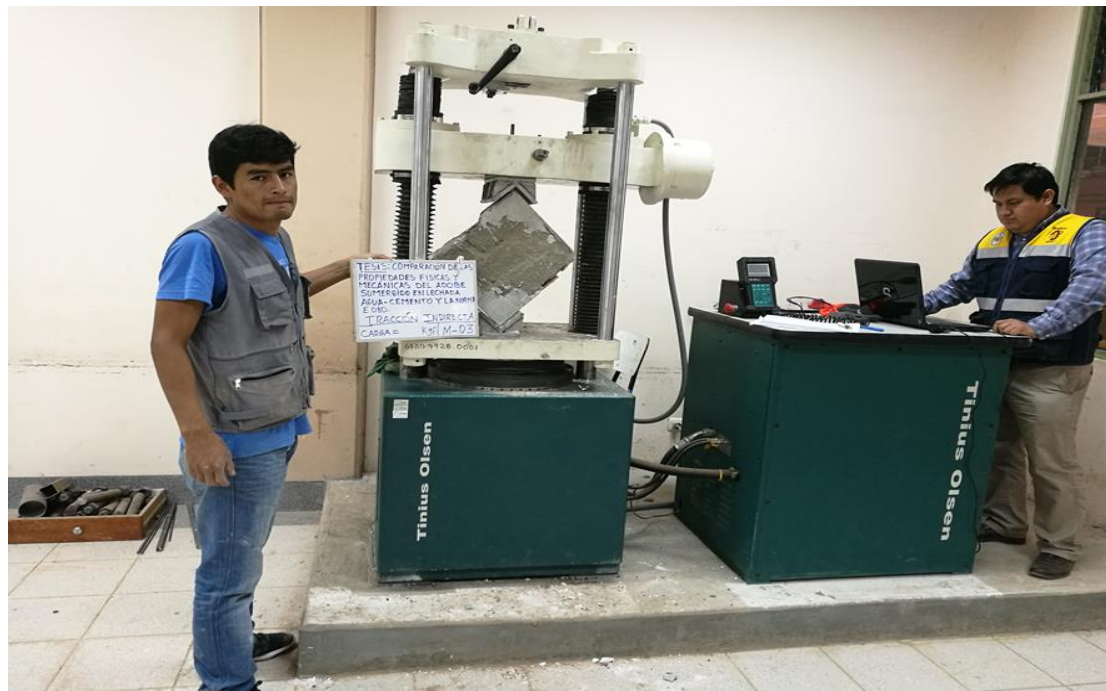
Fotografía N° 25. Tracción Indirecta de muretes de adobe sumergido en lechada a/c.
