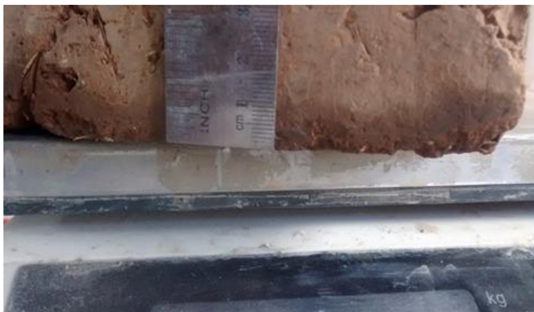
Fotografía N° 30. Ensayo de succión del adobe normal.
