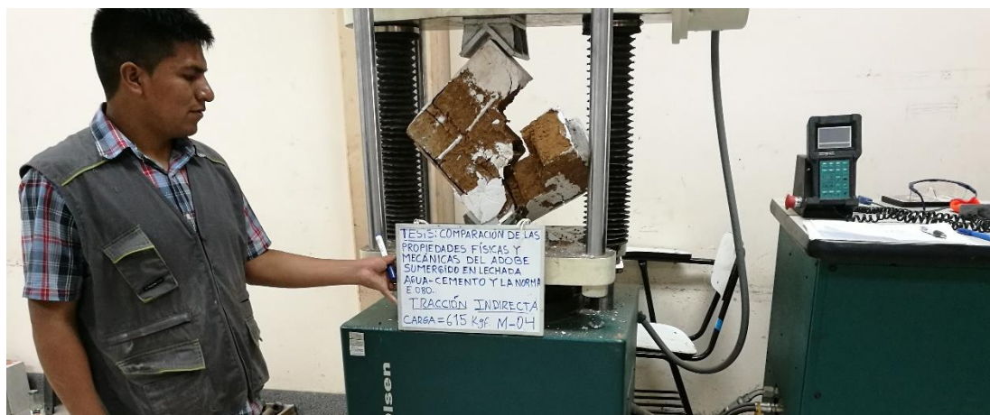
Fotografía N° 14. Ensayo a tracción indirecta de muretes con adobe sumergido en lechada.
