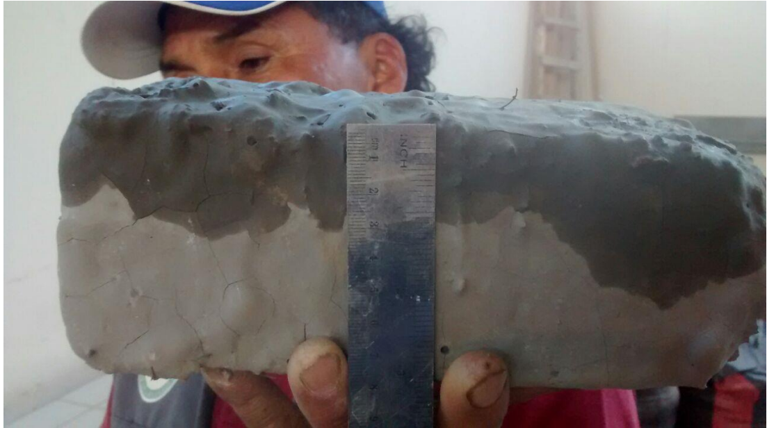
Fotografía N° 06. Ascenso capilar del agua en la muestra del adobe sumergido en lechada Agua- cemento.
