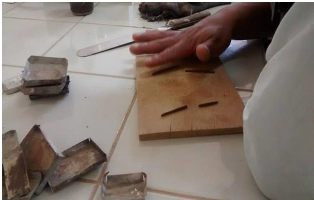
Fotografía N° 08. Muestra en proceso de cálculo del Limite Plástico.
