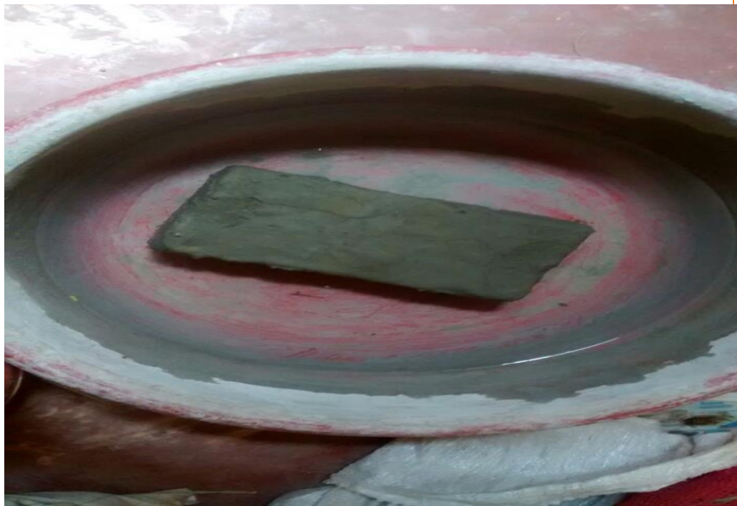
Fotografía N° 27. Ensayo de absorción de adobe sumergido en lechada a/c.
