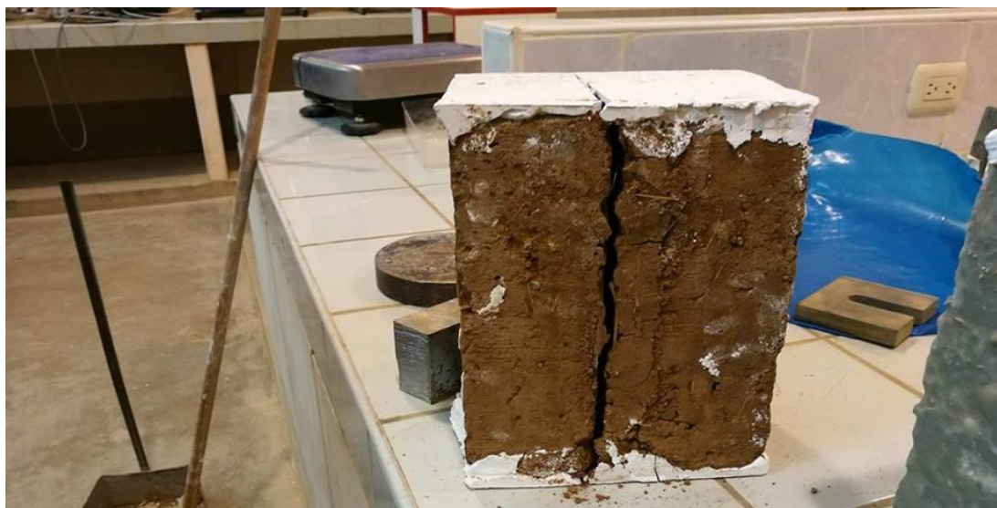
Fotografía N° 10. Falla del mortero en muestras de adobe normal.
