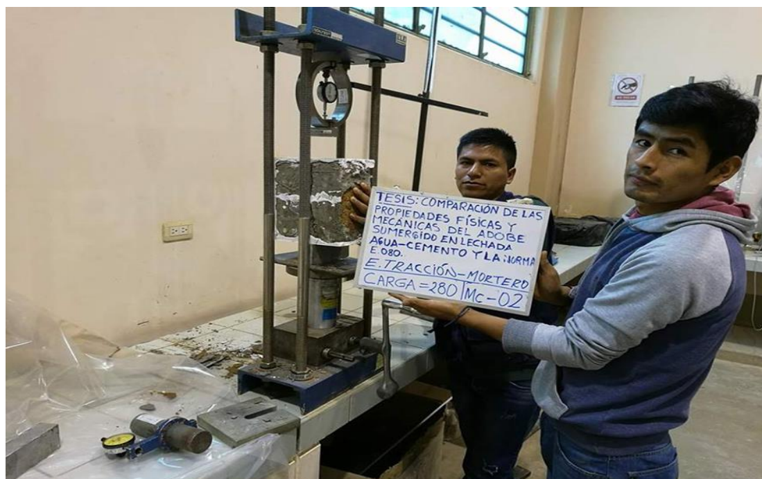
Fotografía N° 32. Ensayo de tracción indirecta de mortero con adobe sumergido a/c.
