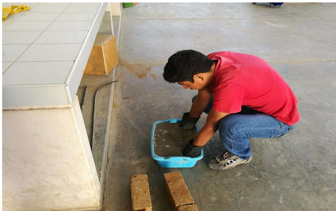
Fotografía N° 16. Sumergido de Adobe Normal en Lechada Agua/Cemento.
