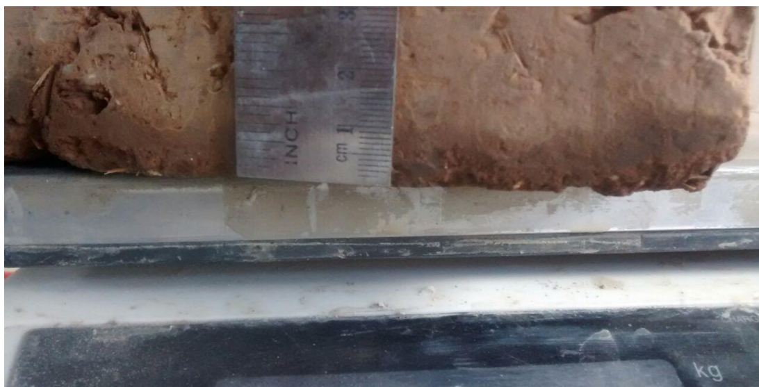
Fotografía N° 05. Ascenso capilar del agua en la muestra del adobe normal.
