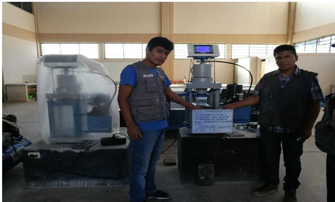
Fotografía N° 17. Ensayo a compresión de unidades de adobe sumergidas en A/C.
