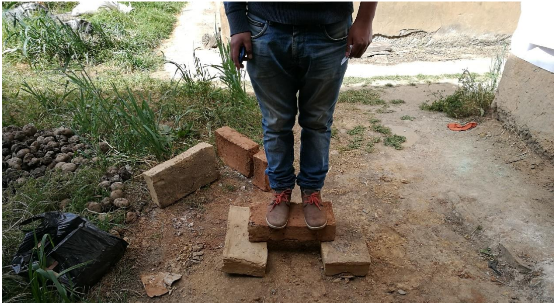
Fotografía N° 02. Adobe de prueba (prueba de resistencia).
