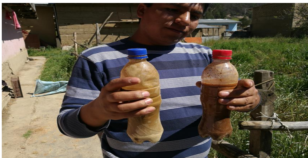
Fotografía N° 04. Prueba de la botella, de la cantera Tin Tin y cruz pata.
