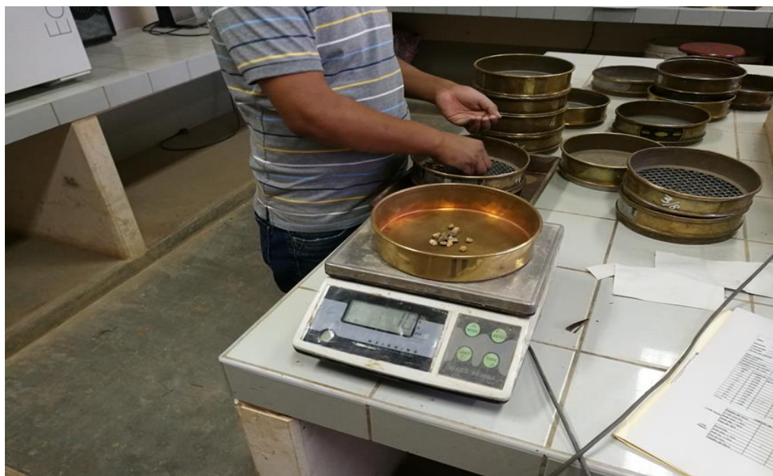
Fotografía N° 06. Muestra en proceso de tamizaje.
