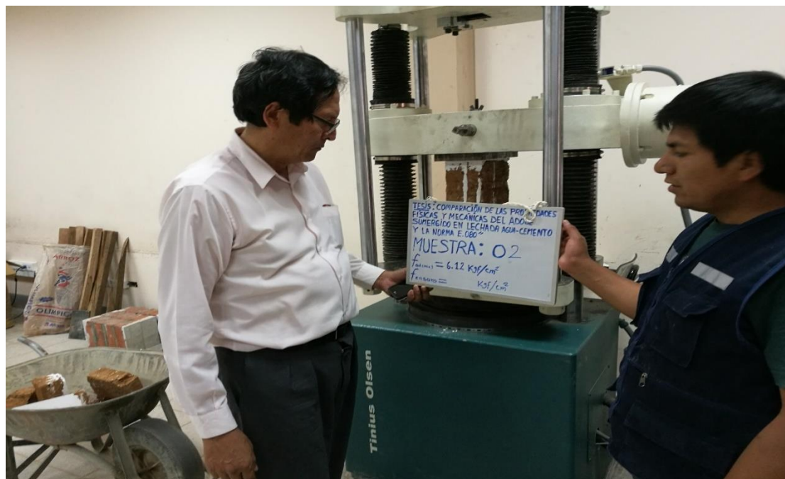
Fotografía N° 21. Ensayo a compresión de pilas de adobe normal.
