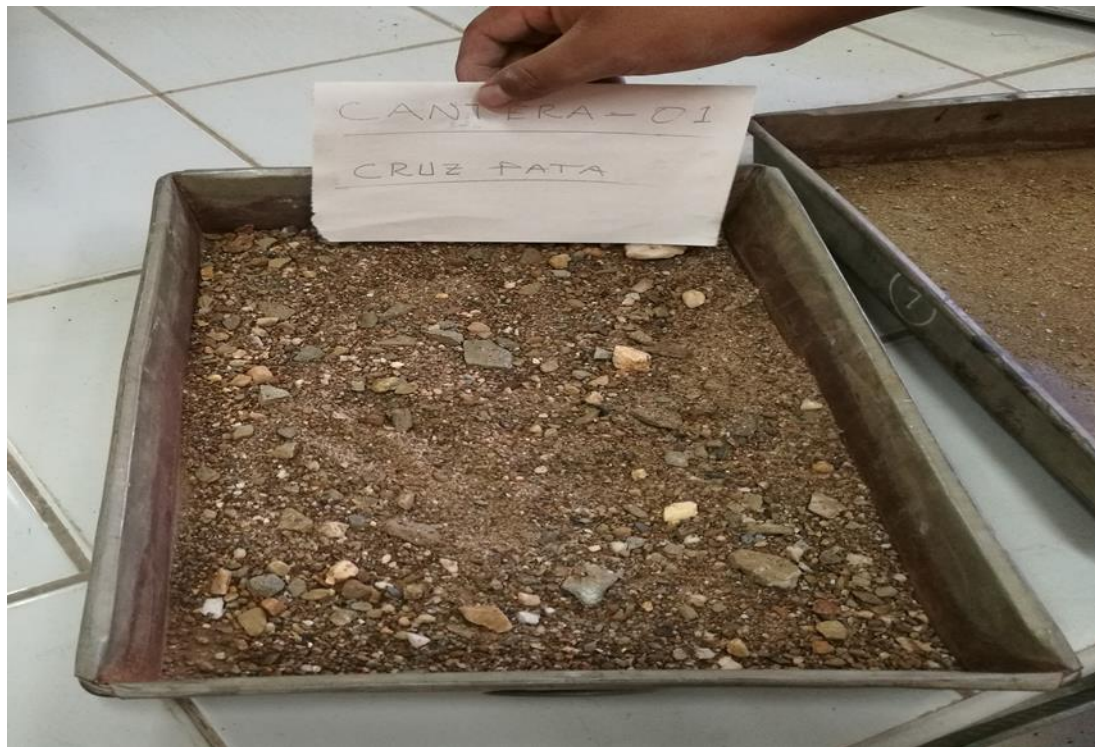
Fotografía N° 05. Muestra lavada listo para el análisis granulométrico.
