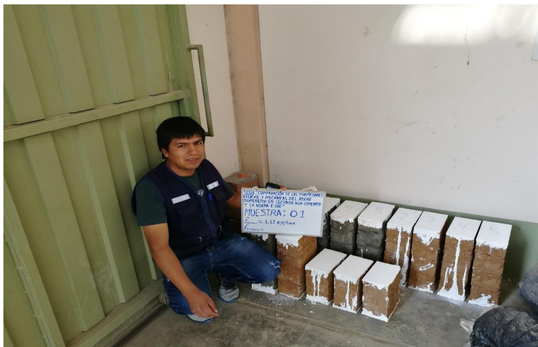
Fotografía N° 20. Pilas capeadas listas para ser ensayadas en la maquina universal.
