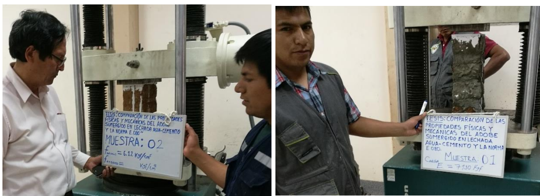
Fotografía N° 12. Ensayo a compresión de pilas, izquierda: adobe normal, Derecha: adobe sumergido en lechada.
