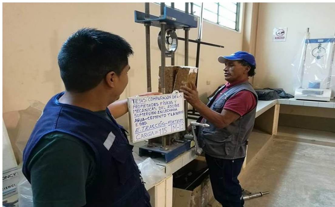
Fotografía N° 31. Ensayo de tracción indirecta de mortero con adobe normal
