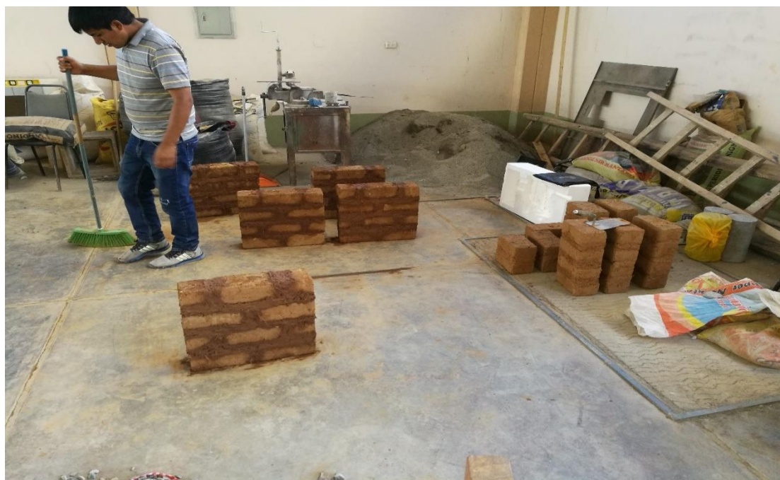
Fotografía N° 14. Asentado de Muretes de Adobe Normal (Laboratorio de Suelos).
