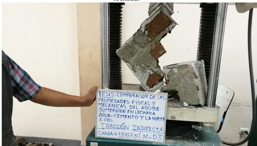
Fotografía N° 14. Ensayo a tracción indirecta de muretes con adobe sumergido en lechada.
