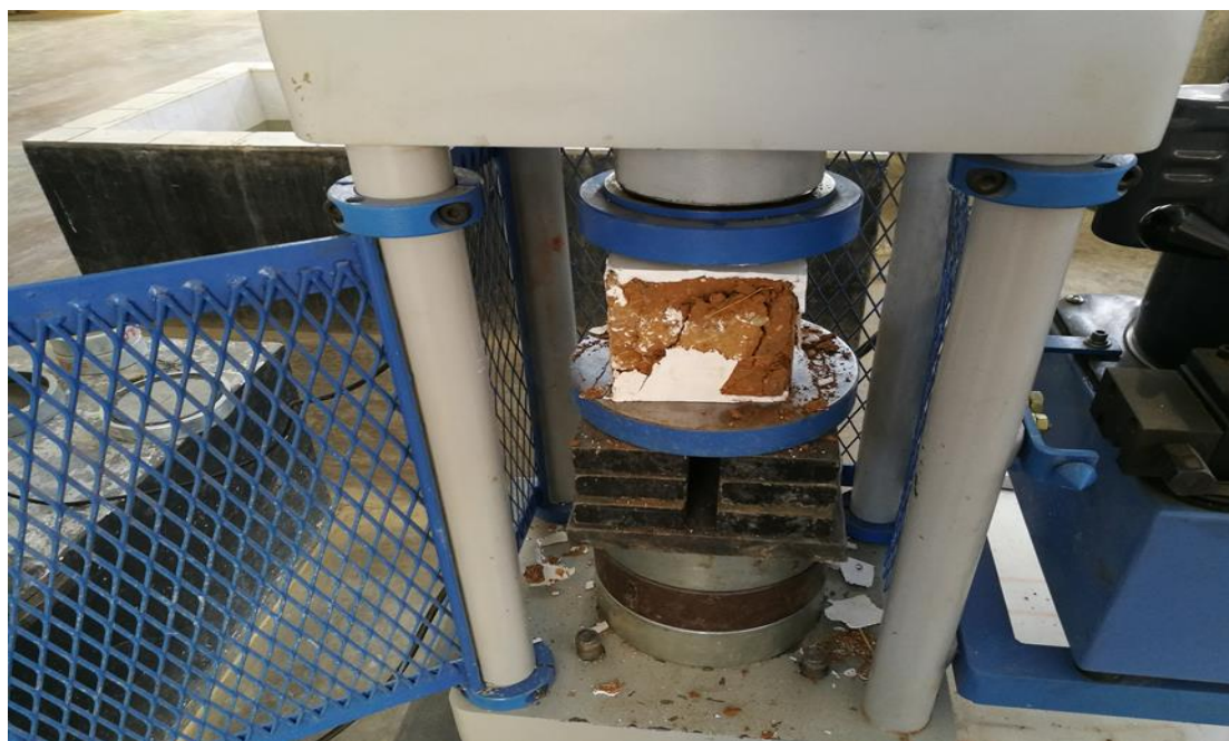
Fotografía N° 18. Ensayo a compresión de unidades de Adobe Normal (10*10*10cm).
