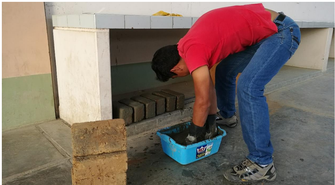
Fotografía N° 04. Sumersión del adobe en la lechada Agua - Cemento.
