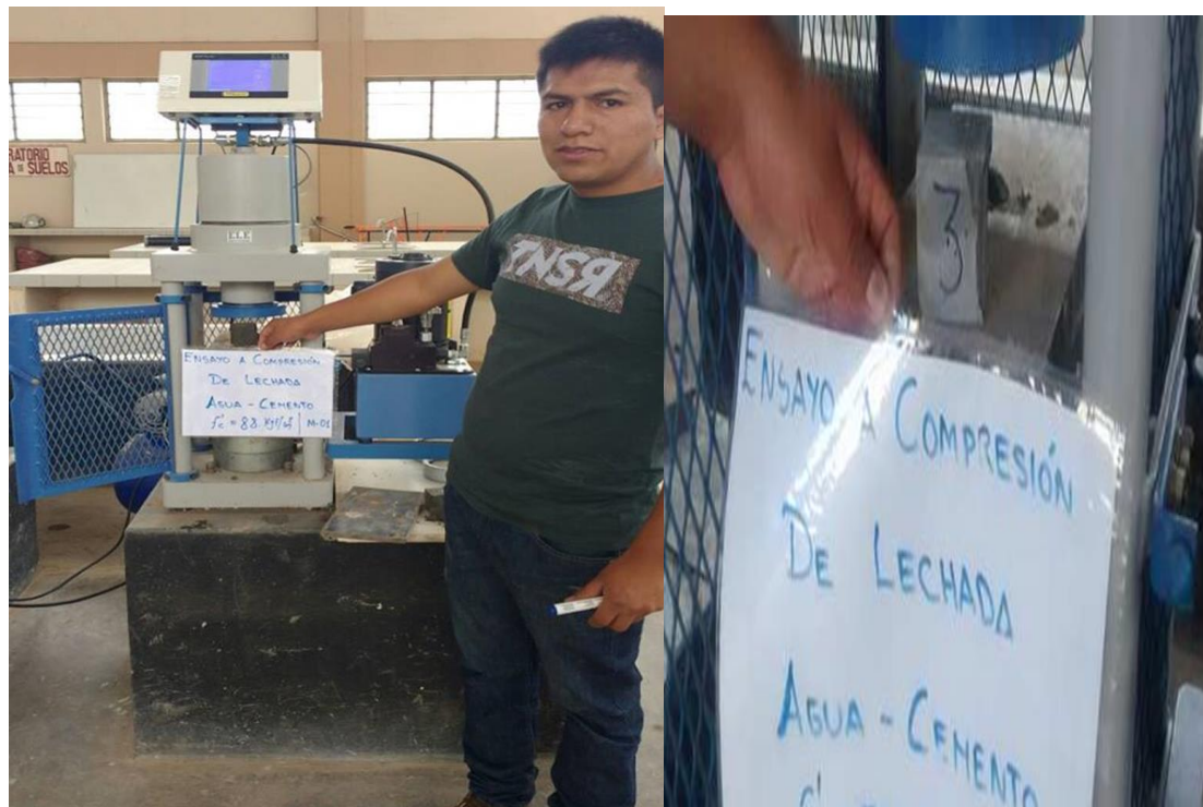
Fotografía N° 33. Ensayo de resistencia a compresión de la lechada a/c=0.85 .
