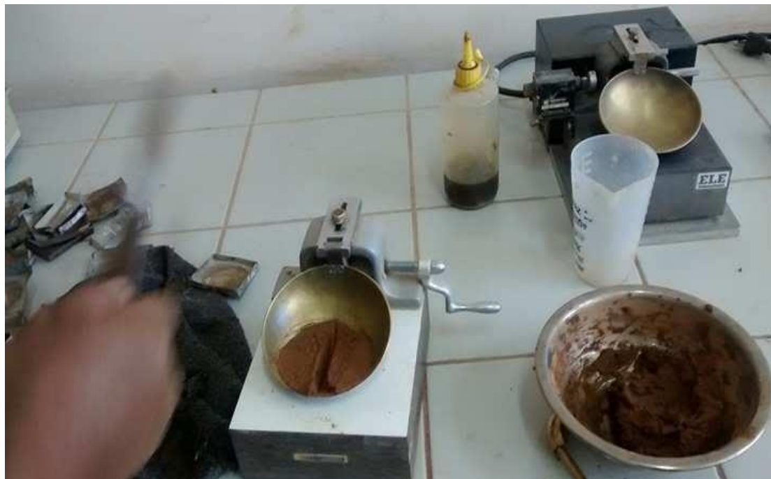
Fotografía N° 07. Muestra en proceso de cálculo del Limite Liquido.
