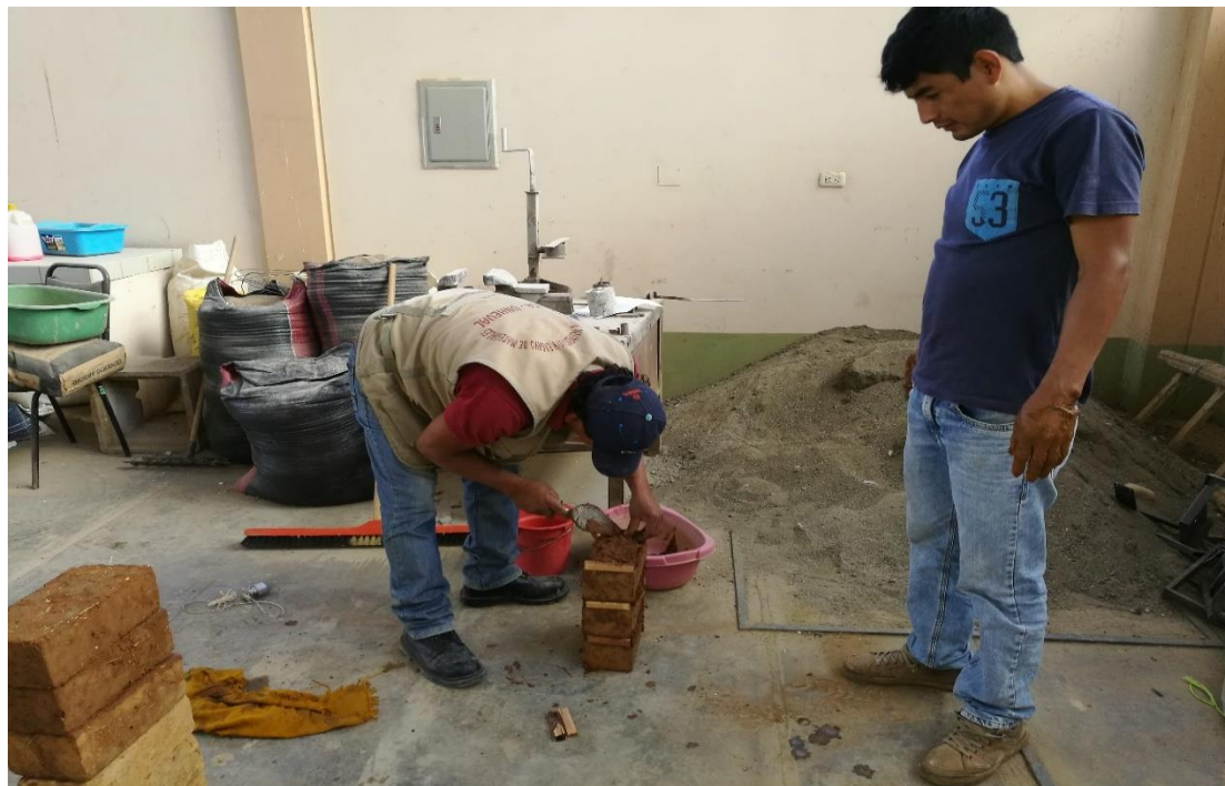
Fotografía N° 13. Asentado de Pilas de Adobe Normal (Laboratorio de Suelos-FICA).
