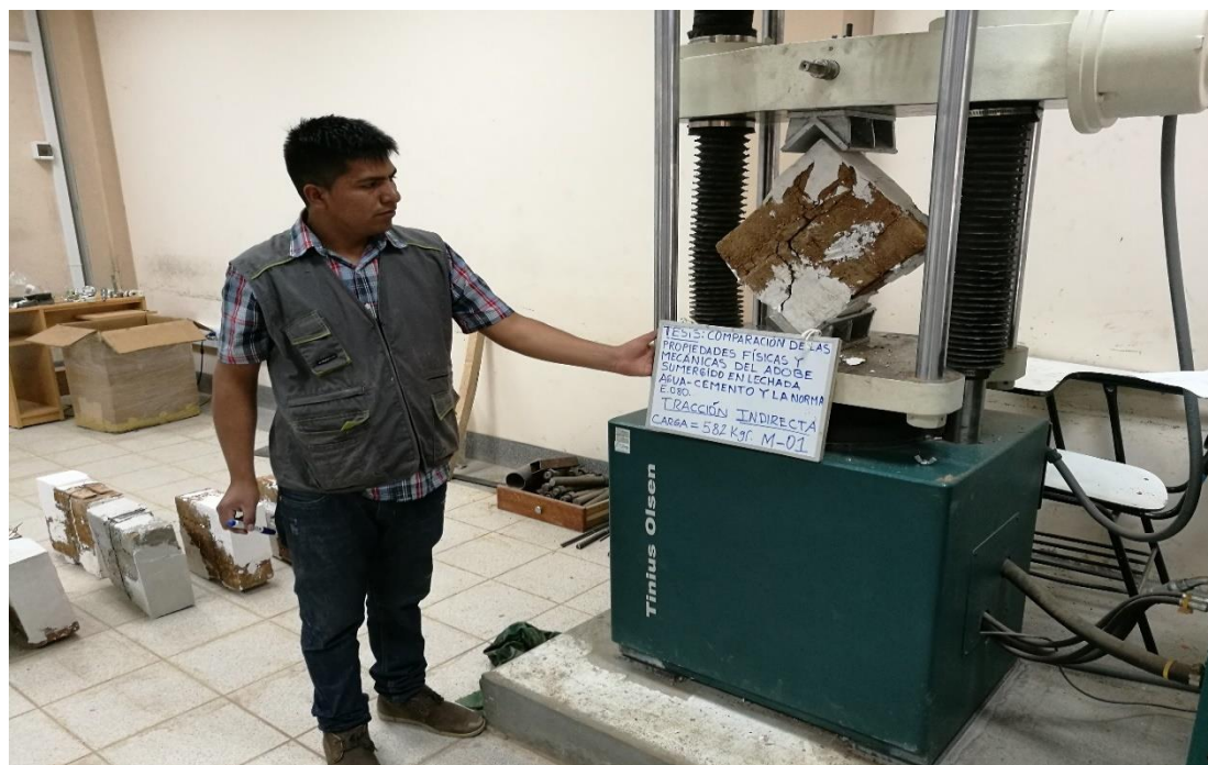
Fotografía N° 24. Tracción Indirecta de muretes de adobe normal.
