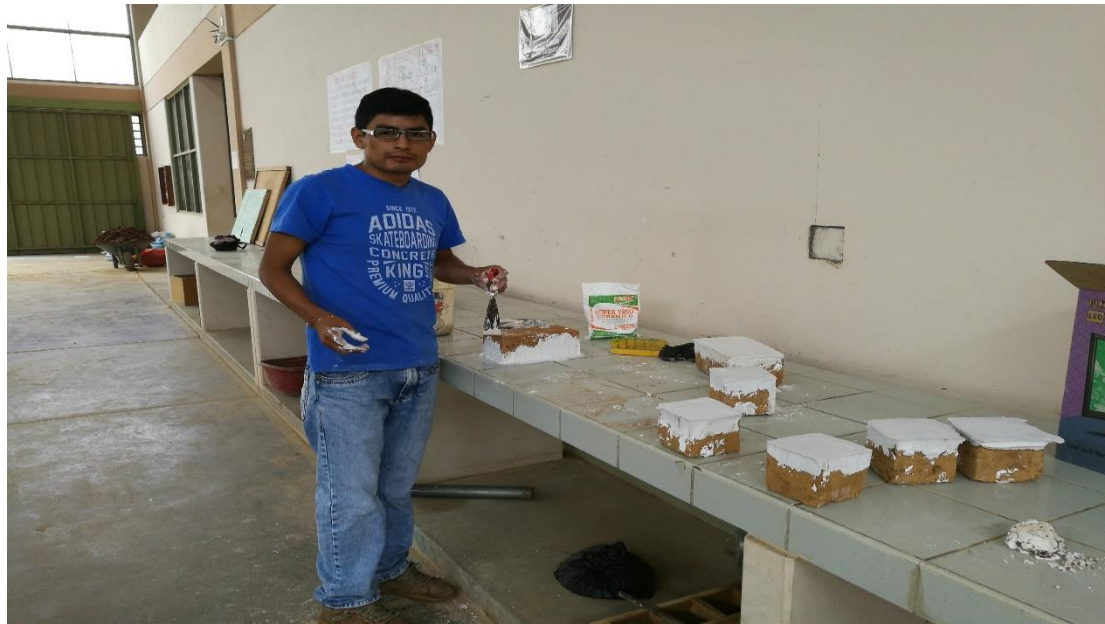
Fotografía N° 15. Capeo de Unidades de Adobe Normal para ensayo a Compresión.
