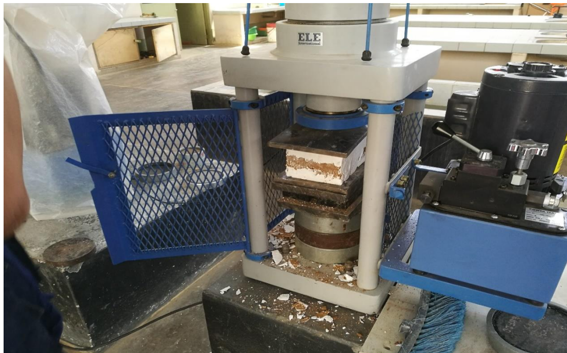
Fotografía N° 19. Ensayo a compresión de unidades de adobe Normal (22x12x8.5cm)
