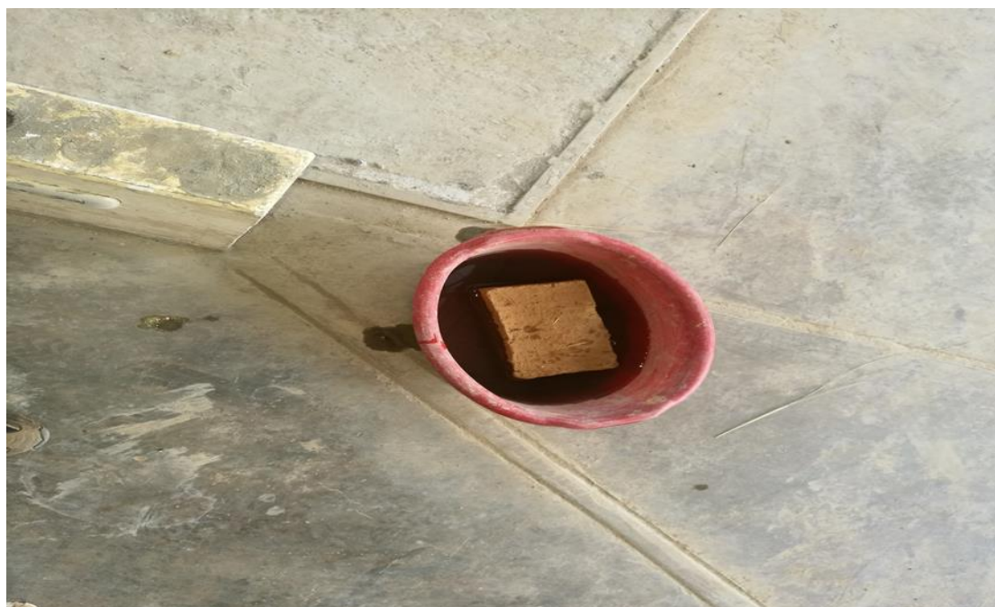
Fotografía N° 28. Ensayo de absorción de adobe adobe normal.
