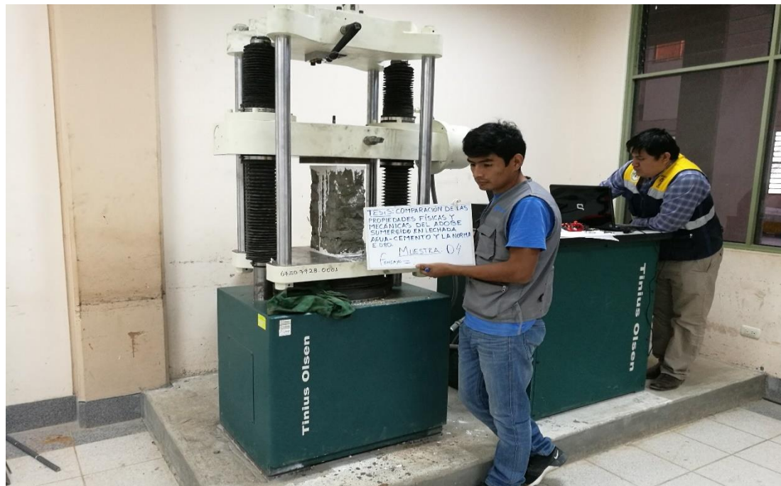
Fotografía N° 23. Ensayo a compresión de pilas de adobe sumergido en A/C.
