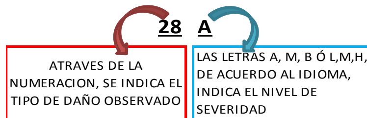
GRÁFICO 20: Descripción Tipo de Daño y su nivel de severidad
