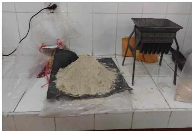
Imagen 16: Cuarteador Estático Jones para homogenizador de muestras de sílice Fuente: Laboratorio UNDAC
