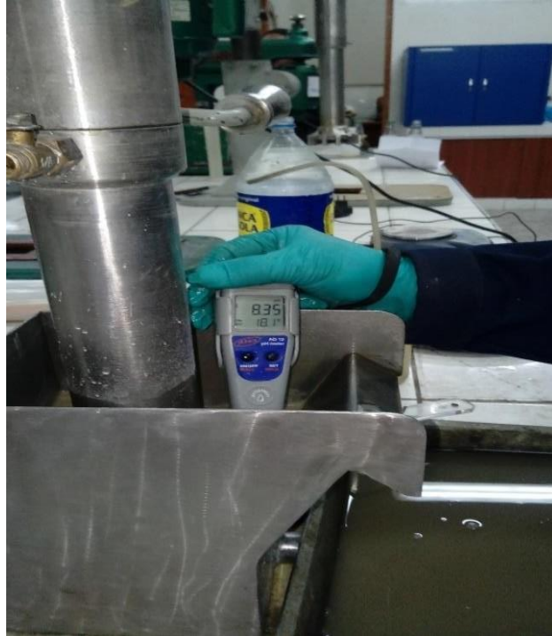
Imagen 22: Control del pH de la primera flotación FUENTE: Autoría propia
