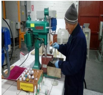
Equipo de flotación DENVER
