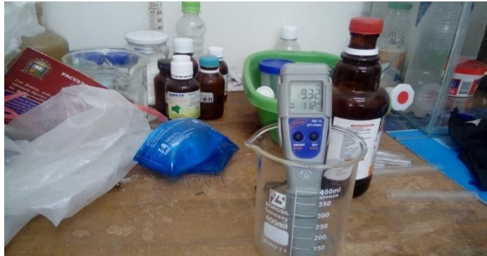
Imagen 18 :Potenciómetro Adwa AD 12
