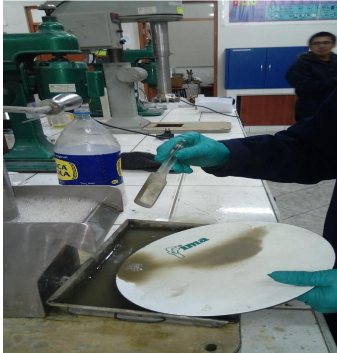
Imagen 27: Flotación de primera limpieza del ensayo 1 FUENTE: Autoría propia
