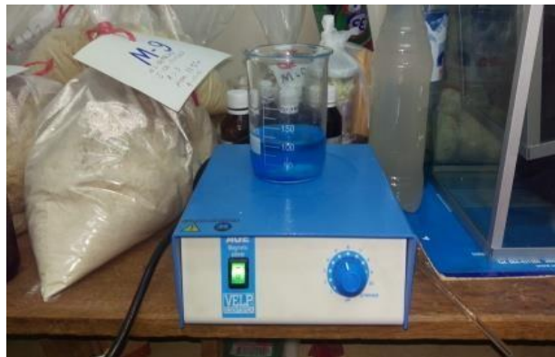
Imagen 15: Agitador Magnético para disolución de los reactivos Fuente: Laboratorio UNDAC
